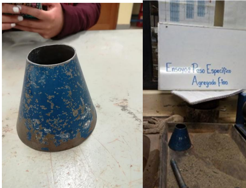
Figura 54: Prueba de humedad luego de usar el cono metálico.
