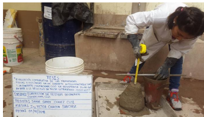
Figura 79: Revenimiento del concreto simple f'c = 210 \text{ kg/cm}^2
