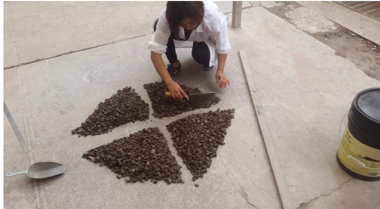
Figura 46: División de la muestra de agregado grueso en 4 partes iguales
