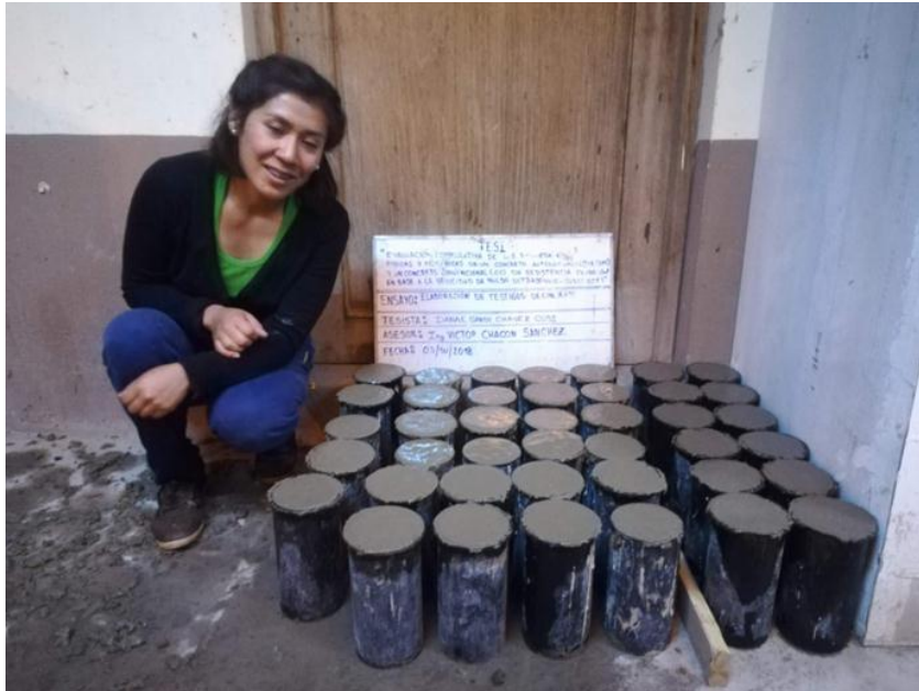
Figura 83: Moldeado de probetas cilíndricas de concreto autocompactable
