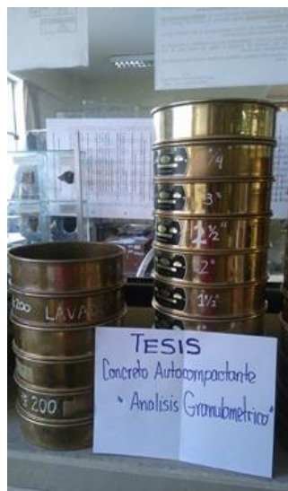
Figura 51: Material retenido luego del tamizado
