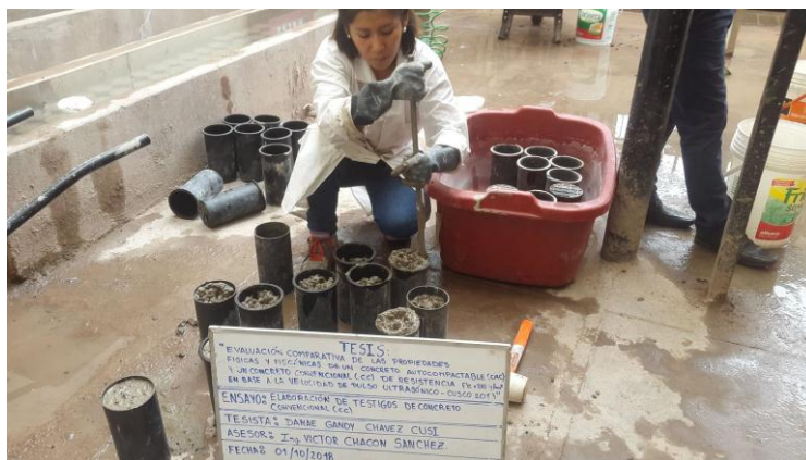
Figura 82: Llenado de la última capa de concreto en la probeta de PVC
