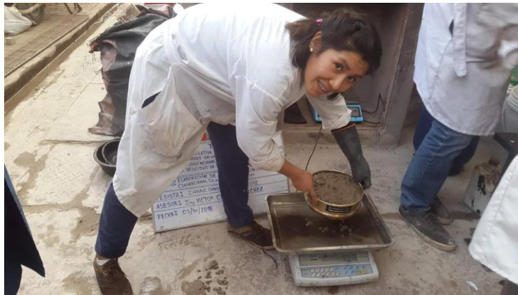
Figura 70: Fluidez del concreto al fondo de TAM
