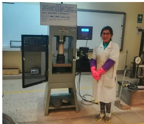
Figura 94: Probeta de concreto a ser ensayada en la máquina de compresión axial
