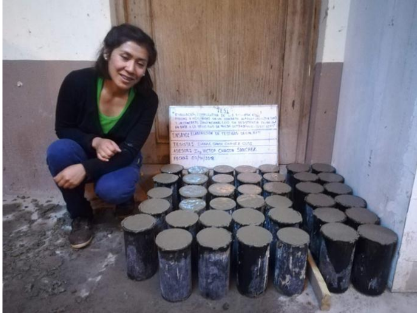
Figura 86: Finalización del moldeado de probeta
