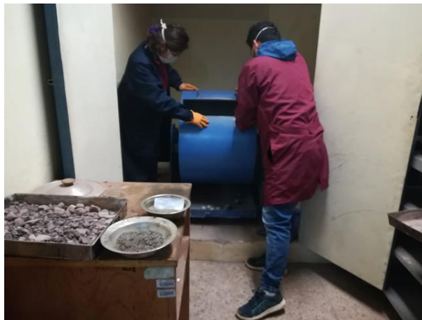
Figura 60: Colocado las esferas correspondientes dentro de la máquina de abrasión Los Ángeles
