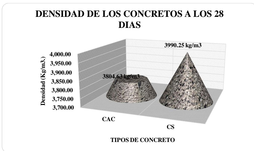
Figura 127: Grafico de densidad del concreto simple (CS) y concreto autocompactable (CAC)
