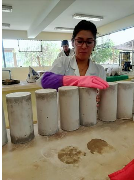
Figura 96: Lijado y nivelado de la superficie rugosa
