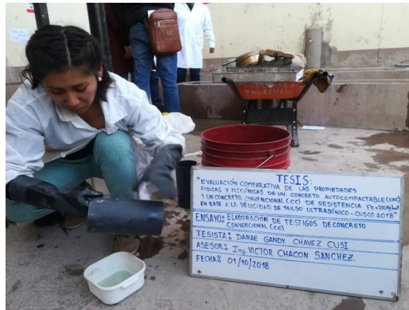
Figura 80: Moldeado de probetas cilíndricas de concreto simple
