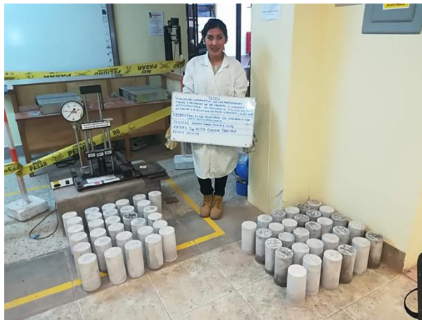
Figura 89: Marcado de probetas de CS y CAC
