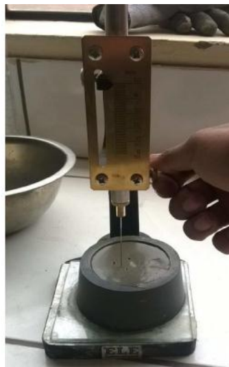
Figura 73: Ensayo de aguja vicat
