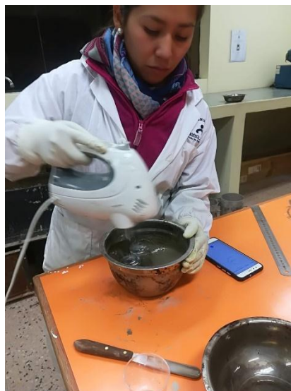
Figura 61: Mezclado de pasta con batidora
