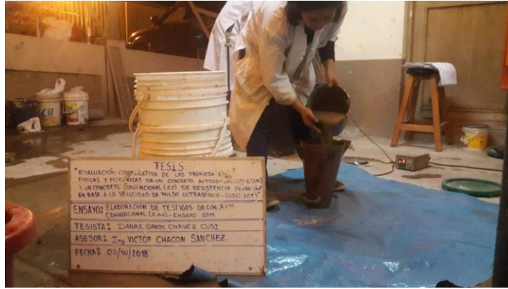
Figura 62: Llenado del cono de Abrams con CAC
