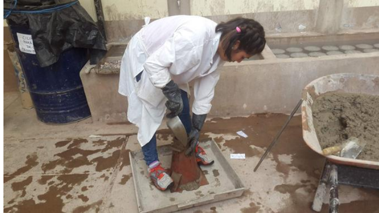
Figura 78: Llenado del cono dentro de una bandeja metálica
