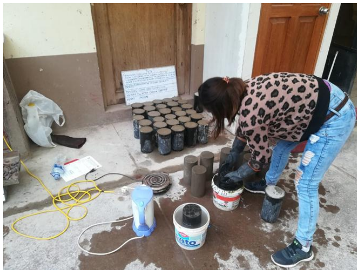
Figura 87: Desmoldado de testigos
