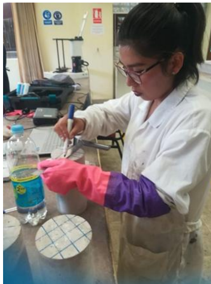
Figura 97: Marcado de probetas con plumón
