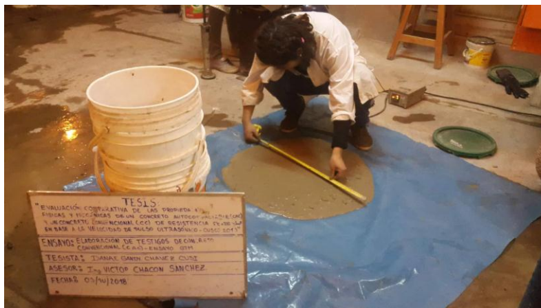
Figura 63: Medida del asentamiento y flujo del concreto
