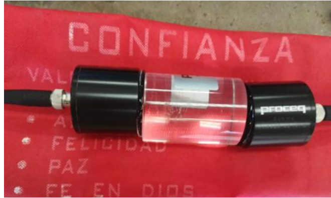
Figura 98: Puesta a cero con la barra calibradora
