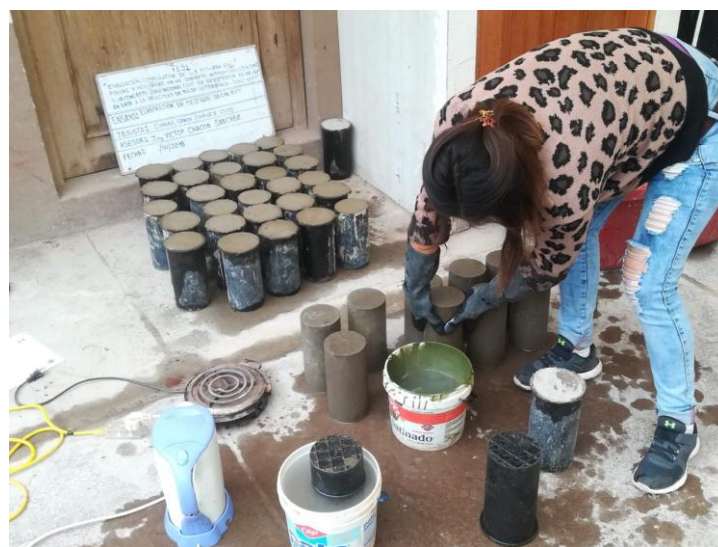
Figura 84: Culminación del moldeado de una tanda de concreto
