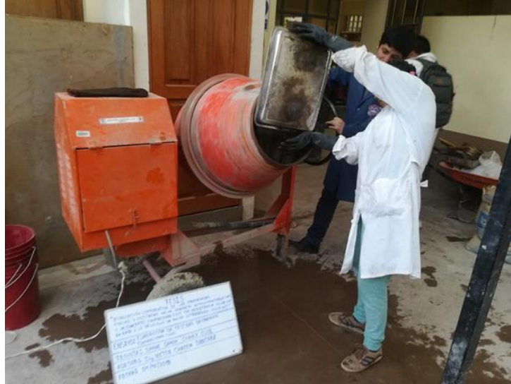
Figura 77: Introducción de agregados pesados a la mezcladora
