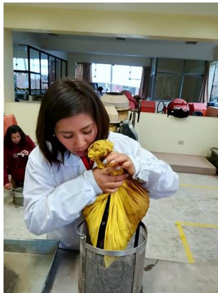
Figura 58: Pesado de la muestra en estado superficialmente seco
