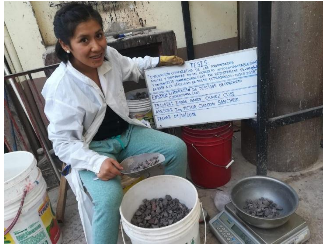
Figura 74: Pesado de todos los materiales a ser utilizados
