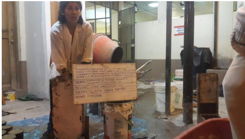
Figura 66: Llenado de la caja en u con concreto autocompactable
