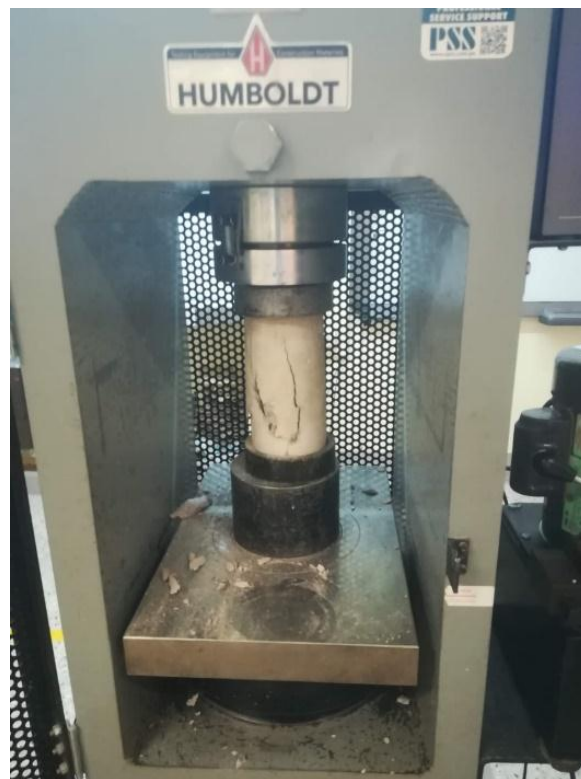
Figura 92: Rotura de probeta cilíndrica de concreto
