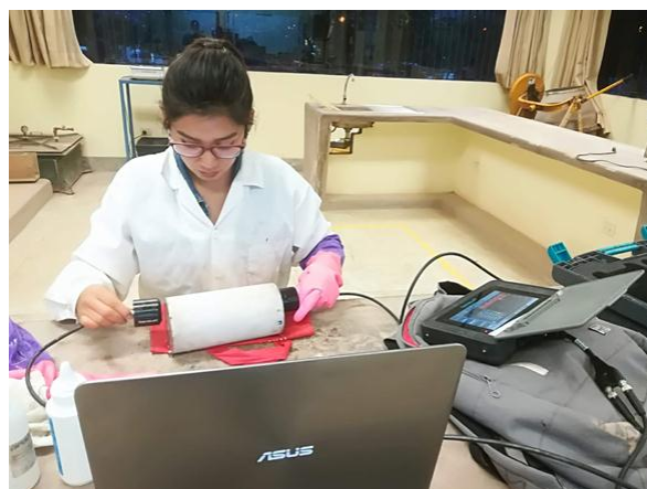
Figura 100: Aplicación de los transductores a la briqueta
