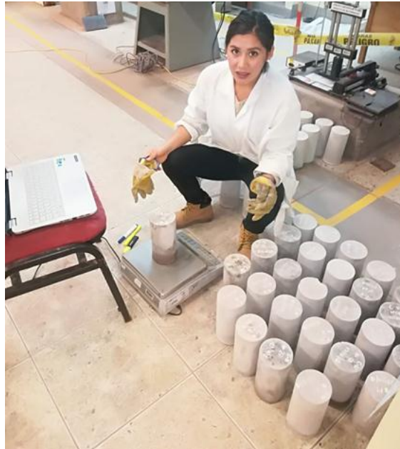
Figura 90: Pesado de las muestras cilíndricas
