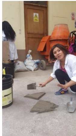
Figura 43: Partes diagonalmente opuestas de semejantes características del agregado fino
