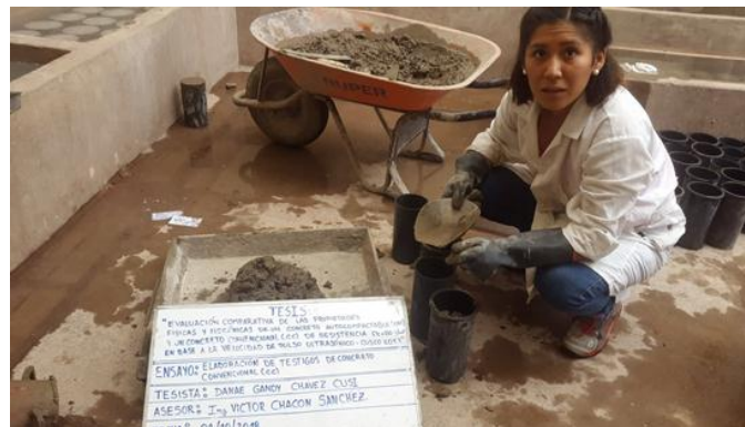
Figura 81: Compactado del concreto con 25 golpes
