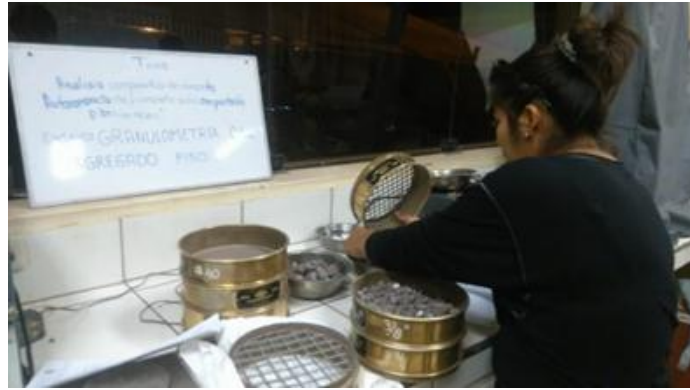
Figura 53: Material retenido luego del tamizado
