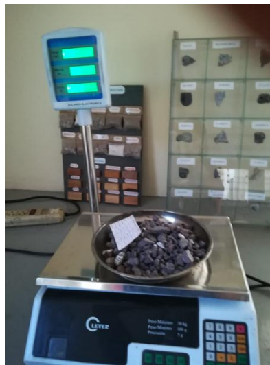
Figura 58: Pesado de la muestra en estado superficialmente seco
