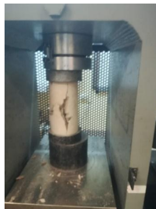
Figura 95: Rotura de probeta cilíndrica de concreto
