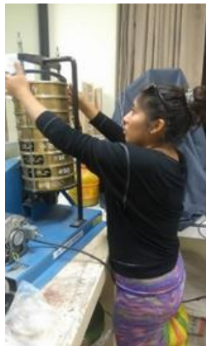
Figura 48: Peso del agregado fino antes del tamizado
