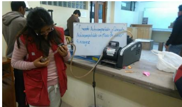
Figura 56: Extracción de vacíos de la fiola de vidrio
