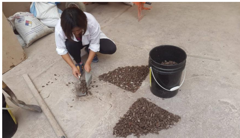
Figura 47: Partes diagonalmente opuestas de semejantes características del agregado grueso
