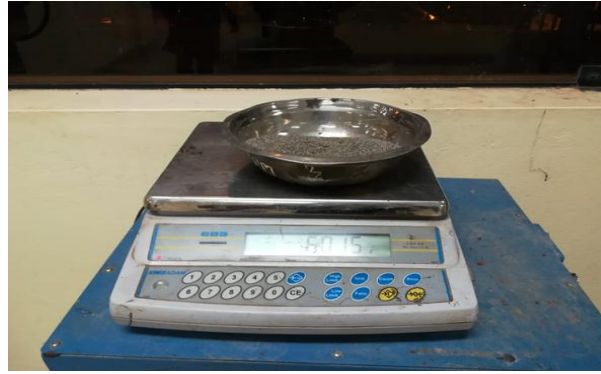
Figura 55: Pesado del material antes de colocarlo en la fiola de vidrio
