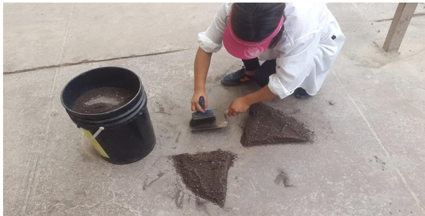
Figura 44: Muestreo del agregado fino por el método de cuarteo.
