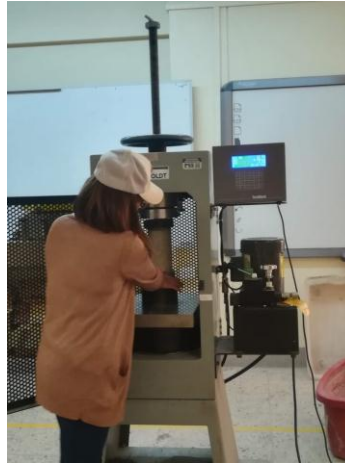
Figura 93: Colocado de las probetas cilíndricas en la máquina de compresión
