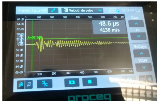
Figura 24: Resultado de tiempo de transmisión y velocidad de pulso en PL-200
