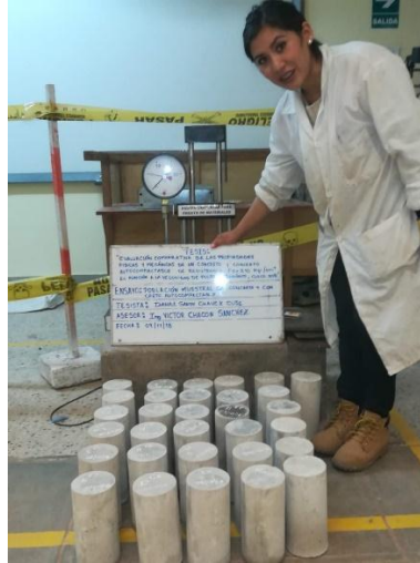
Figura 40: Muestras de briquetas de concreto simple
