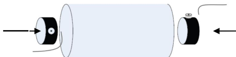
Figura 23: Técnica de medición directa sobre la probeta cilíndrica de concreto.
