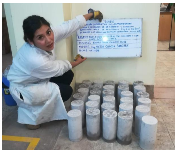
Figura 41: Briquetas sometidas a ensayos de velocidad de pulso ultrasónico
