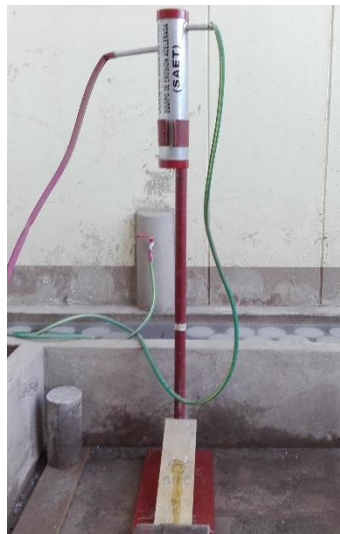
Figura 113. Calibración de la Máquina de Erosion Acelerada de Swinburne
