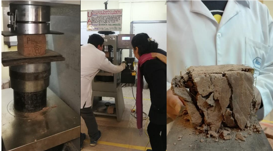
Figura 110. Ensayo de Resistencia a la Compresión a los Cubos de Adobes Tradicionales y Estabilizados
