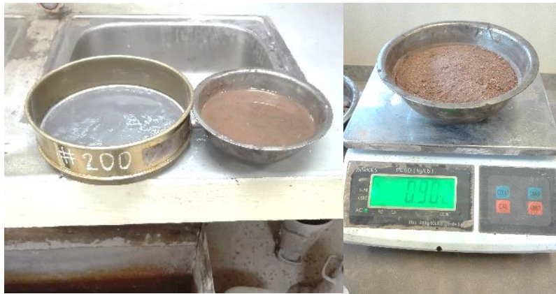
Figura 81. Lavado de Material por el Tamiz N° 200
