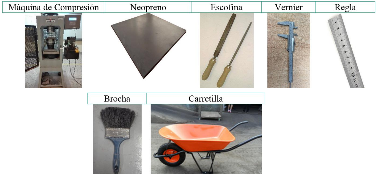
Figura 106. Materiales Utilizados en el Ensayo de Resistencia a la Compresión
