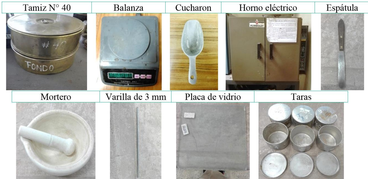
Figura 76. Materiales Usados en el Ensayo de Límite Plástico
