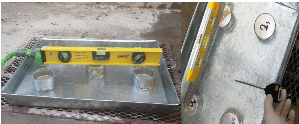
Figura 102. Nivelación de la Bandeja para el Ensayo de Succión de Agua
