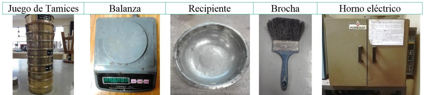
Figura 80. Materiales Usados en el Ensayo de Análisis Granulométrico
