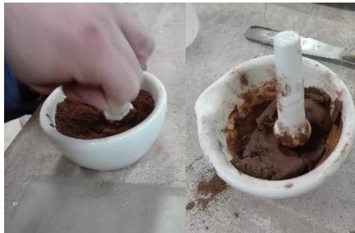
Figura 77. Suelo Humedecido para el Ensayo de Límite Plástico
