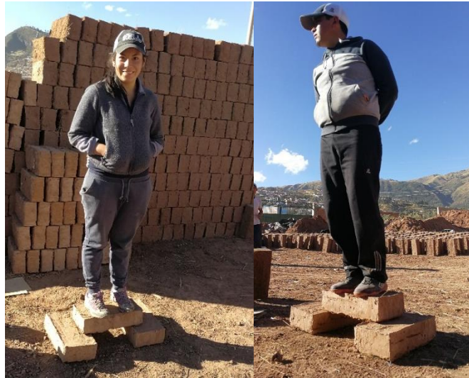
Figura 91. Prueba de Flexión y Resistencia de Adobes Tradicionales y Estabilizados
