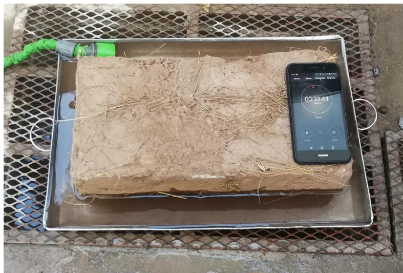
Figura 104. Ensayo de Succión de Agua a los Adobes Tradicionales y Estabilizados
