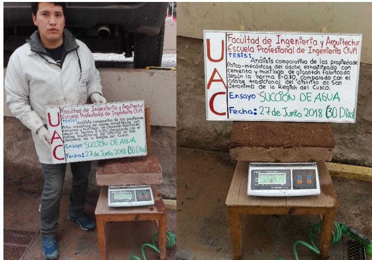
Figura 105. Pesado de los Adobes Tradicionales y Estabilizados ya Ensayados
