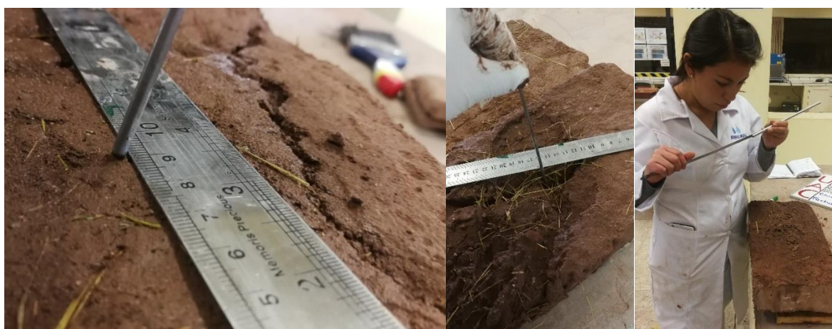
Figura 115. Medida de la Oquedad Generada por el Goteo
