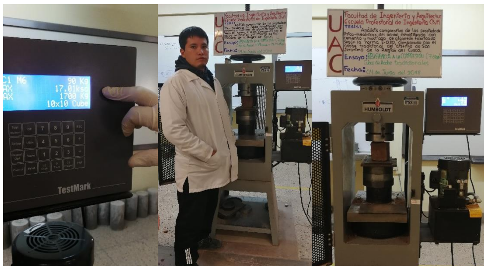
Figura 109. Calibrado de la Máquina de Compresión
