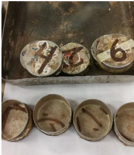
Figura 79. Muestras del Ensayo de Límite Plástico
