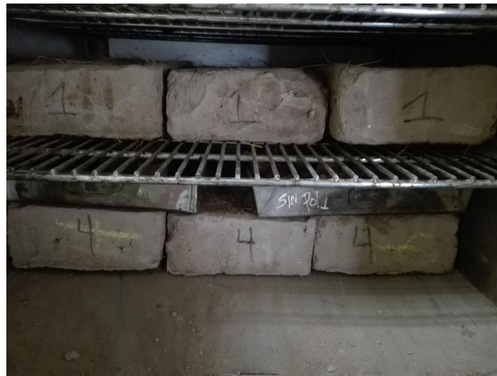
Figura 96. Adobes Tradicionales y Estabilizados en el Horno Eléctrico
