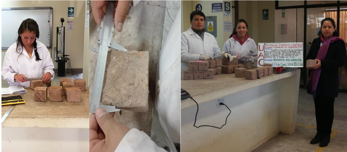
Figura 108. Perfilado y Medida de los Cubos de Adobe
