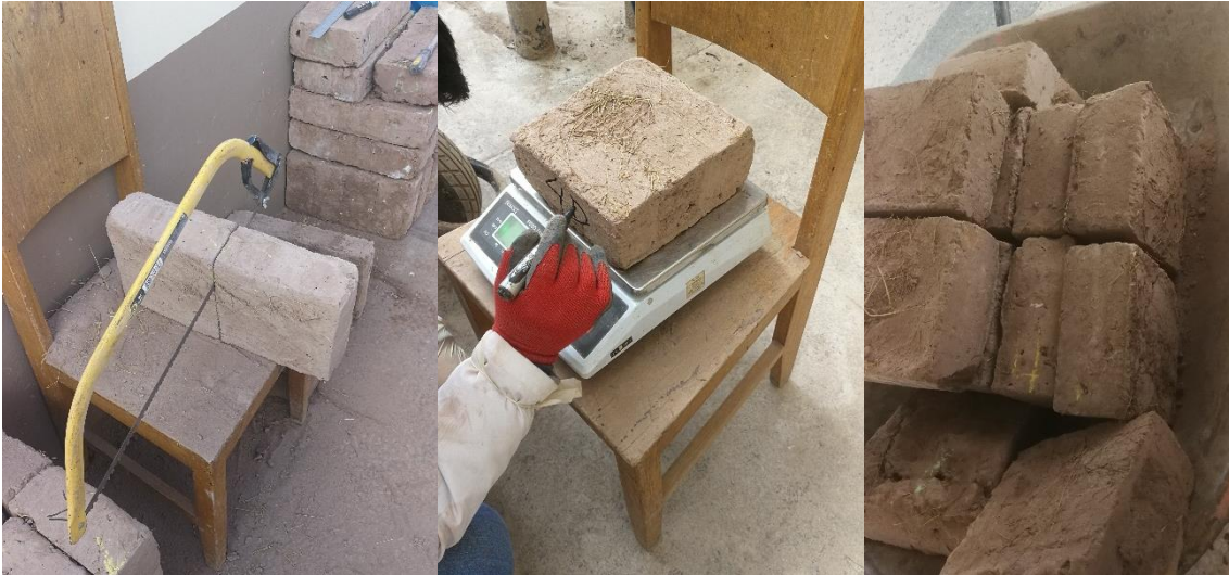
Figura 97. Corte de Adobes Tradicionales y Estabilizados a la Mitad
