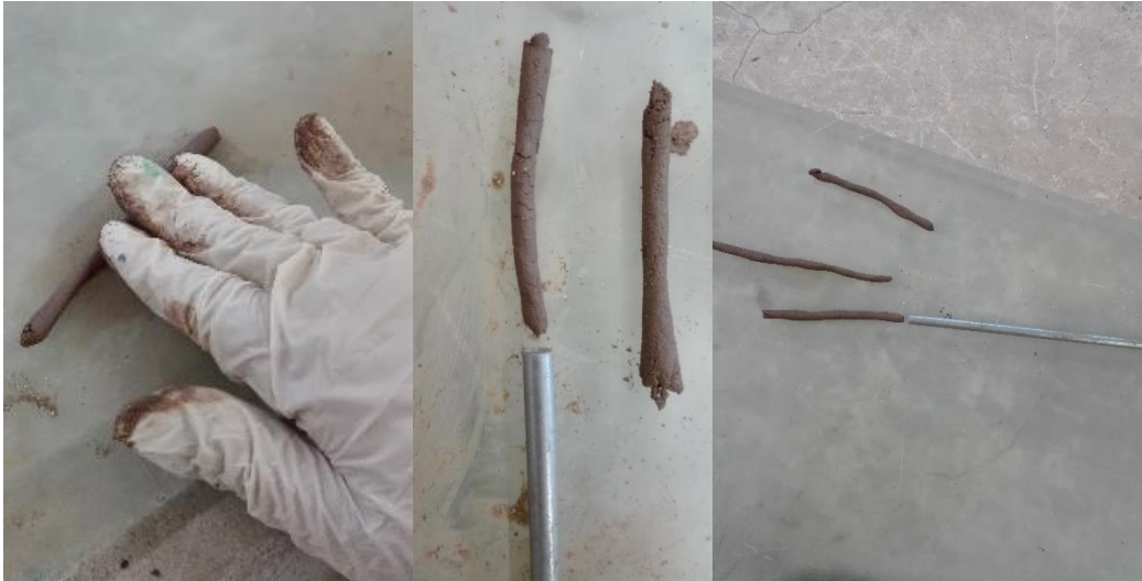
Figura 78. Cilindros Realizados para el Ensayo de Límite Plástico
