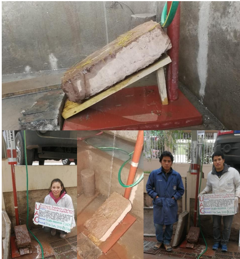
Figura 114. Ensayo de Erosion Acelerada de Swinburne a los Adobes Tradicionales y Estabilizados
