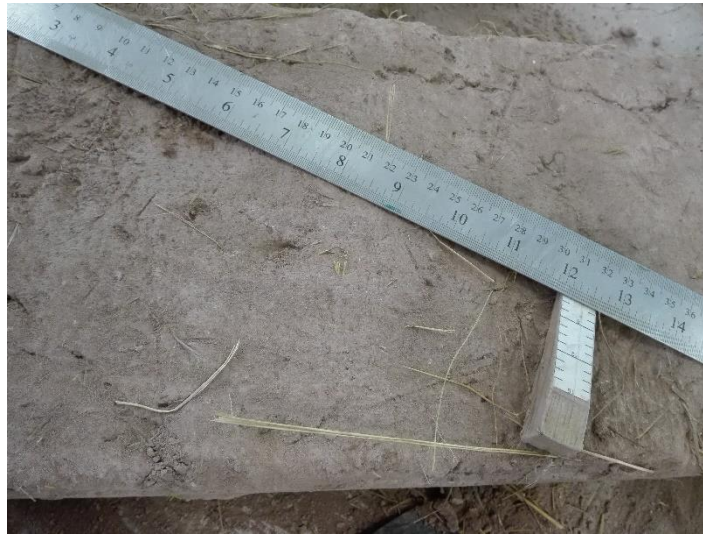
Figura 94. Ensayo de Alabeo
