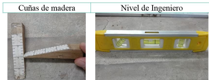
Figura 93. Materiales Usados en el Ensayo de Alabeo
