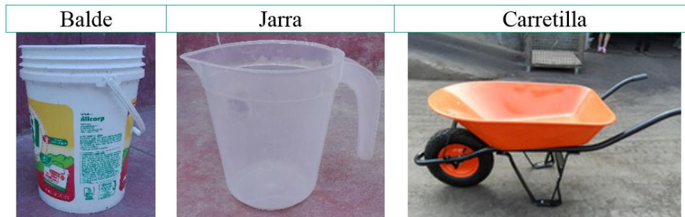
Figura 84. Materiales Utilizados para la Preparación de Testigos – Unidades de Adobes
