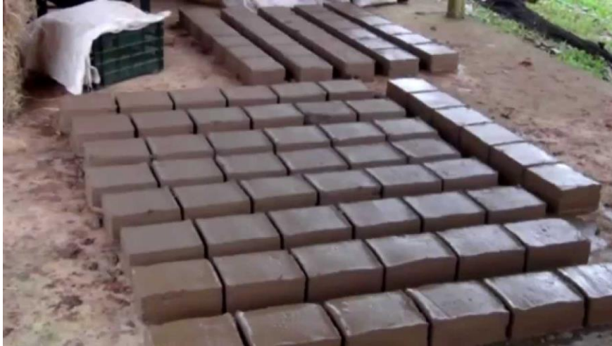
Figura 29. Almacenamiento del Adobe
