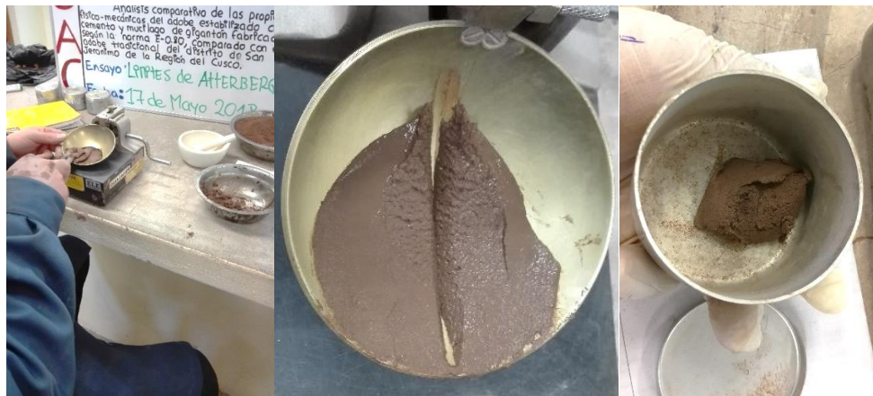
Figura 75. Muestra del Ensayo de Limite Liquido
