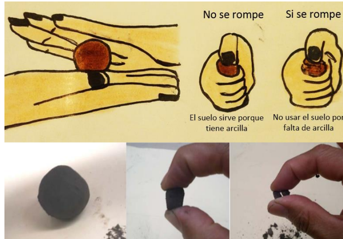
Figura 24. Prueba de la Resistencia Seca de la Bola
