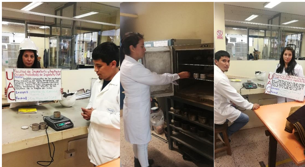
Figura 72. Ensayo de Contenido de Humedad
