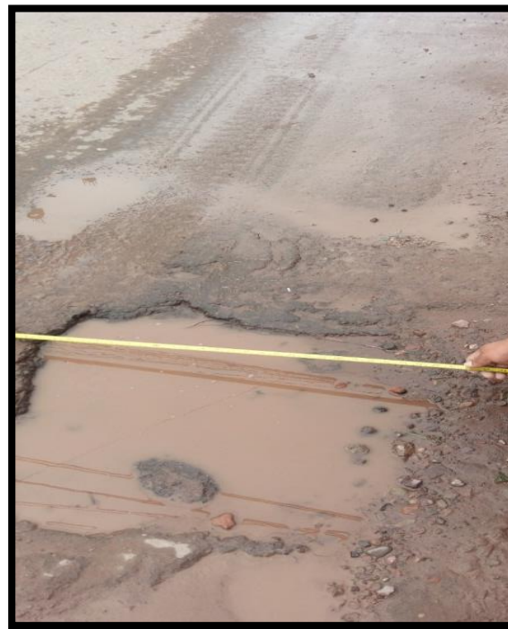
Figura 84: Medición de Área de Falla tipo Huevo Fuente: Elaboración Propia
