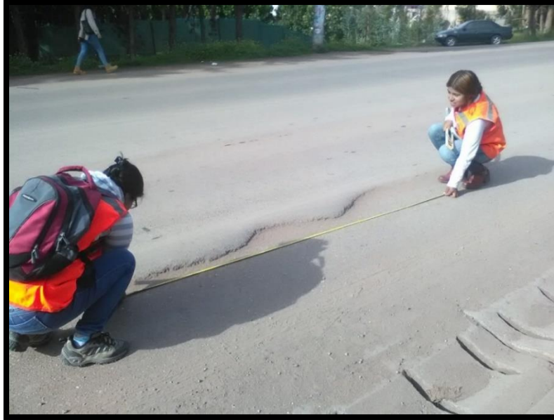
Figura 77: Medición de la Longitud de la Falla Fuente: Elaboración propia
