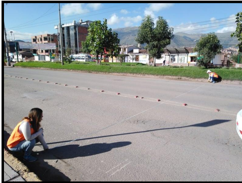
Figura 76: Medición del ancho de calzada
