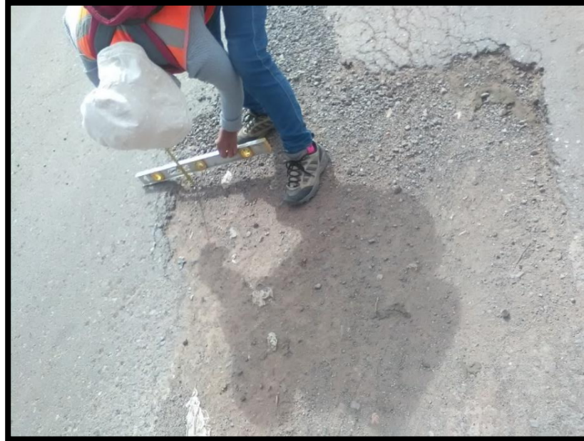
Figura 79: Medición de la Profundidad de la Falla Fuente: Elaboración propia
