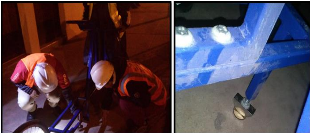
Figura 91: Colocación de la pastilla de calibración para toma de lecturas ( L_i ) y ( L_f )
