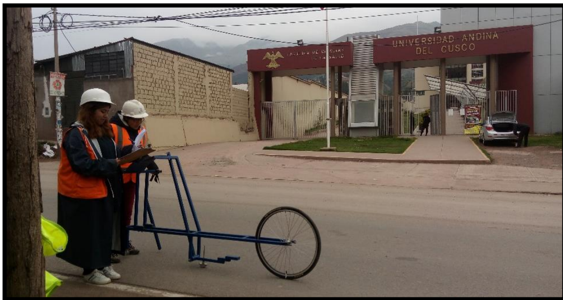
Figura 94: Punto Final del ensayo con el Uso del Rugosímetro de Merlín
