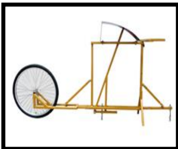
Figura 68: Rugosímetro de Merlín
