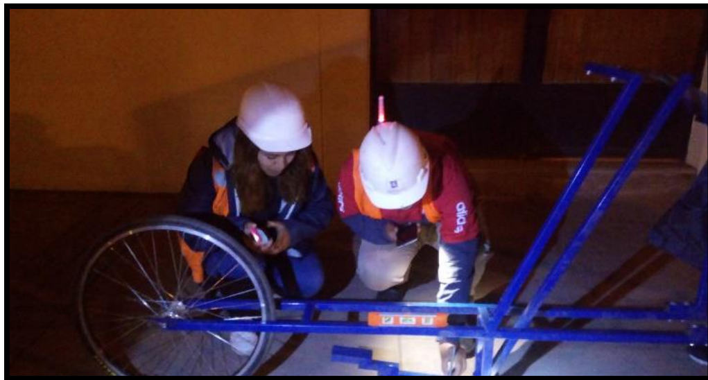
Figura 89: Nivelación del Rugosímetro de Merlín para la calibración del equipo
