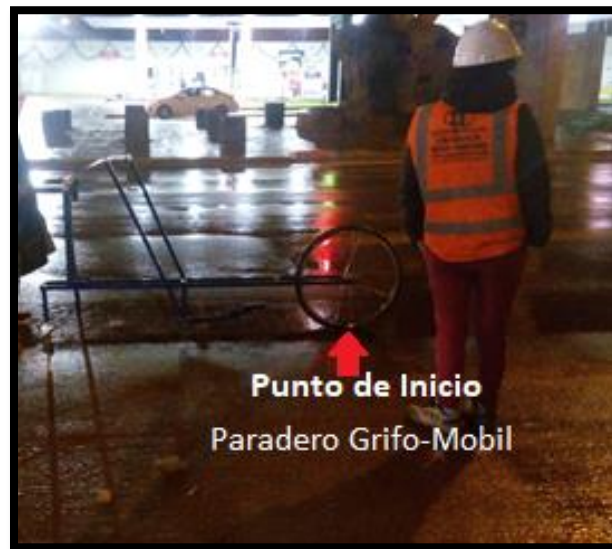
Figura 90: Punto de Inicio del ensayo con el Uso del Rugosímetro de Merlín
