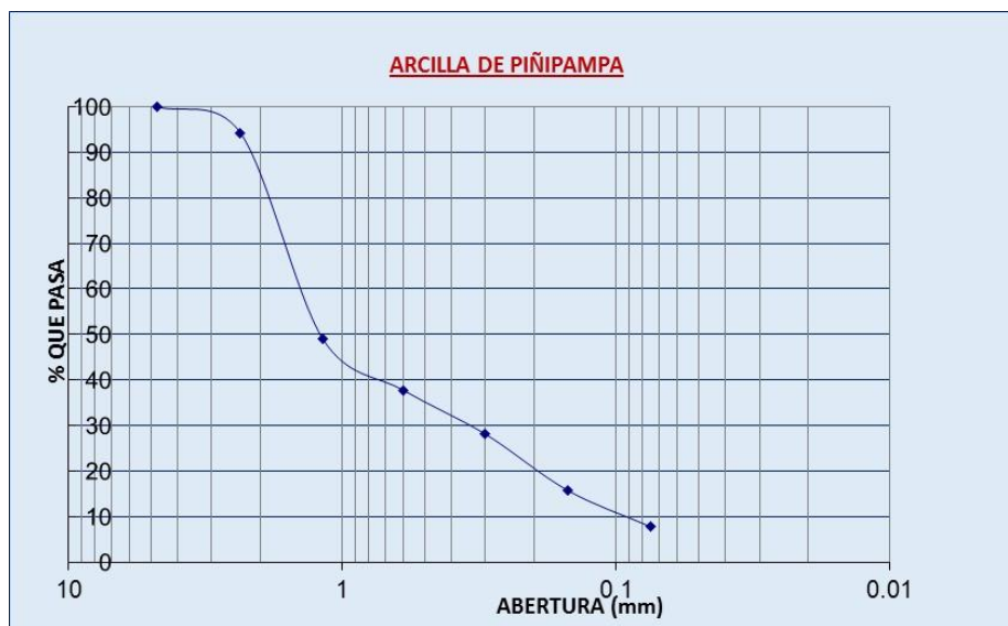
Figura 60: Gráfica de la curva granulométrica de la arcilla de Piñipampa después del proceso de trituración.
