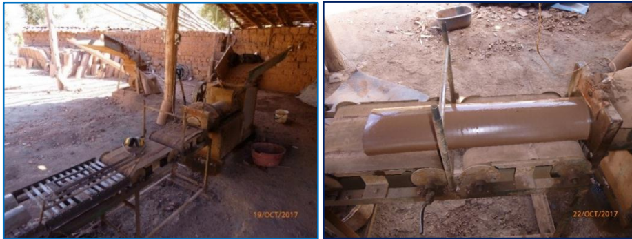
Figura 34: Conformación o moldeo por extrusión de la teja cerámica mecanizada. Fuente: Propia del autor.
