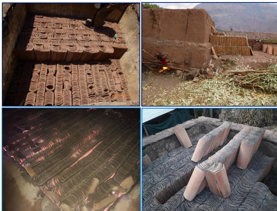
Figura 37: Cargado y cocción de tejas cerámicas en horno tradicional.
