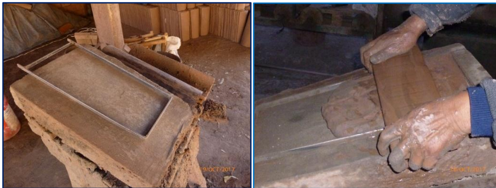
Figura 33: Moldeo o conformación de la teja cerámica artesanal.
