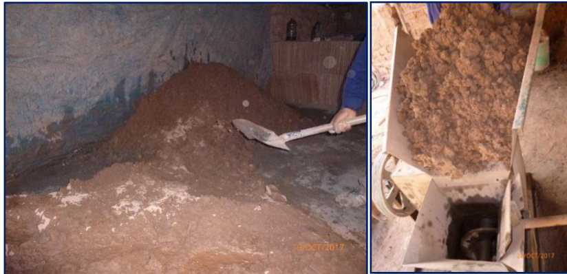
Figura 31: Preparación de materias primas para la teja cerámica mecanizada. Fuente: Propia del autor.
