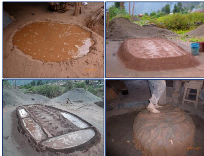
Figura 30: Amasado de materias primas para tejas artesanales. Fuente: Propia del autor
