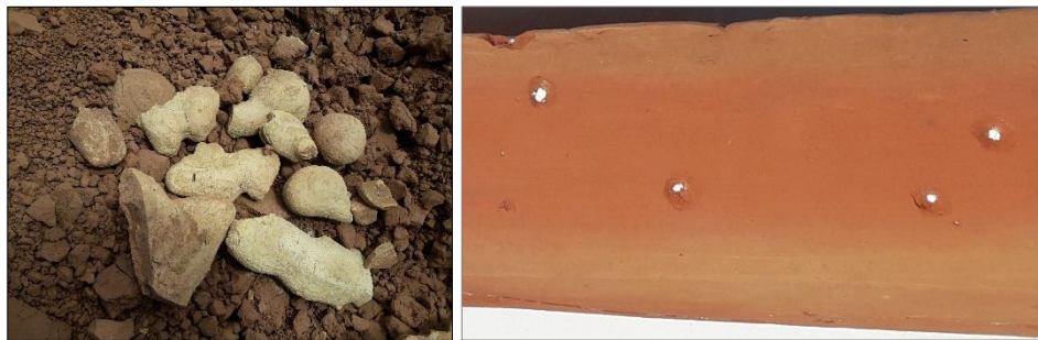
Figura 20: Carbonato de calcio en arcilla y tejas cerámicas. Fuente: Propio del autor.
