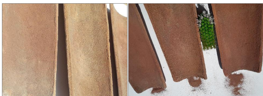
Figura 22: Arena en la superficie cóncava de la teja cerámica artesanal.
