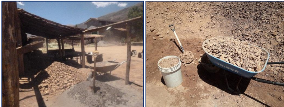
Figura 28: Dosificación de materias primas lista para su molienda.
