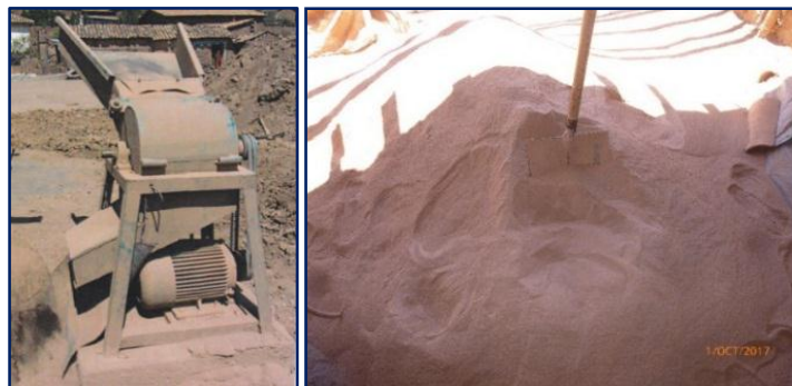
Figura 29: Equipo de trituración de materias primas (arcillas y arena fina).
