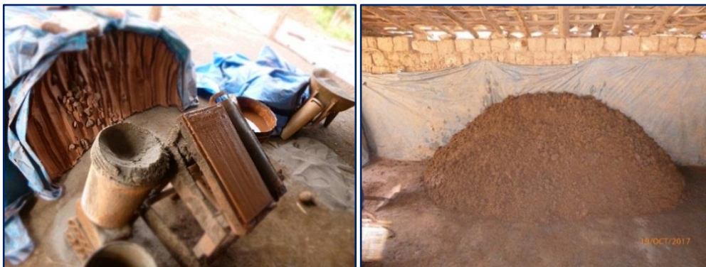
Figura 32: Almacenado de materias primas preparadas para elaborar tejas cerámicas. Fuente: Propia del autor
