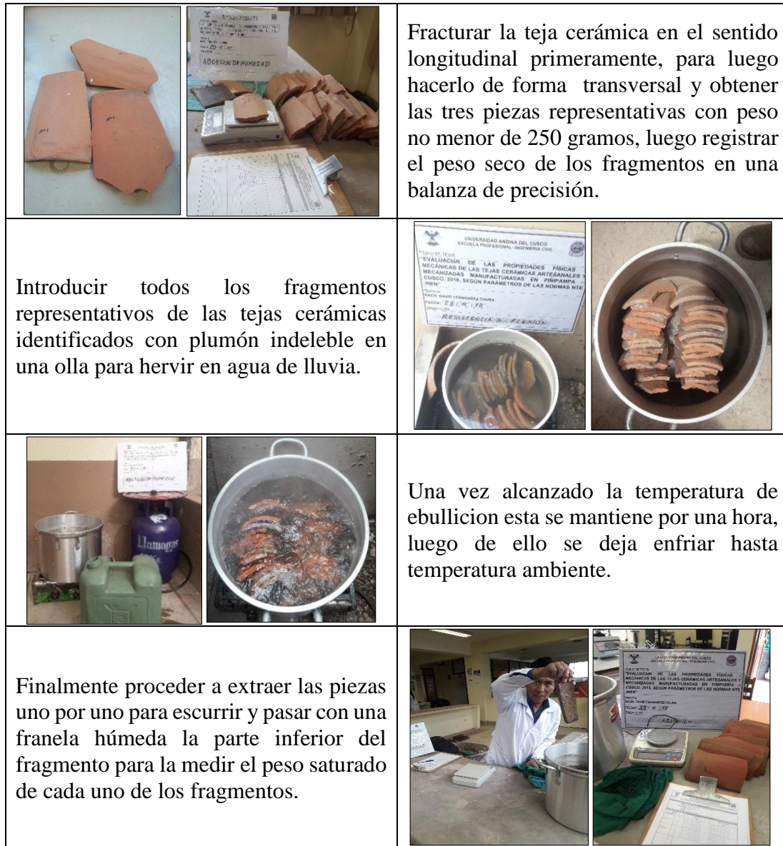
Figura 43: Procedimiento para realizar el ensayo de absorción de agua de la tejas cerámicas.
