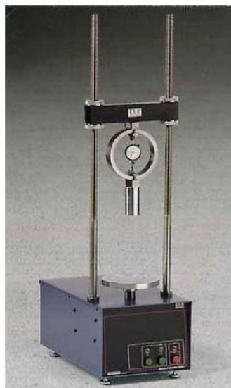
Figura 28: Máquina de estabilidad Marshall con anillo de carga
