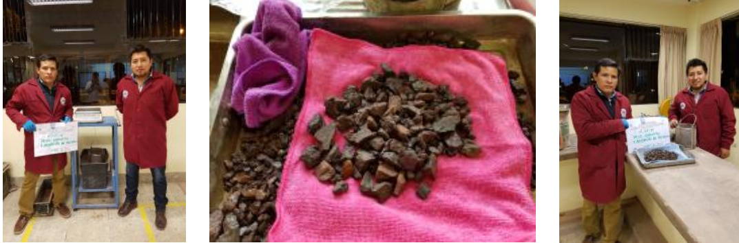
Figura 54: Secado de material húmedo, pesaje al aire y pesaje sumergido
