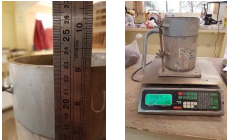
Figura 56: Medición de molde para ensayo
