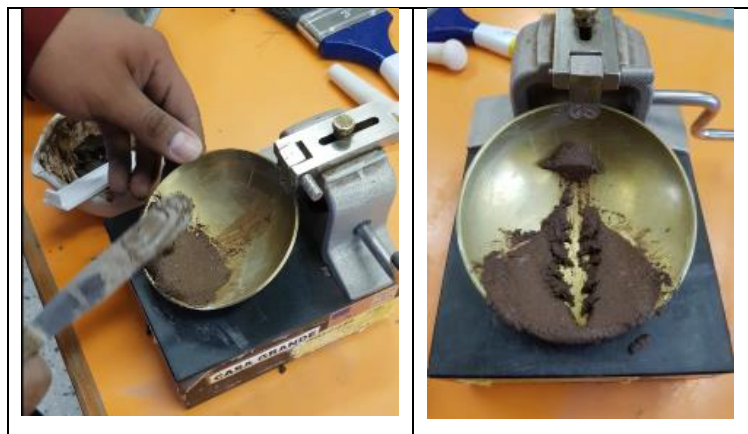
Figura 61: Ensayo de limite liquido con copa de casagrande
