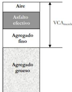
Figura 24: Vacíos del Agregado Grueso en Mezcla, VCA_{mezcla}
