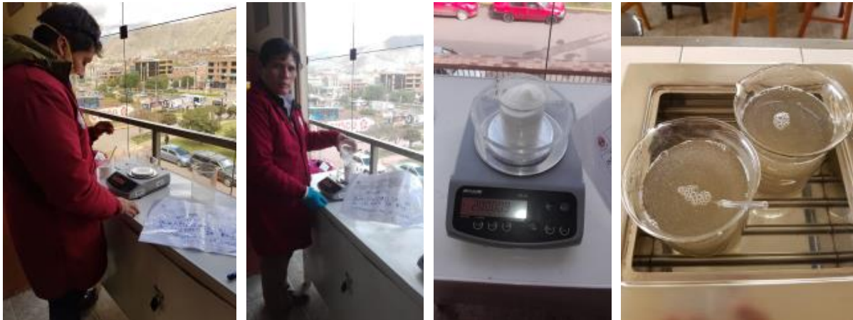
Figura 65: Preparación de solución de sulfato de magnesio heptahidratado - agregado fino
