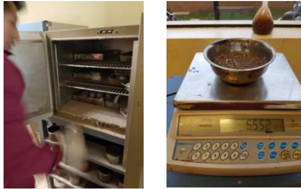
Figura 75: Colocado de material al horno, secado y pesado de material seco
