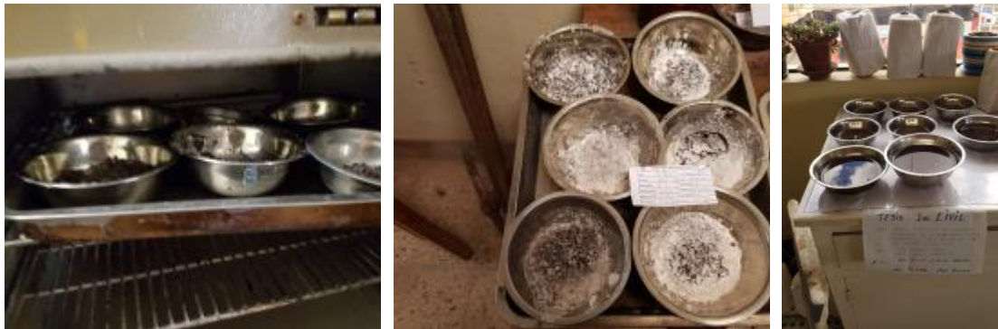
Figura 69: Secado de muestras, enfriado y vertido de sulfato de magnesio – agregado fino
