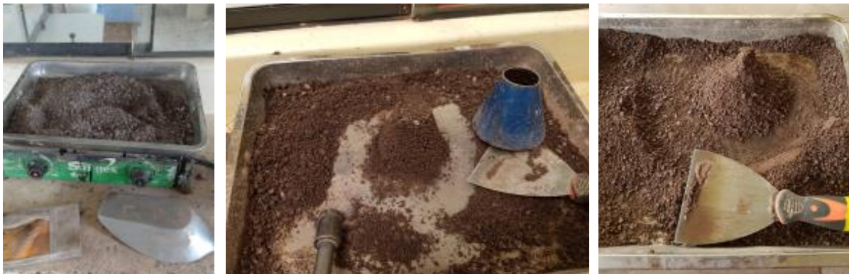
Figura 72: Secado y prueba con el molde cónico
