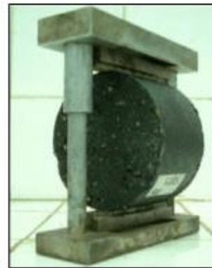
Figura 29: Ensayo de tracción indirecta durante carga (Huang, 1996) (izq.), espécimen de prueba para ensayo de compresión diametral (der.)
