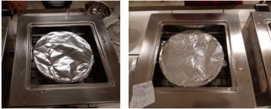
Figura 48: Muestras en solución y colocado en baño maría – agregado grueso
