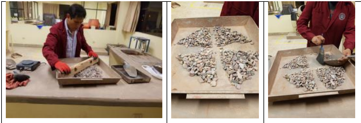
Figura 53: Cuarteo de material para obtención de muestra y pesaje de muestra
