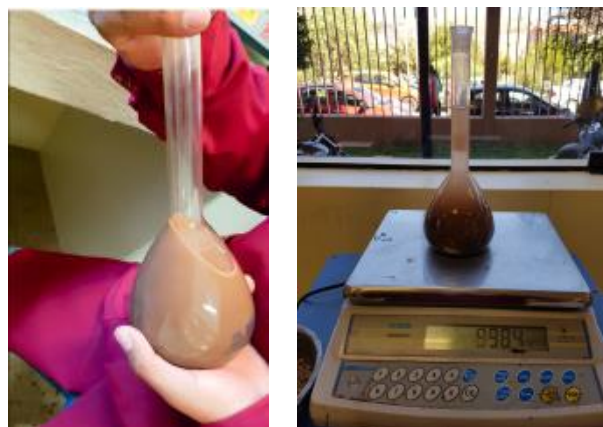
Figura 74: Eliminación de burbujas de aire con ayuda de bomba de vacíos
