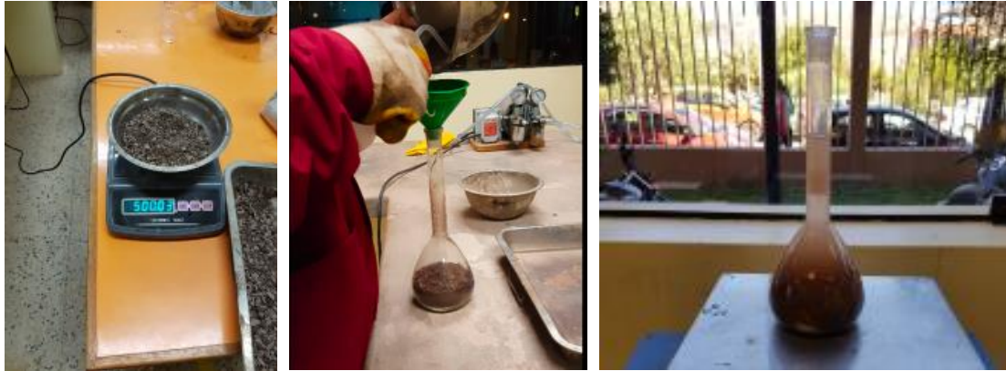
Figura 73: Colocado de 500 gr de material en fiola llenado con agua hasta marca y agitado
