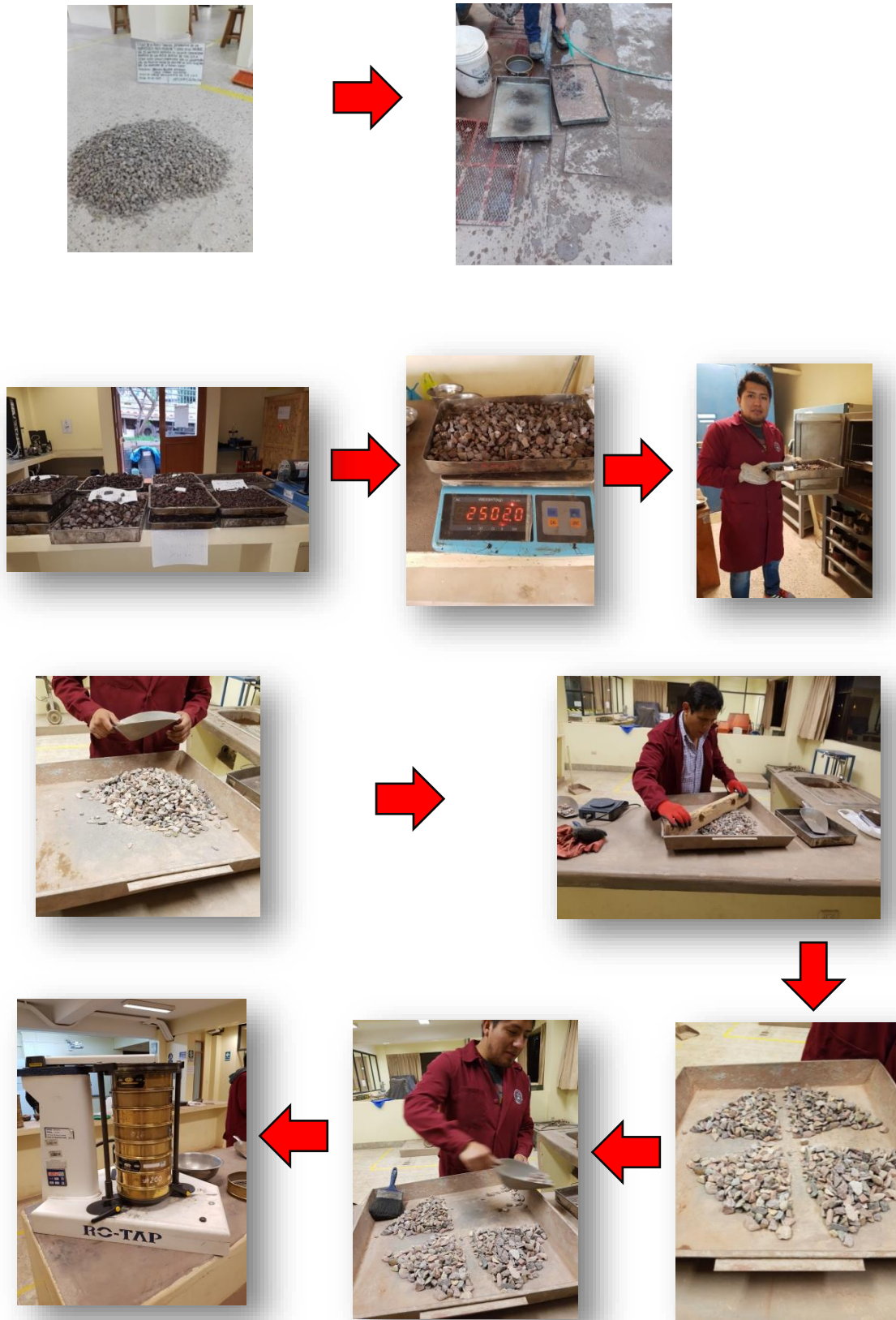
Figura 37: Cuarteo y colocación de material en serie de tamices y tamizado mecánico.
