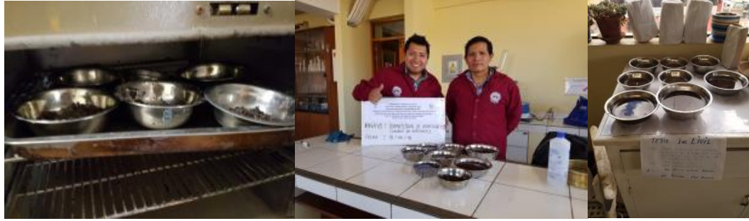
Figura 50: Muestras al horno, enfriado y vertido de sulfato de magnesio – agregado grueso
