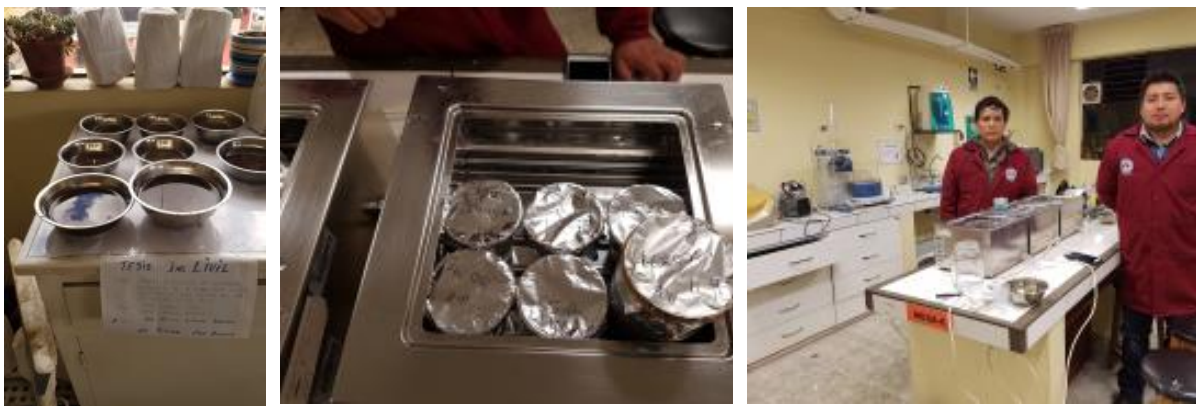
Figura 67: Colocado de muestras en solución sulfato de magnesio heptahidratado y mantenido en baño maría – agregado fino
