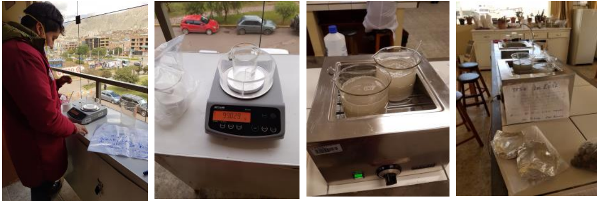
Figura 46: Preparación de solución se sulfato de magnesio heptahidratada - agregado grueso
