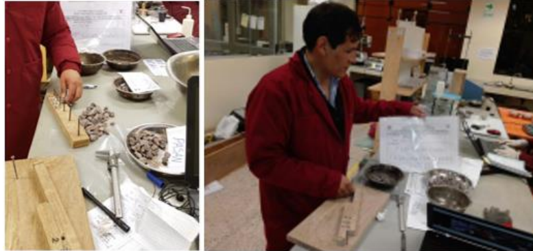
Figura 44 Medición de las partículas con el calibrador de espesores de partículas chatas y alargadas
