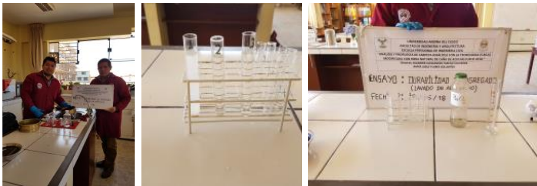
Figura 51: Lavado de material con agua destilada y comprobación con cloruro de bario – agregado grueso
