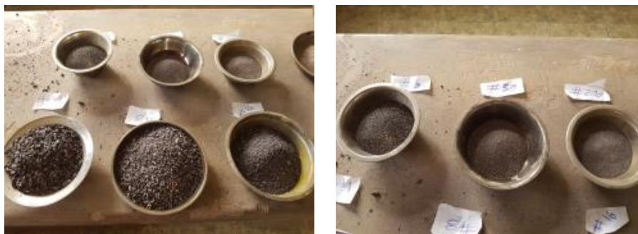
Figura 77: Tamizado de material por mallas según TMN 19
