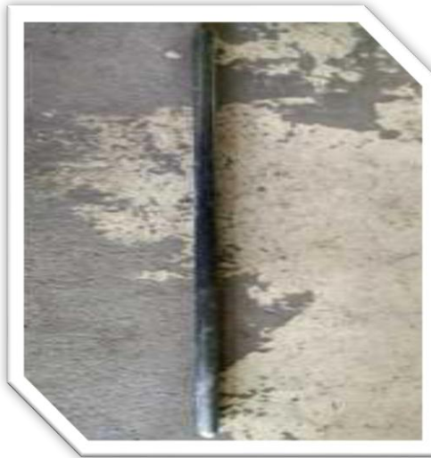
Fotografía 13. Barra compactadora de 5/8" de 60 cm con punta semiesférica.
