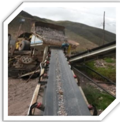
Fotografía 24. Chancado de briquetas, tamaño máximo de \frac{3}{4} ".
