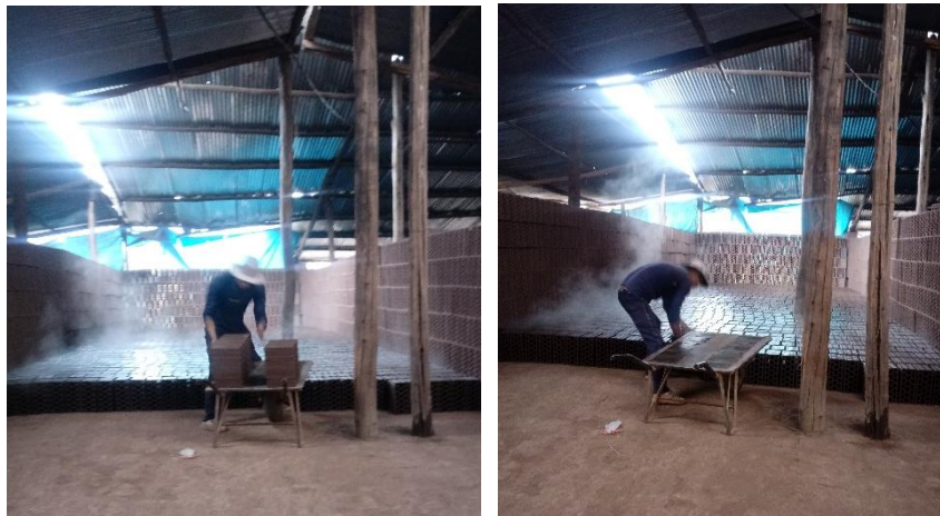
Figura 68: Peligro Ergonómico - Movimiento Repetitivo, colocar los ladrillos cortados en los tendales. Fotografía Propia
