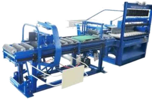
Figura 11. Cortador Automático Multifilos, producto de Industrias FELIMAQ
