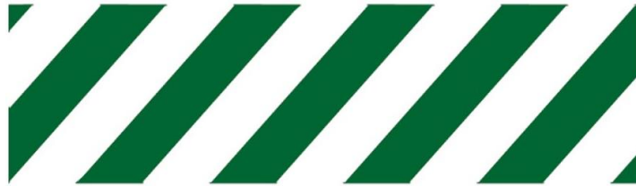
Figura 83: Franja de Seguridad - Condición De Emergencia
