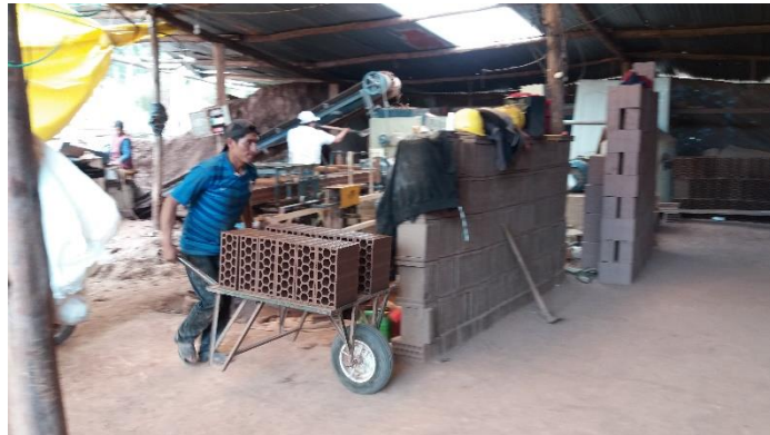
Figura 71: Peligro Ergonómico - Manipulación de cargas pesadas al momento de trasladar los ladrillos en las carretillas planas. Fotografía Propia
