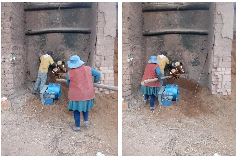
Figura 72: Peligro Ergonómico - Manipulación de cargas pesadas al momento de trasladar los insumos de combustión al horno. Fotografía Propia
