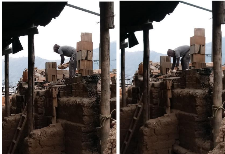
Figura 69: Peligro Ergonómico - Movimiento Repetitivo, colocar los ladrillos en el horno. Fotografía Propia
