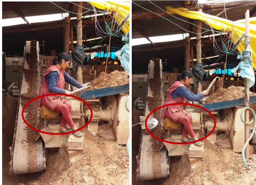
Figura 60: Riesgo Físico – Vibraciones del cuerpo entero provocado por el motor de la Máquina Homogenizadora. Fotografía Propia
