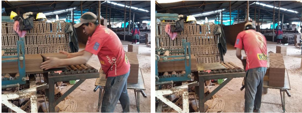
Figura 67: Peligro Ergonómico - Movimiento Repetitivo, traslado de ladrillos cortados a los tendales. Fotografía Propia
