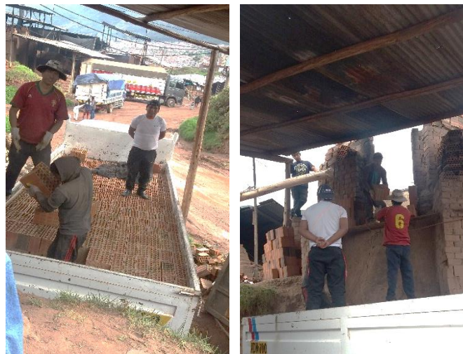
Figura 70: Peligro Ergonómico - Movimiento Repetitivo, descargar los ladrillos del horno. Fotografía Propia
