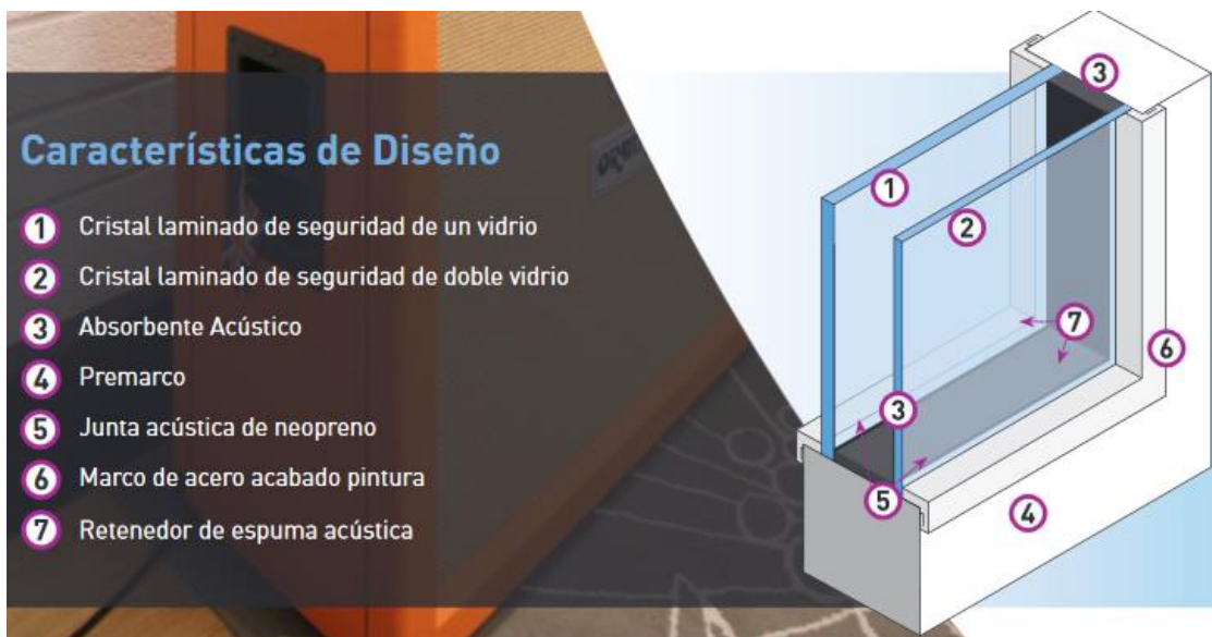
Figura 71: partes de ventana acústica
