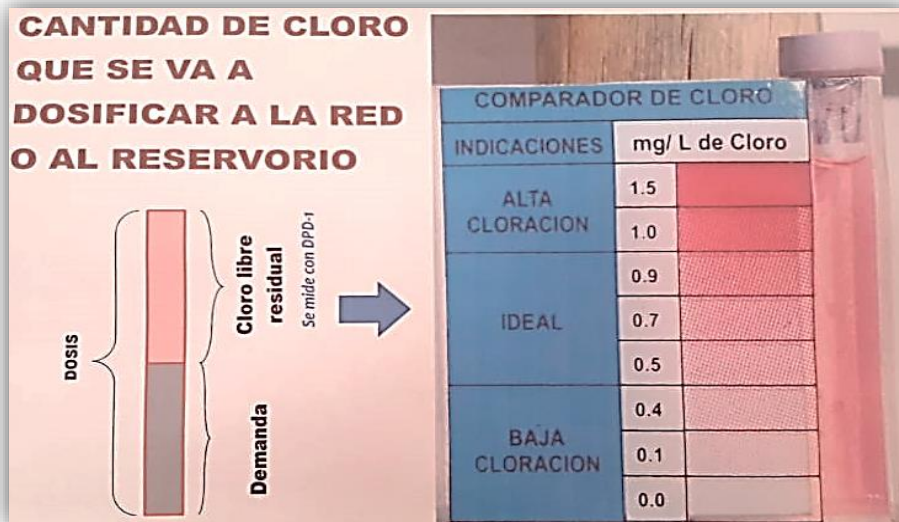
Figura 11. Comparador de cloro de dosificaciones
