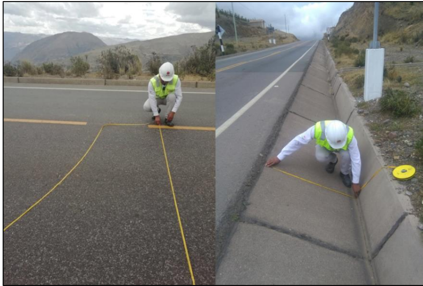
Figura 15. Toma de medidas de las características físicas de la carretera. Fuente: Elaboración propia, 2018.
