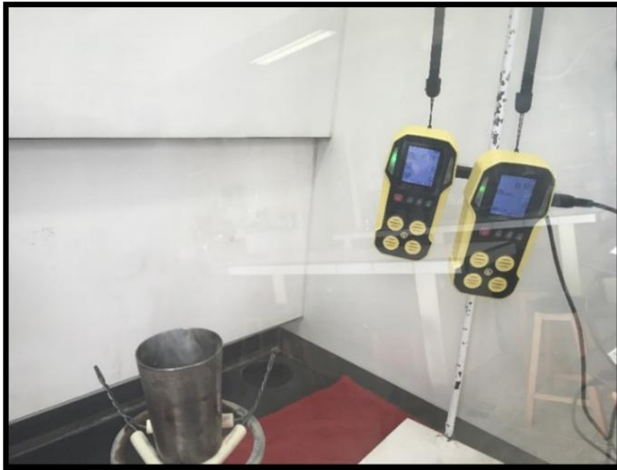
Figura 32: Medición de gases producidos por PET
