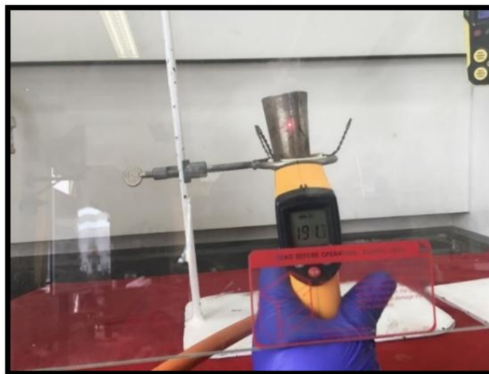
Figura 31: Medición de temperatura de crisol con PET
