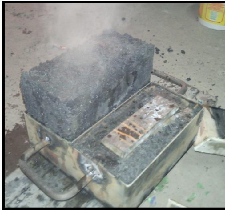
Figura 17: Primer ladrillo de PET y arena gruesa
