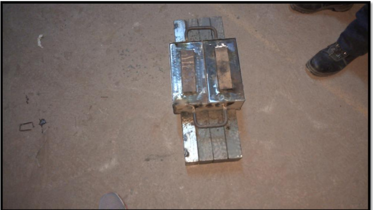
Figura 53: Molde para ladrillos terminado
