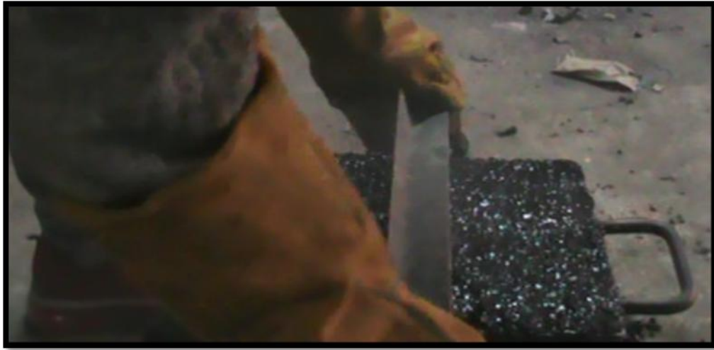
Figura 24: Enrasar el PET y arena gruesa en caliente.
