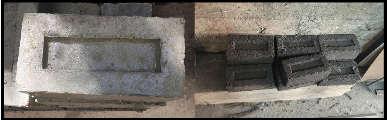
Figura 2: Ladrillos de PET y arena gruesa.
