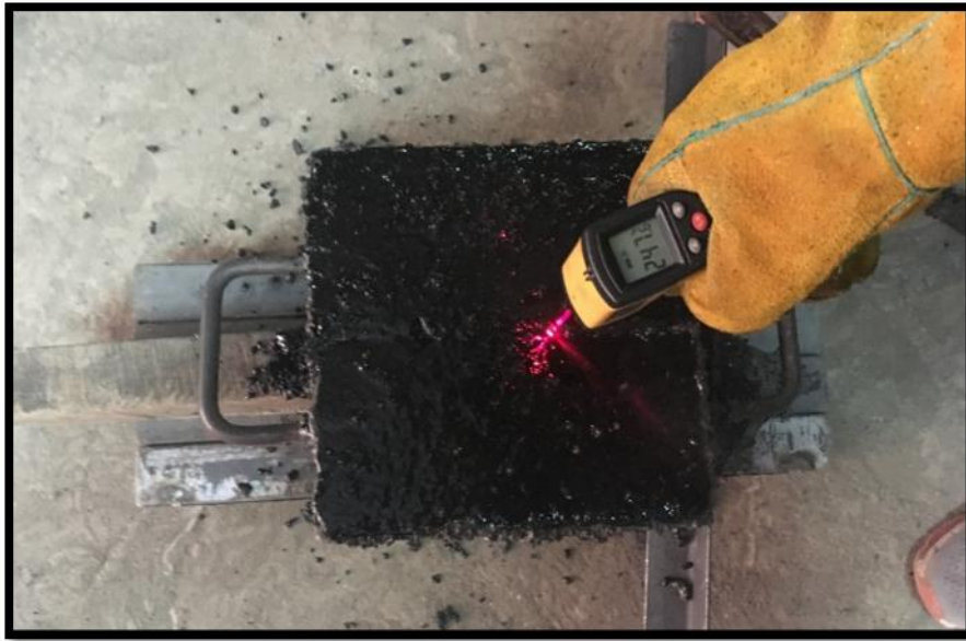
Figura 26: Medicion de temperatura de PET y arena gruesa antes de enfriado.
