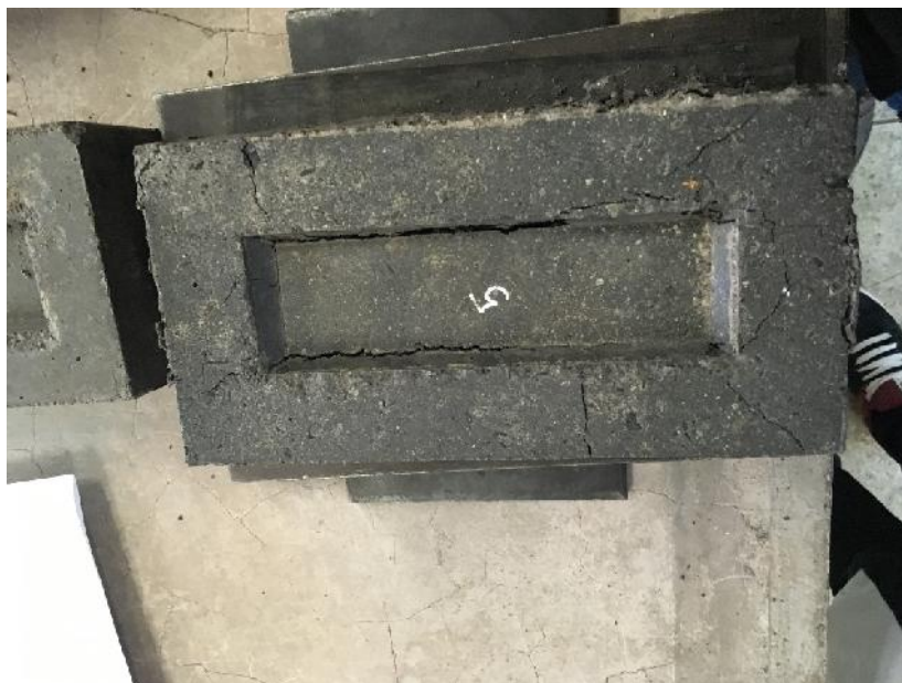
Figura 47: Ladrillo de PET 80% y arena gruesa 20%, sometido a compresión
