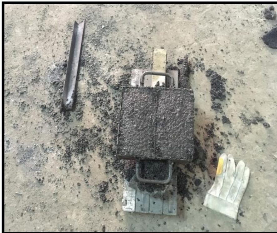
Figura 27: Ladrillo de PET frio previo a desmolde.
