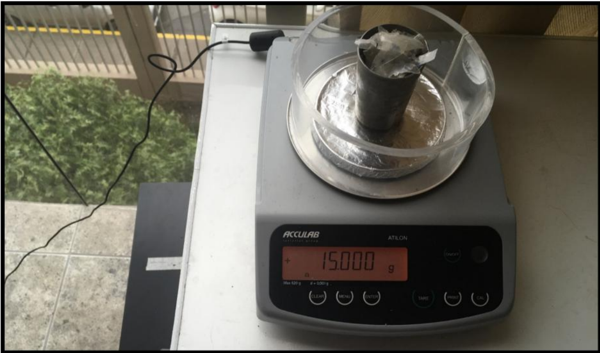
Figura 56: Pesado de PET para ensayo de emisión de gases
