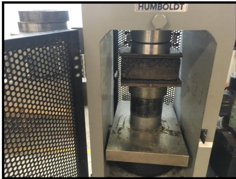
Figura 46: Prueba de resistencia a compresión de ladrillo de PET y arena gruesa
