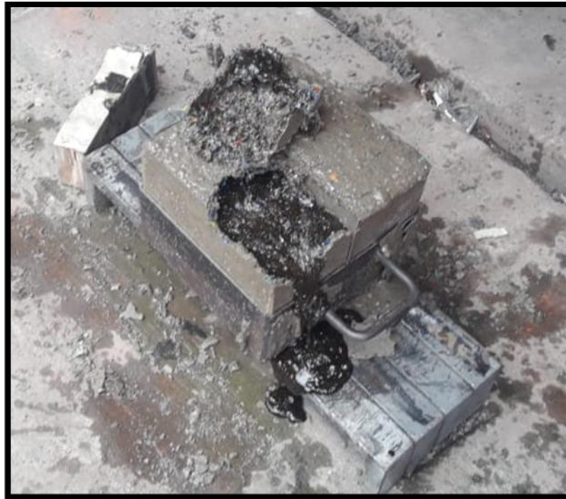
Figura 28: Ladrillo desmoldado antes de tiempo.
