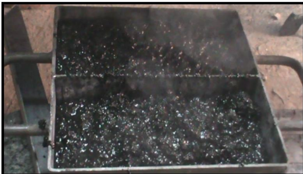
Figura 23: PET y arena gruesa en molde
