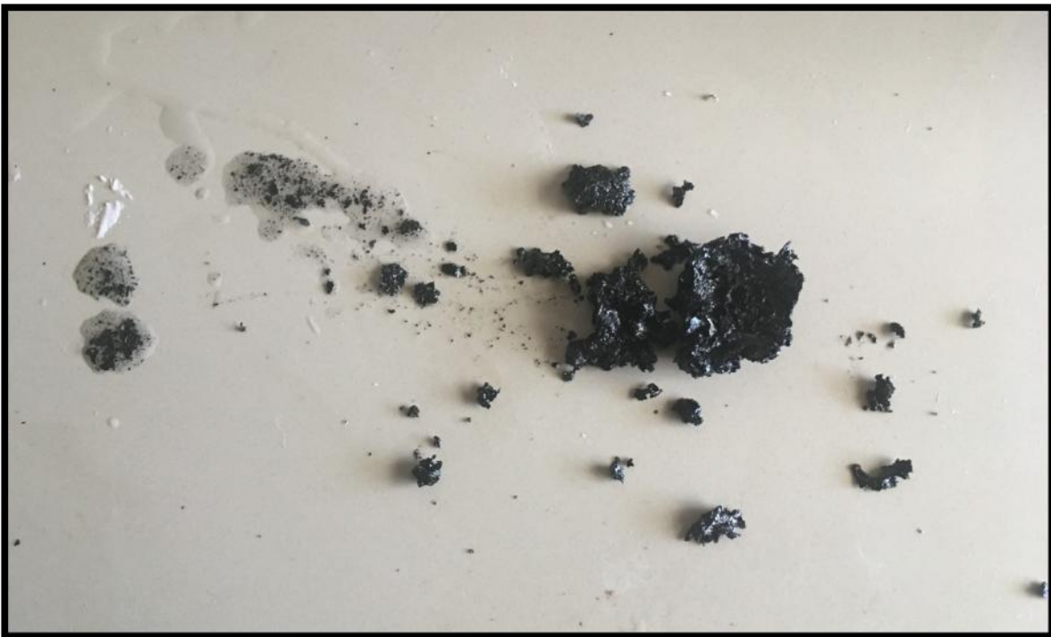
Figura 57: PET quemado después de ensayo de emisión de gases
