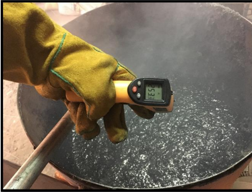
Figura 22: Medición de temperatura previa ha moldeado.
