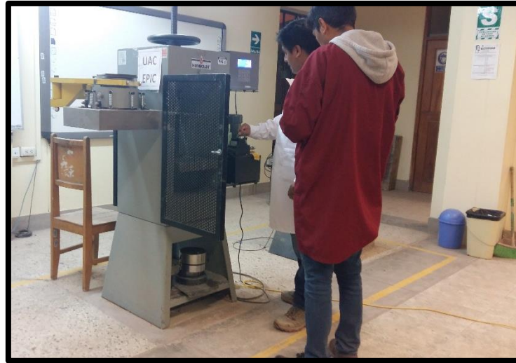
Figura 57: Toma de datos de valores obtenidos de cada rotura de concreto.
