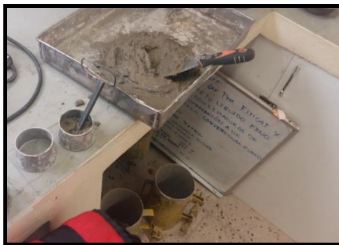
Figura 40: Elaboración de la mezcla de concreto.
