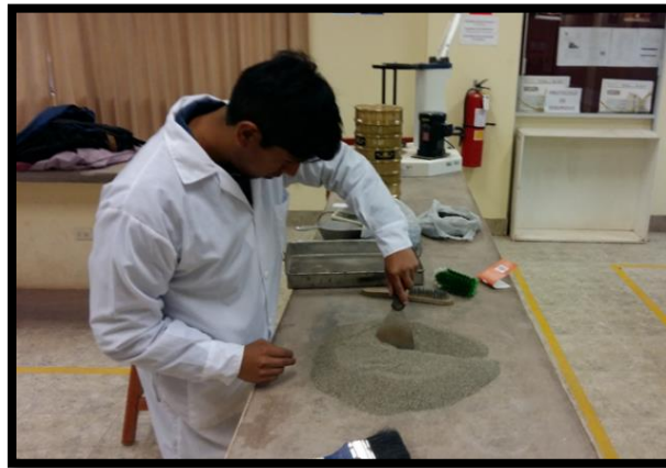
Figura 30: Selección de material mediante el método de cuarteo.
