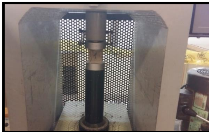
Figura 56: Visualización del cubo fracturado que indica la resistencia máxima alcanzada.
