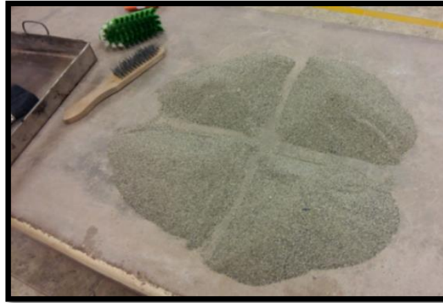
Figura 37: Método de cuarteo para seleccionar la arena fina.
