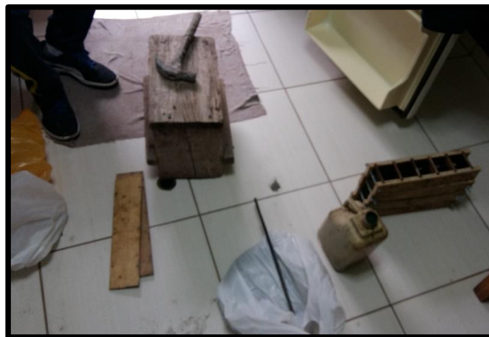
Figura 63: Preparación de los moldes.
