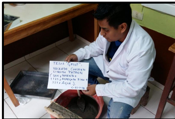
Figura 65: Vaceado del concreto líquido en los moldes.
