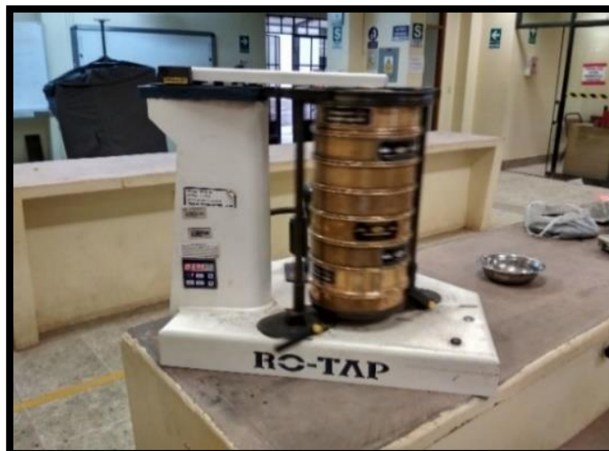
Figura 33: Vibración de los tamices mediante el uso de una máquina.
