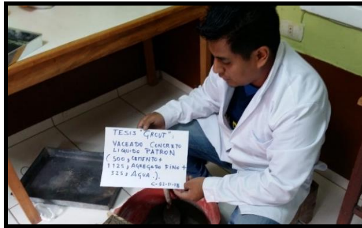
Figura 48: Proceso de mezclado de los materiales para elaboración de concreto.
