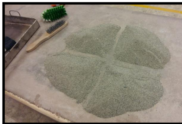
Figura 74: Cuarteo de la muestra de la arena fina.
