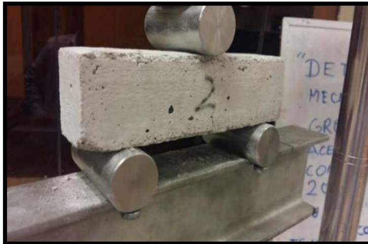
Figura 68: Colocación de la vigueta sobre una barra con dos apoyos cilíndricos.
