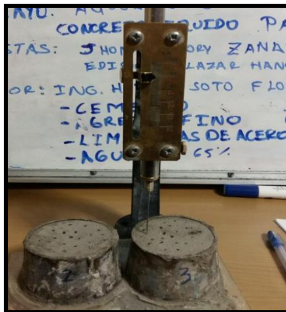
Figura 81: La aguja Vicat deja de penetrar en el concreto líquido.
