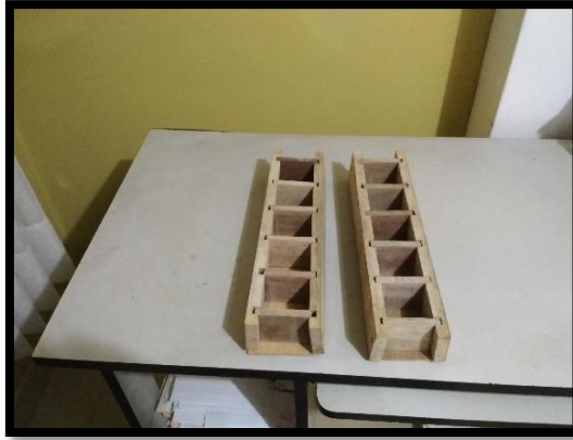
Figura 27: Moldes cúbicos de madera de 50 mm de lado.
