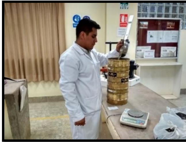
Figura 32: La arena fina y las limaduras se echaron dentro del juego de tamices.
