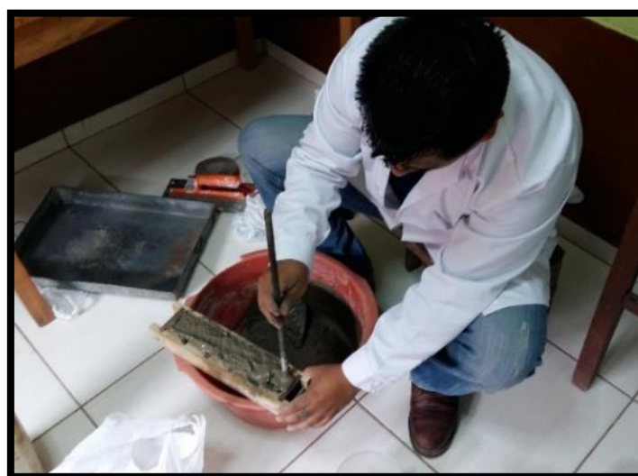
Figura 49: Llenado de los moldes con la mezcla de concreto.
