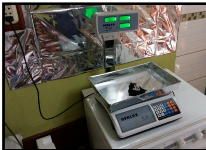
Figura 45: Pesado de la limadura de acero.
