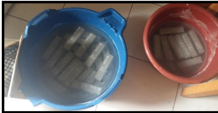
Figura 66: Fraguado de las barras del concreto líquido.
