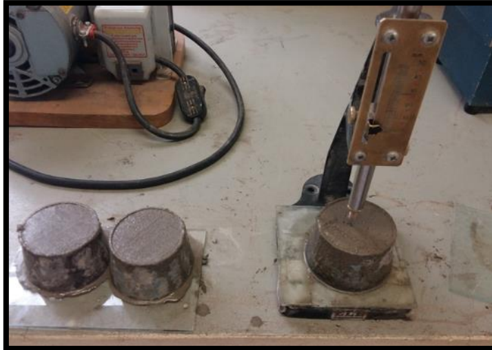
Figura 80: Penetración de la aguja Vicat dentro del concreto.
