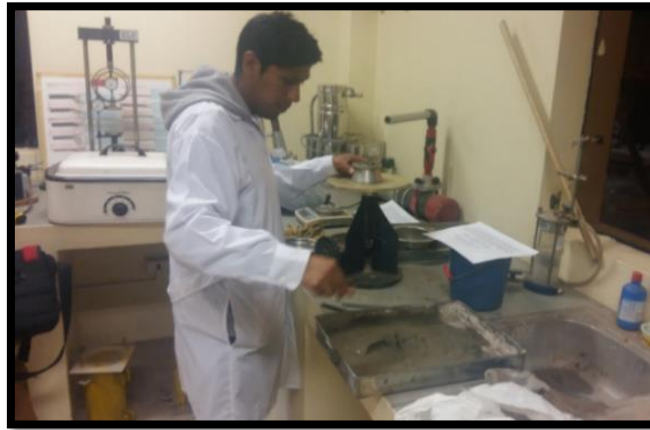
Figura 41: Llenado del molde troncocónico con concreto líquido.
