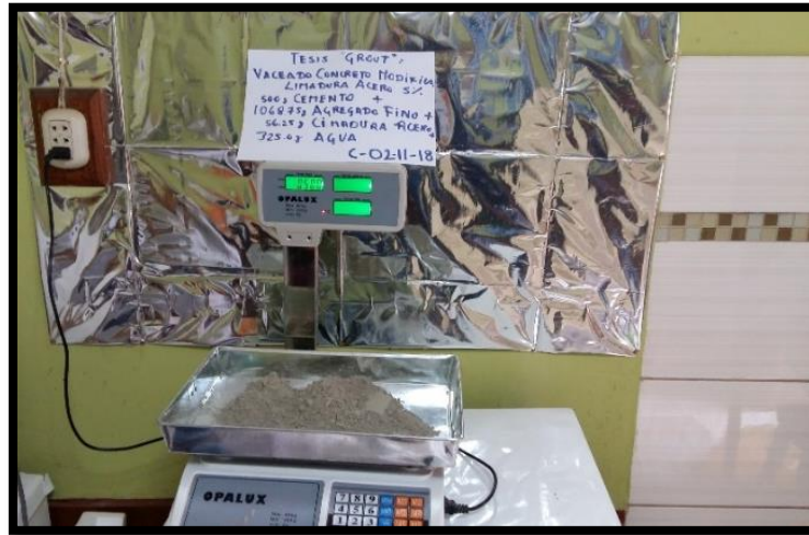
Figura 62: Pesado del cemento.
