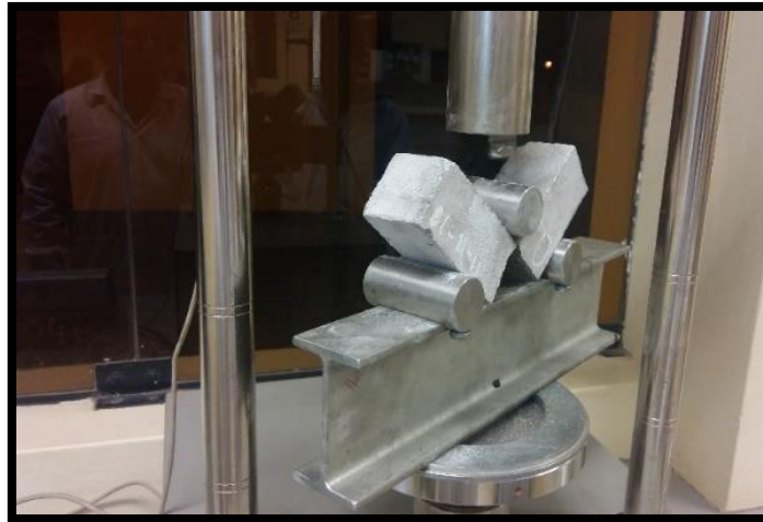
Figura 71: Rotura de vigueta por acción de una carga máxima.
