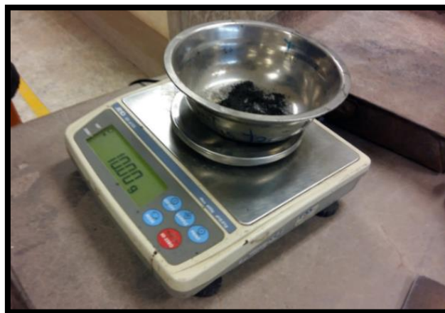
Figura 31: Peso de limadura de acero.
