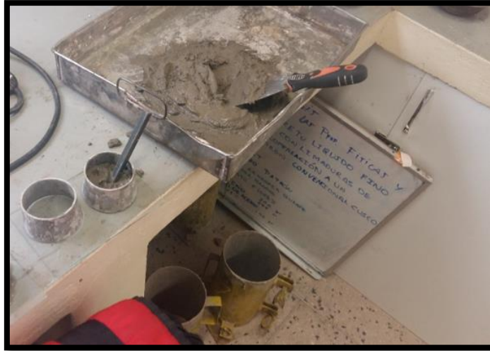
Figura 77: Proceso de elaboración de la mezcla de concreto.
