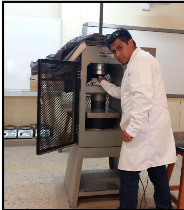
Figura 53: Colocación de los cabezales.
