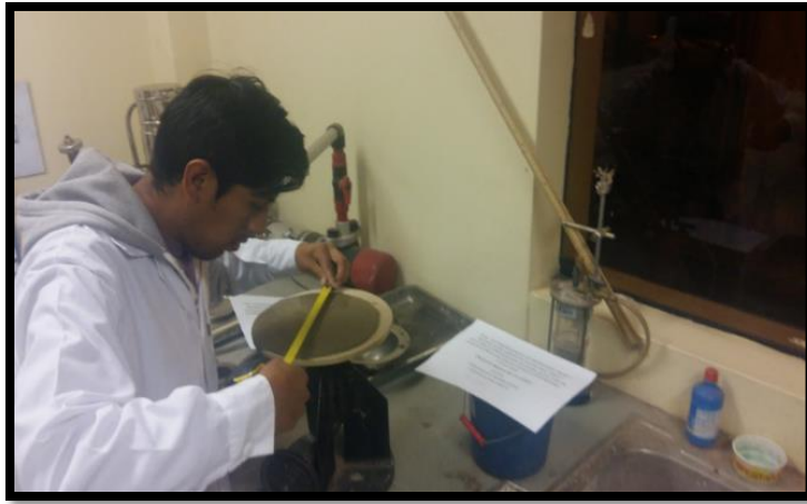
Figura 43: Medición del diámetro de expansión del concreto líquido.
