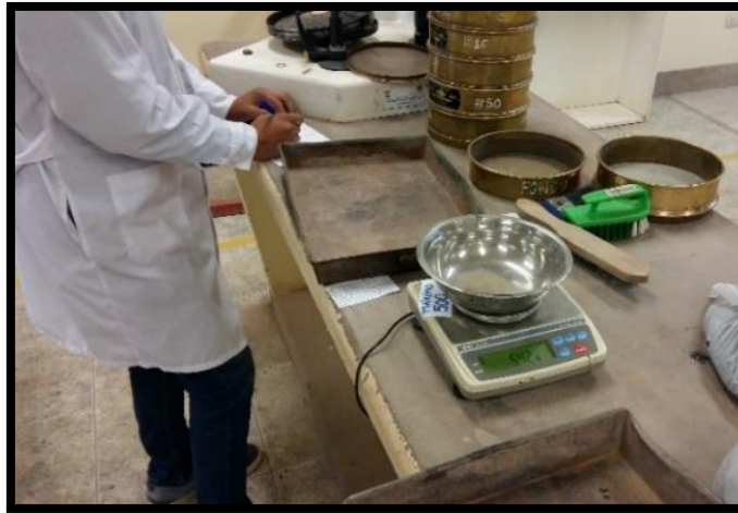
Figura 34: Pesado de cada muestra de material retenido en los tamices.
