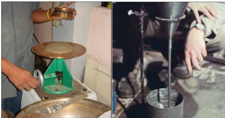
Figura 18: Ensayo de consistencia grout fino.
