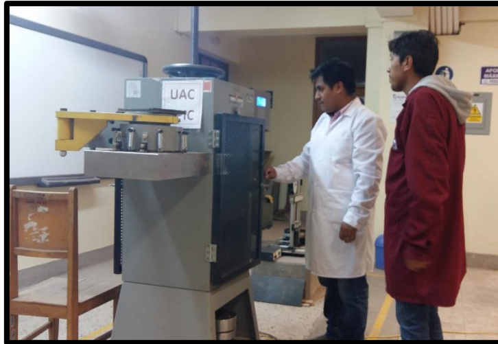
Figura 55: Colocación del cubo de concreto en la máquina de compresión.
