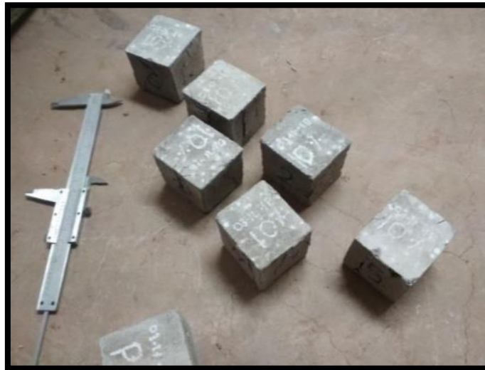
Figura 52: Medición del área de los cubos.
