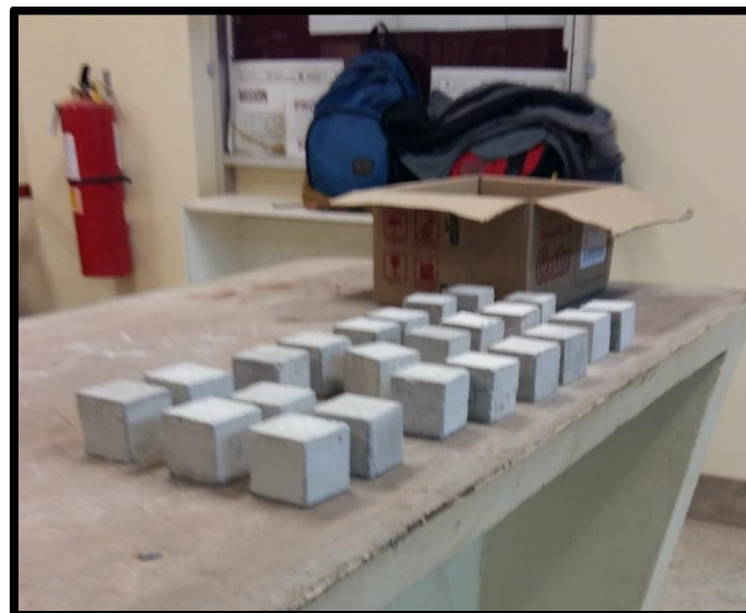
Figura 58: Bloques de cubo de concreto patrón y su adición con limaduras de acero.
