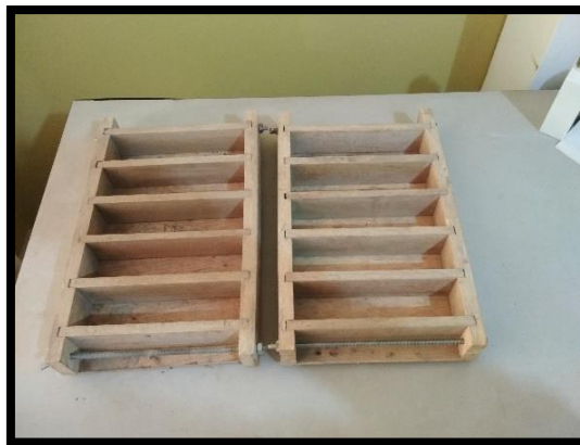
Figura 28: Moldes tipo barra de 4cm x 4cm x 16cm de lado.
