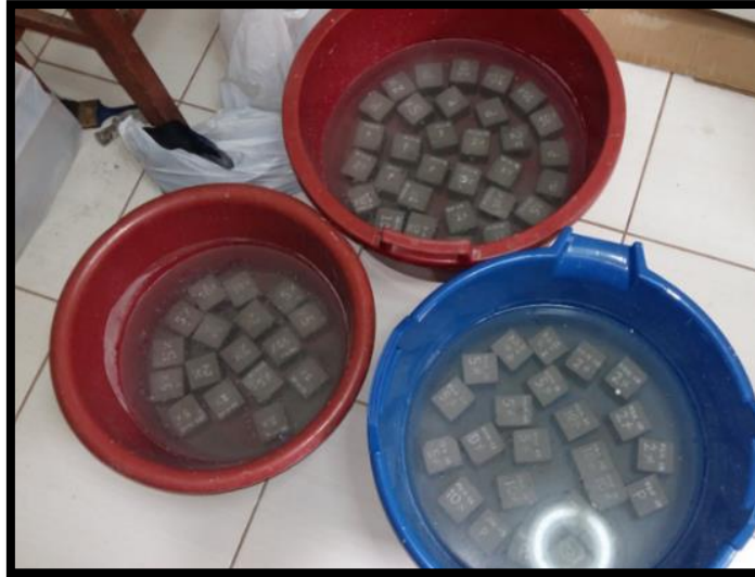
Figura 50: Fraguado de los cubos de concreto.
