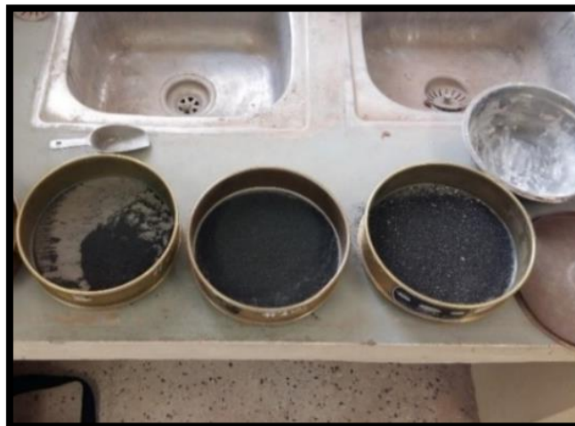
Figura 38: Tamizado de la limadura de acero.
