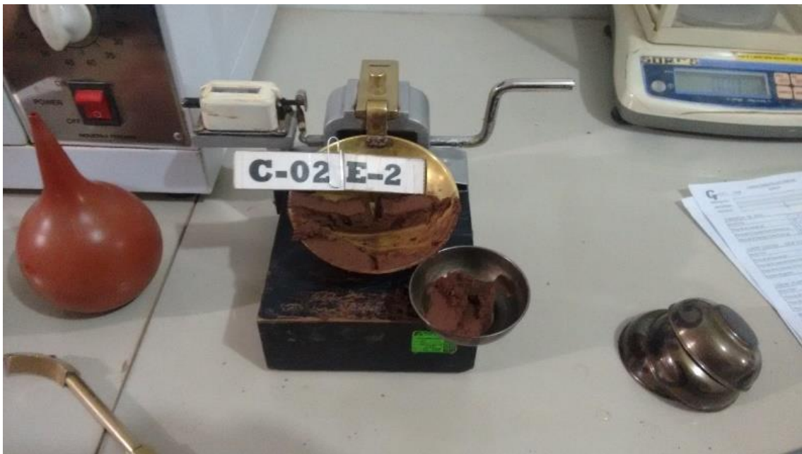
Figura 47 : Muestra ranurada en la copa de Casagrande.
