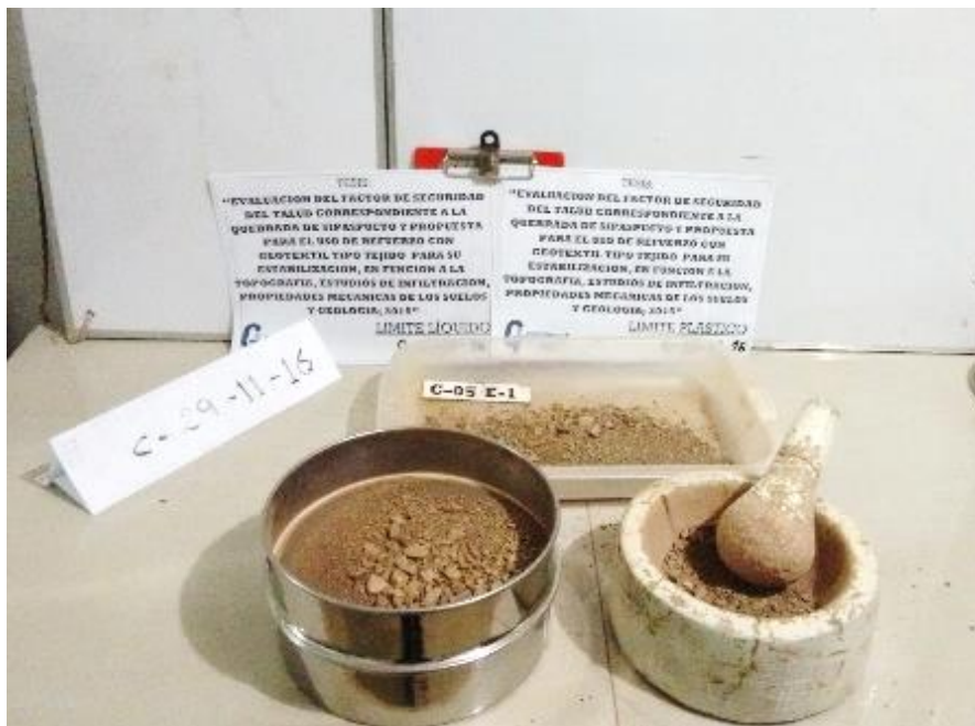
Figura 44: Obtención de muestra para el ensayo de límites de consistencia
