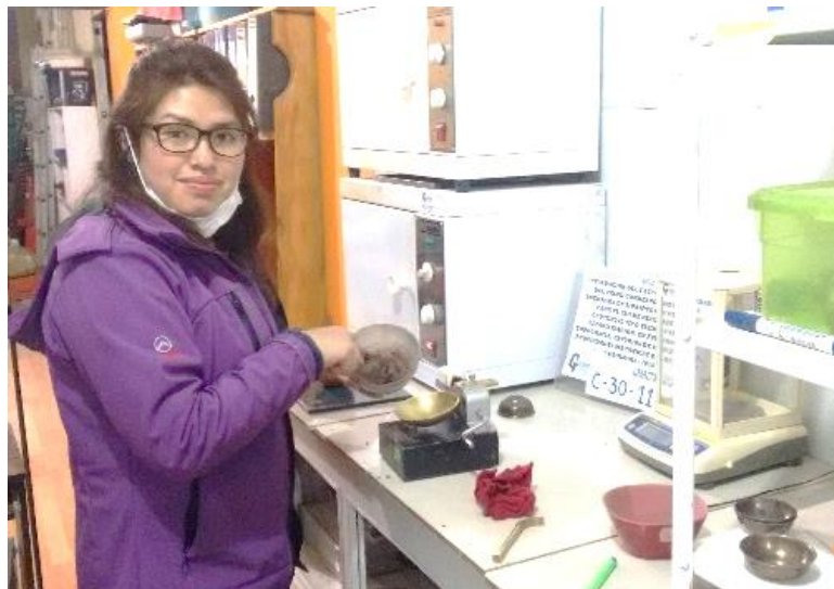
Figura 46: Colocación de la muestra en la copa Casagrande y ranurado de la misma.
