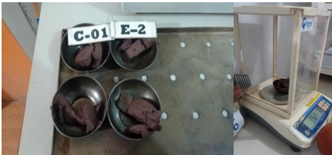
Figura 49 : Pesado de las muestras para posteriormente ponerlas al horno
