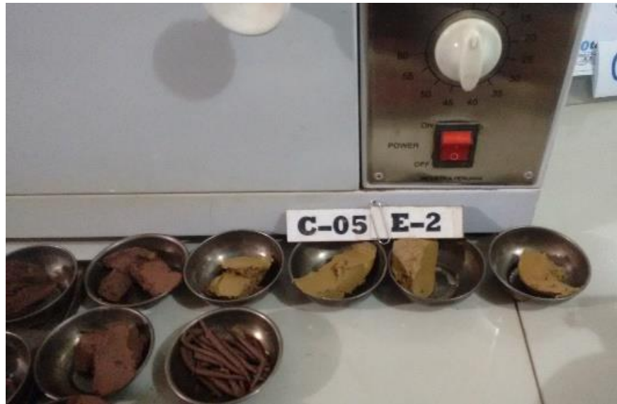
Figura 52: Recipientes metálicos debidamente identificados, para ser colocados en el horno por 24 horas.
