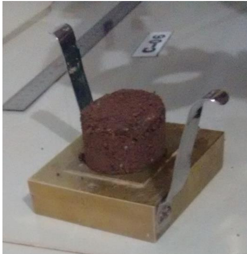
Figura 56: Colocación de la muestra dentro de la caja de corte.
