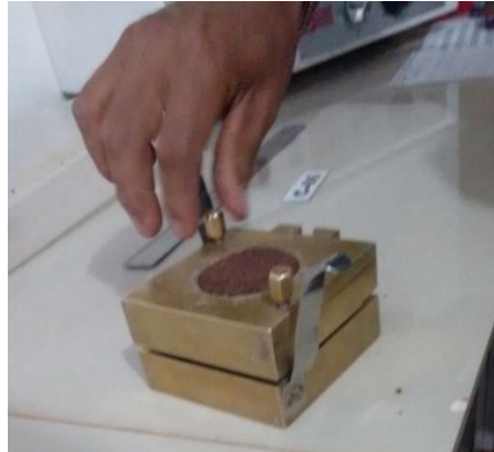
Figura 58 : Tornillos retrocedidos de la caja de corte
