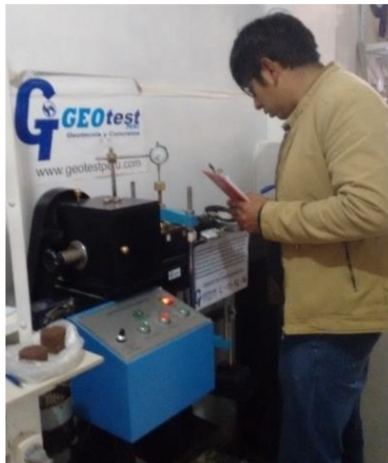
Figura 61: Toma de lecturas del deformimetro de carga.
