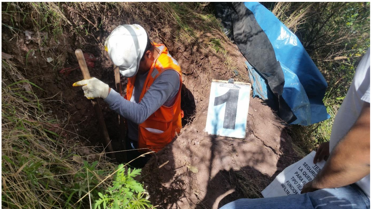
Figura 63: Preparación de la calicata a prospectar
