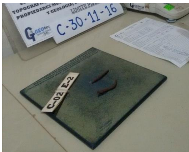
Figura 51: Rollitos cilíndricos de 3mm de diámetro y 5 cm de longitud.
