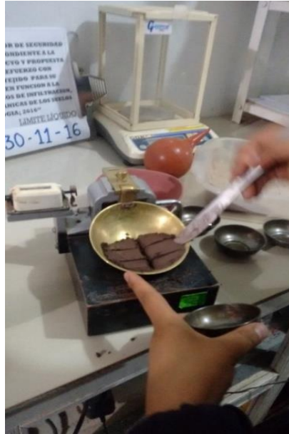
Figura 48: Obtención de la muestra de la copa Casagrande.
