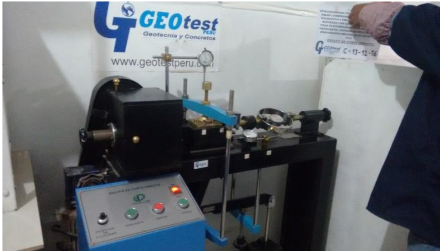
Figura 60: Fijación en cero del deformimetro horizontal y vertical.
