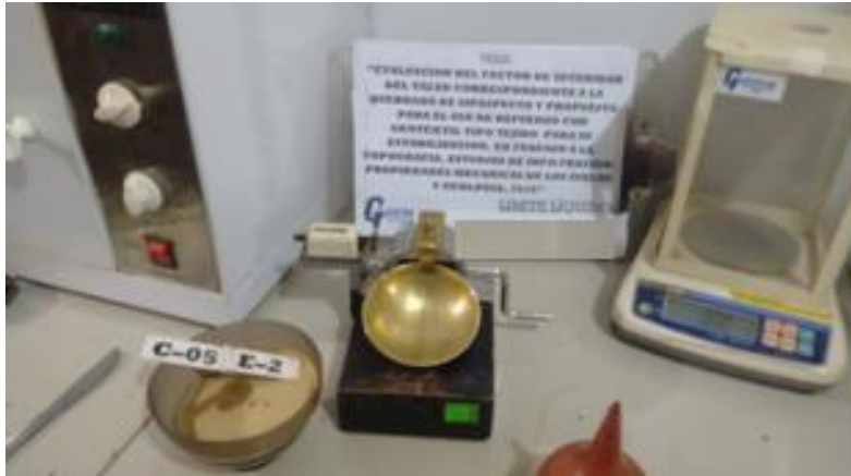
Figura 45: Preparación y calibración de la copa de Casagrande
