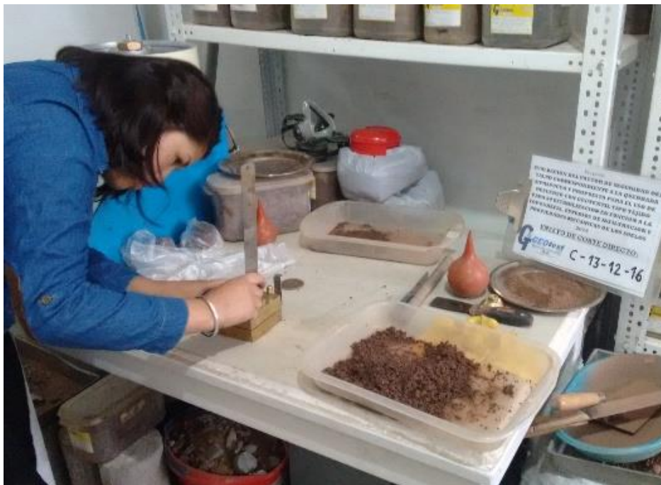
Figura 55: Toma de dimensiones de la caja de corte.
