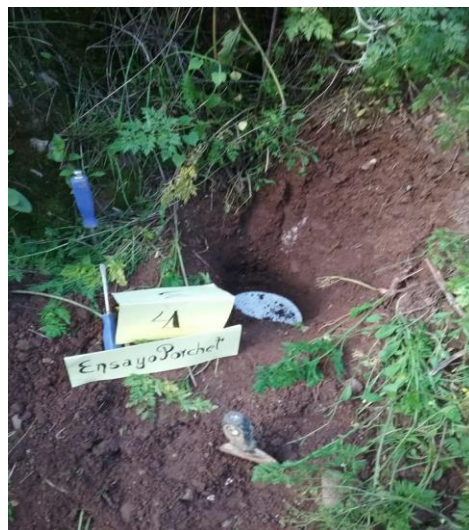
Figura 32 : Excavación y colocación del tubo de ensayo
