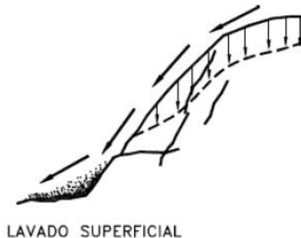
Figura 6 : Proceso de deterioro en macizos rocosos Fuente: Suarez Díaz, 1988
