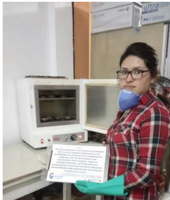
Figura 36 : Colocación de la muestra para el secado en horno a temperatura constante (110° ± 5° C)
