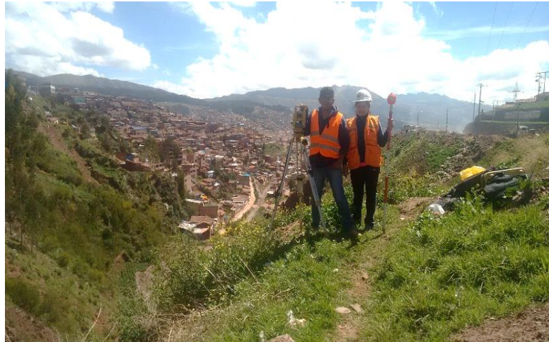
Figura 28 : Inicio de la toma de puntos para el levantamiento topográfico
