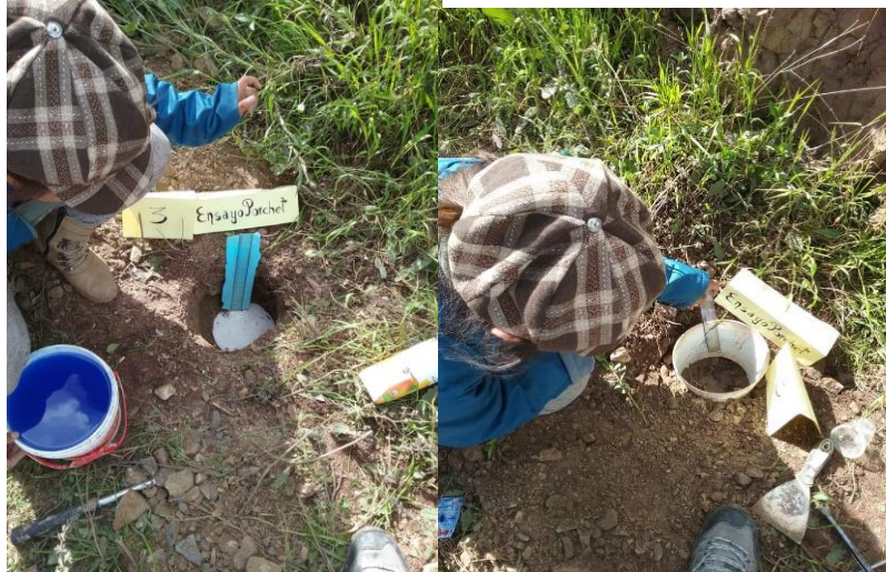
Figura 33 : Colocación del tubo de ensayo y toma de datos (tiempo y altura)
