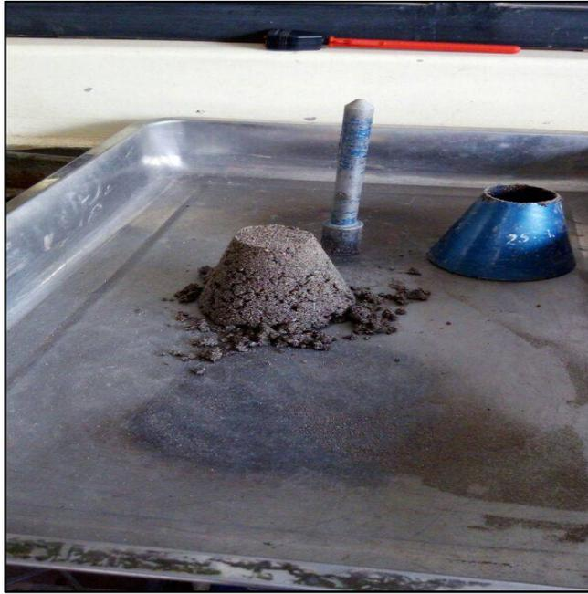
**Figura 29.** Aplicación del cono de absorción.
