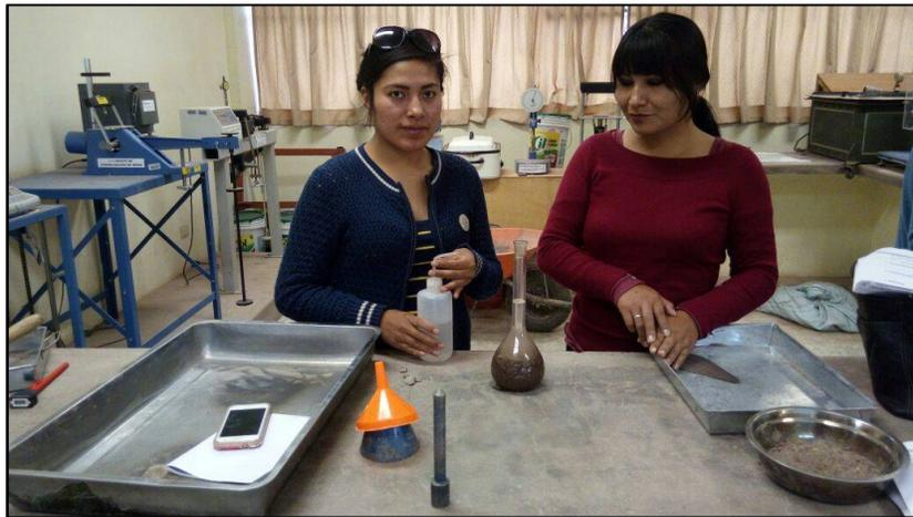
**Figura 30.** Eliminación del aire con bomba de vacíos
