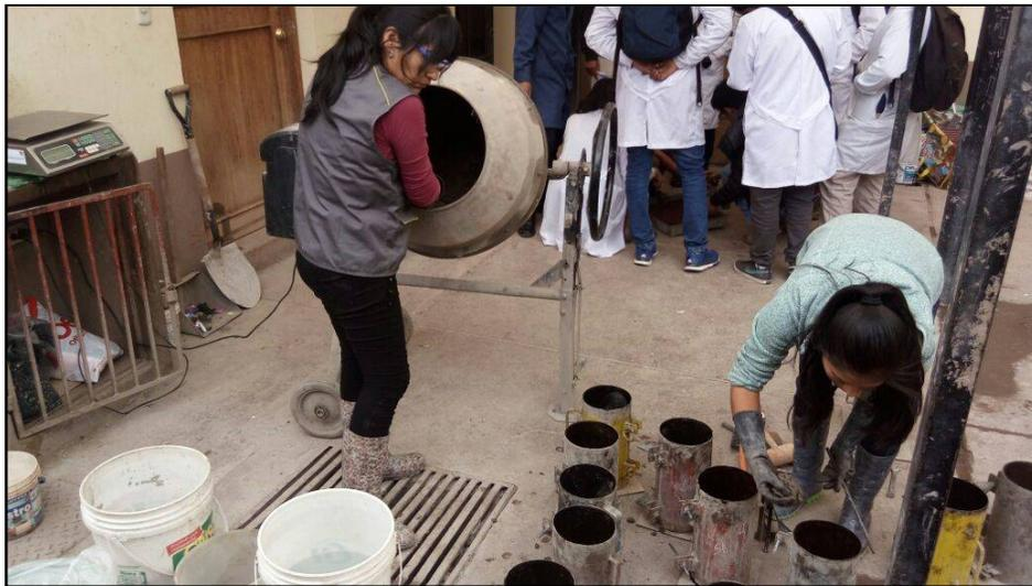
*Figura 40.* Proceso de mezclado de los agregados, cemento, agua.
