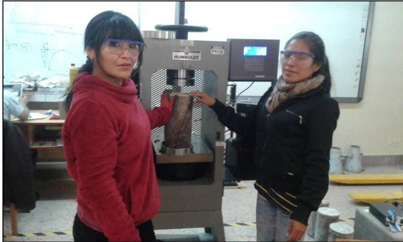
*Figura 50.* Montaje para el ensayo de compresión uniaxial
