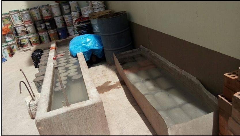
*Figura 49:* Curado del concreto de diferentes edades unidas con puente de adherencia
