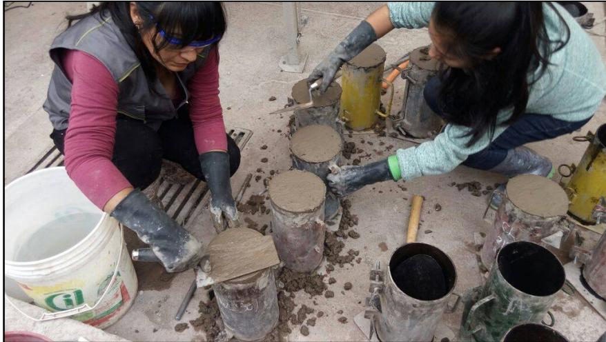
**Figura 43.** Enrasado de las probetas cilíndricas
