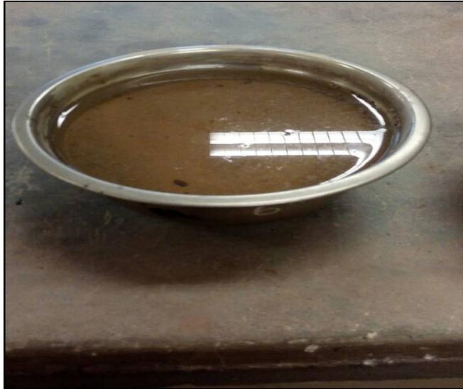
*Figura 27.* Saturación del agregado fino
