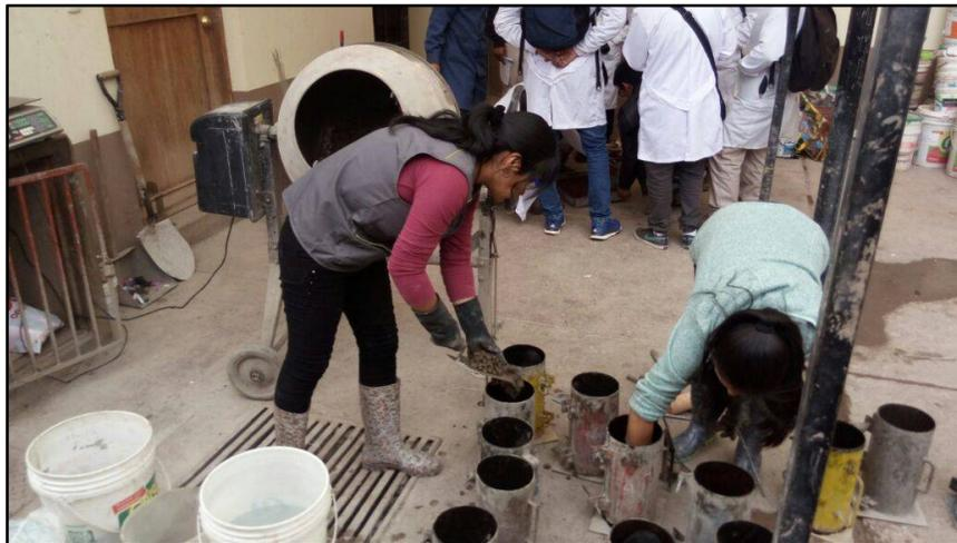
**Figura 41.** Elaboración de probetas cilíndricas de concreto
