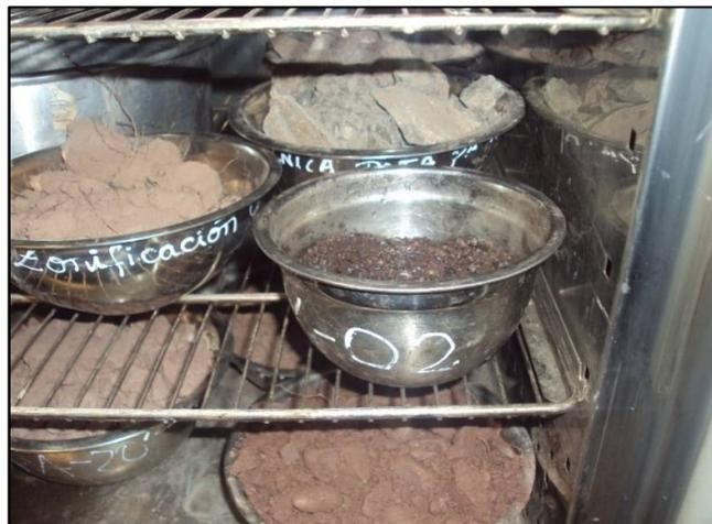
**Figura 39.** Secado del agregado grueso en el horno
