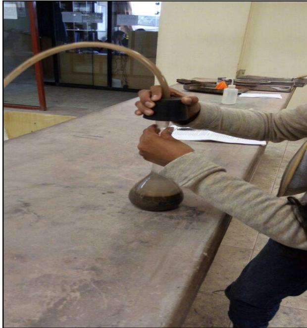
**Figura 31.** Eliminación del aire usando la bomba de vacíos.
