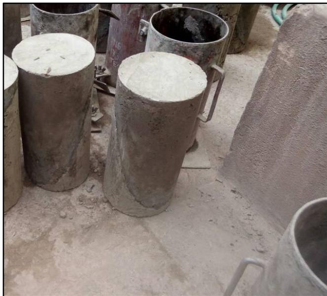
**Figura 48:** Briquetas de concreto de diferentes edades unidas con puente de adherencia
