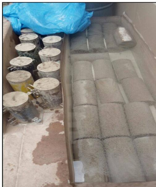
**Figura 44:** Curado del concreto en poza.
