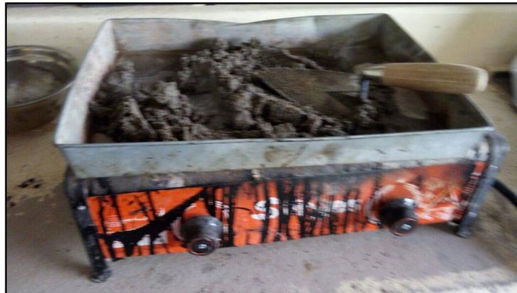
*Figura 28.* Secado del agregado fino – peso específico.
