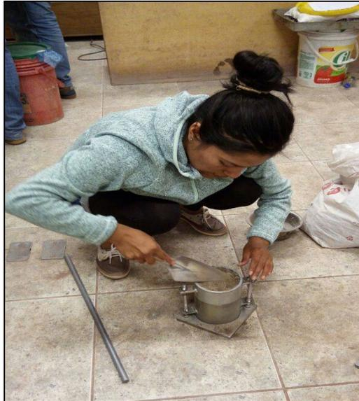
*Figura 37.* Compactación del agregado grueso.
