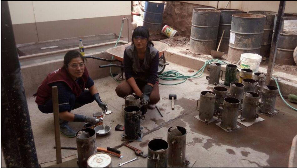
**Figura 47.** Preparación del epóxico y colocación a las briquetas de concreto antiguo
