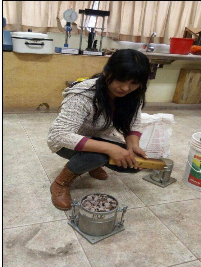
*Figura 35.* Compactación del agregado grueso.
