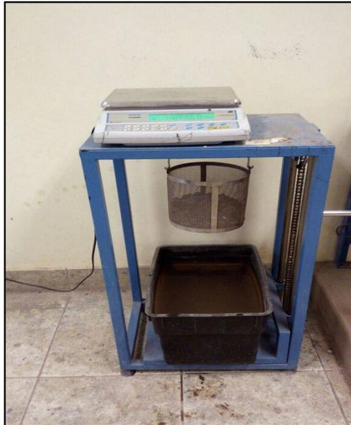
*Figura 34.* Eliminación de la película de agua del agregado grueso.
