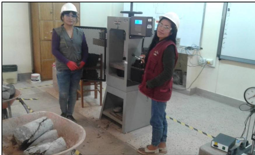
*Figura 51.:* Ensayo de compresión uniaxial
