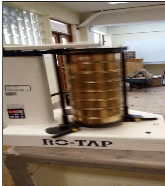
*Figura 25.* Tamizado mecánico del agregado grueso.
