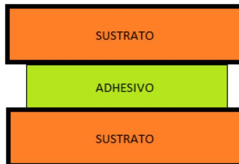
**Figura 3.** Esquema de una unión adhesiva
