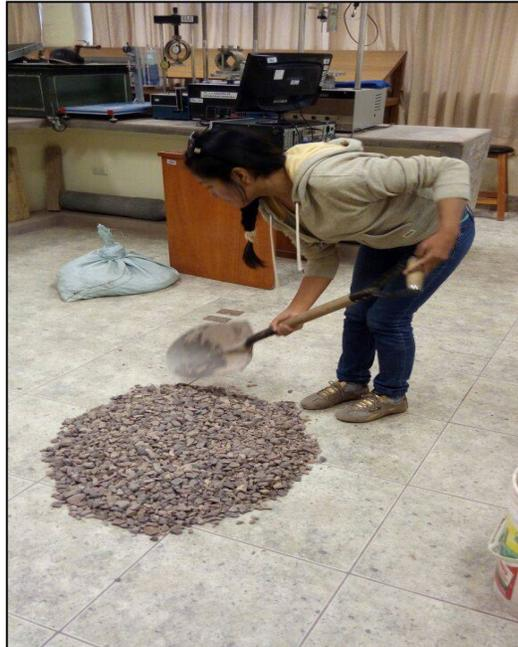
*Figura 20.* Cuarteo – división del agregado en 04 partes.
