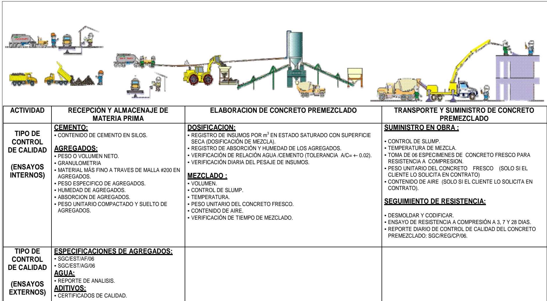
Figura 15 Propuesta de Diagrama de Flujo en la elaboración de concreto Premezclado
