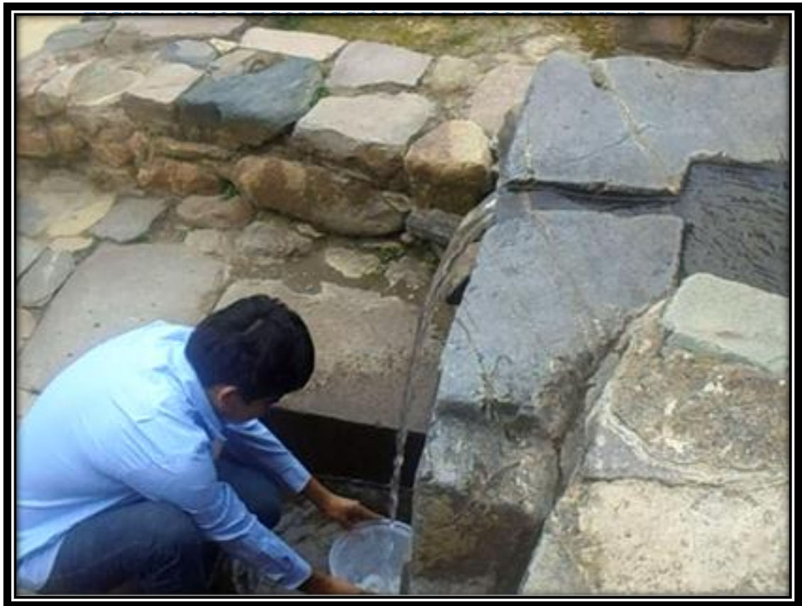
FIGURA N° 24 TOMA DE CAUDAL
