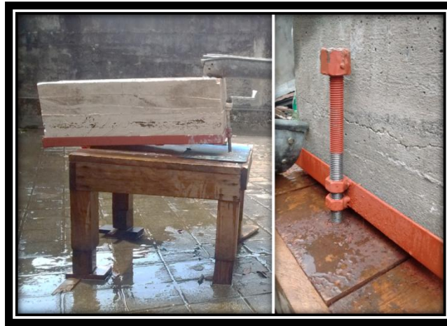
FIGURA N° 39 TUERCAS METÁLICAS EN LA MESA REGULADORA DE PENDIENTE
