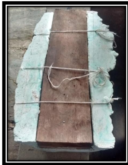
FIGURA N° 77 PIEZA DE MADERA EN CANAL DE SALIDA DE SILICONA
