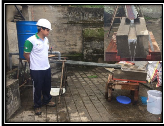
FIGURA N° 49 DISPOSITIVO REGULADOR DE CAUDAL EN FUNCIONAMIENTO PARA EL MODELO DE CONCRETO
