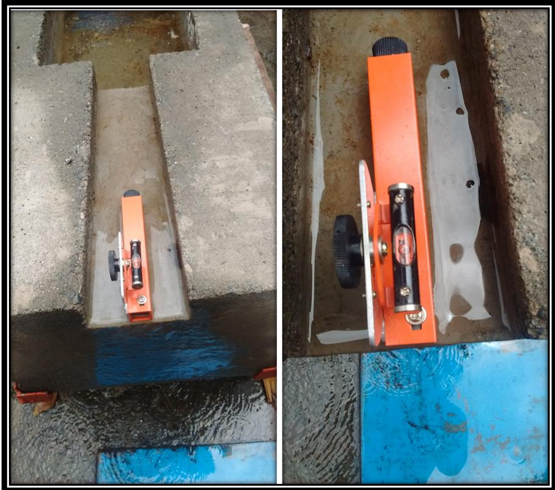
FIGURA N° 48 MEDICIÓN DE PENDIENTE DEL MODELO DE CONCRETO
