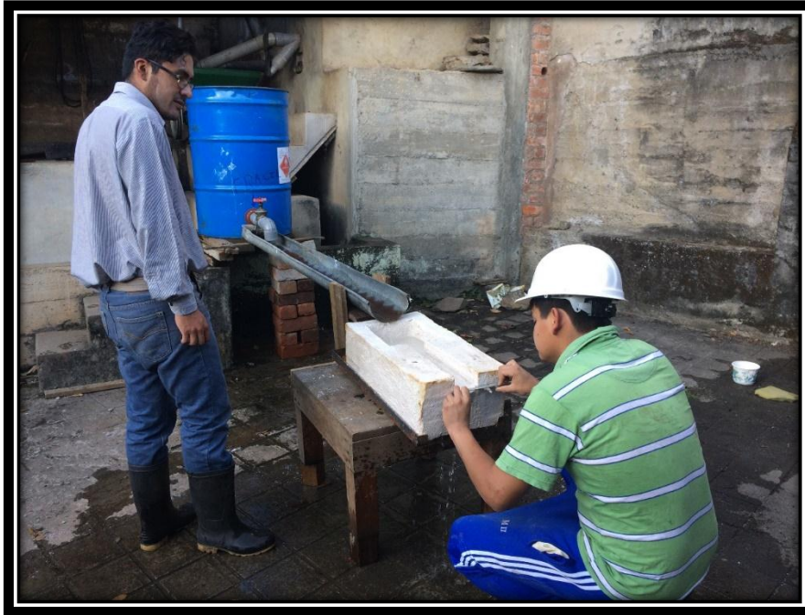
FIGURA N° 64 NIVELACIÓN DEL MODELO DE YESO
