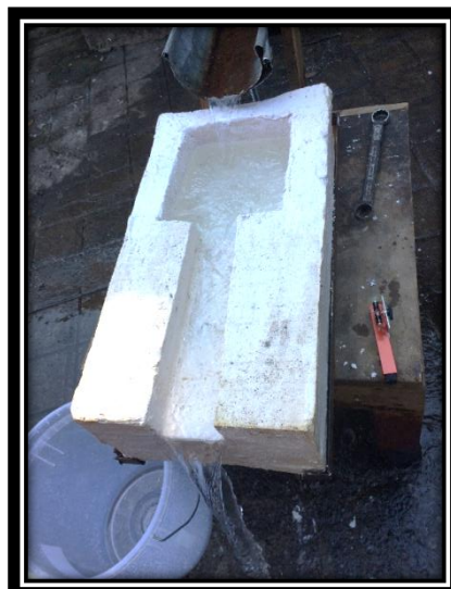
FIGURA N° 65 MODELO DE YESO EN 1^\circ DE PENDIENTE
