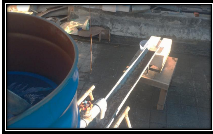
FIGURA N° 86 DISPOSITIVO REGULADOR DE CAUDAL Y MODELO DE YESO CON LA MITAD DE LA LONGITUD CARACTERÍSTICA
