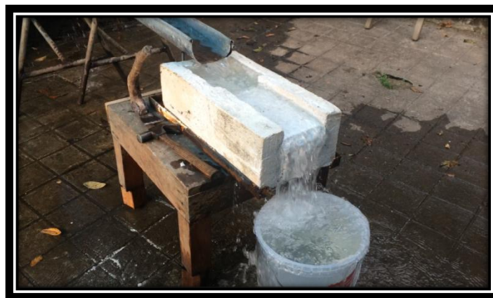
FIGURA N° 92 DISPOSITIVO REGULADOR DE CAUDAL EN FUNCIONAMIENTO Y MODELO DE YESO CON EL DOBLE DE LA LONGITUD CARACTERÍSTICA
