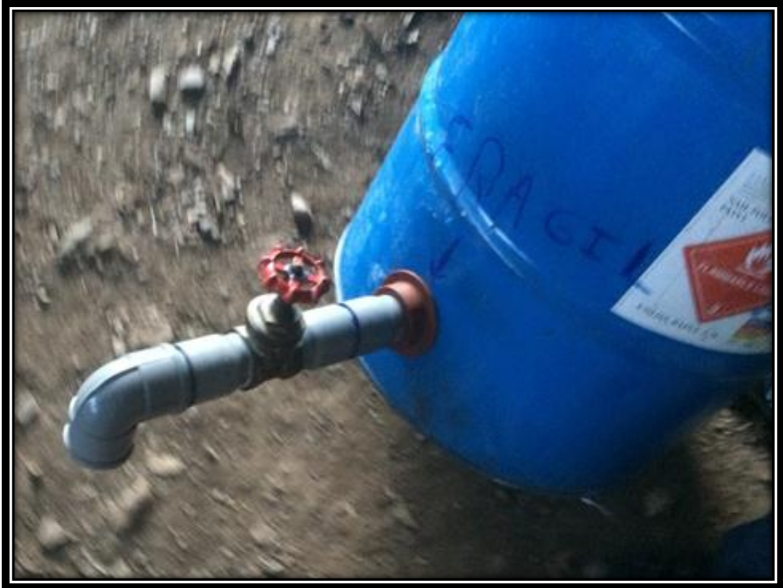
FIGURA N° 36 CILINDRO CON ADAPTADORES Y VÁLVULA DE COMPUERTA
