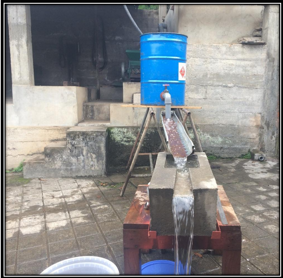
FIGURA N° 47 RÉPLICA DE CONCRETO EN LA MESA REGULADORA DE PENDIENTE
