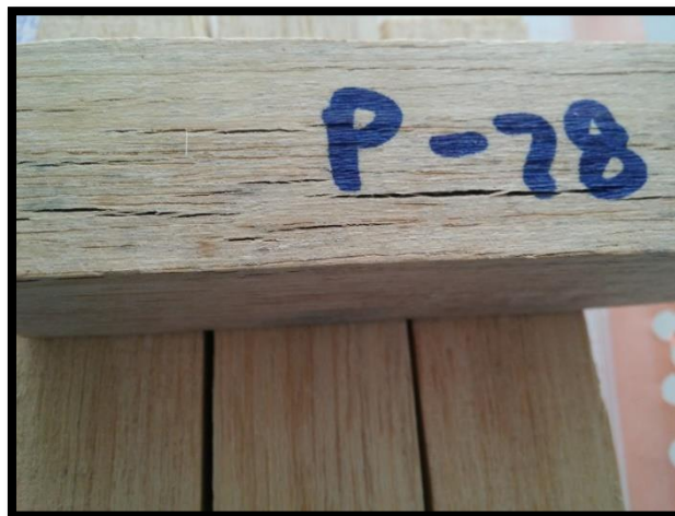
Figura N° 48 Fallas en el ensayo de densidad.
