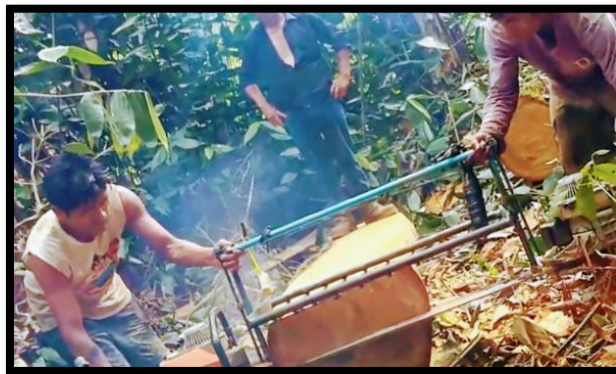
Figura N° 38 Corte del tronco en viguetas.
