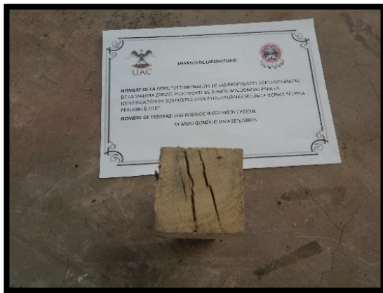
Figura N° 65 Fallas por compresión axial.
