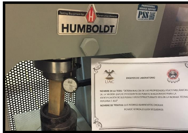
Figura N° 63 Deformímetro en la máquina de compresión
