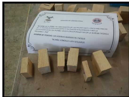
Figura N° 57 Fallas por cizallamiento 2.
