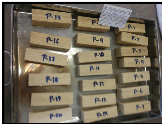
Figura N° 45 Probetas en una bandeja para ponerlas al horno.
