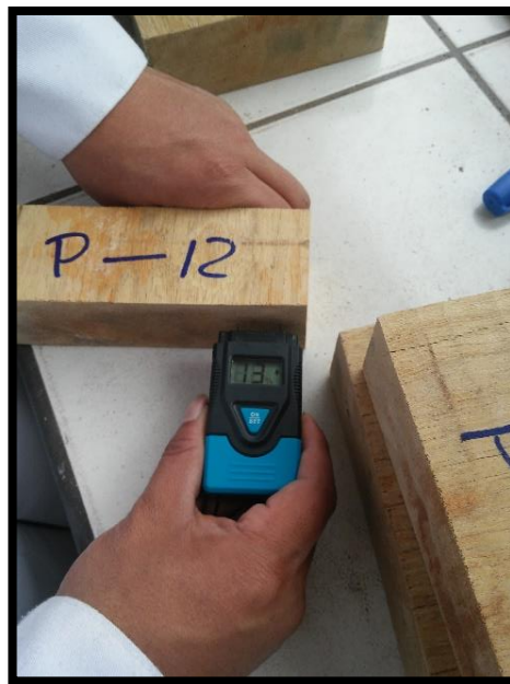
Figura N° 70 Midiendo el contenido de humedad con higrómetro.
