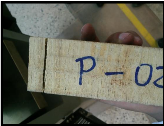
Figura N° 77 Falla por compresión 1.
