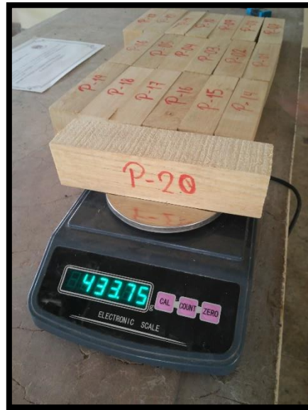
Figura N° 60 Pesando probetas de ensayo de compresión paralela al grano.
