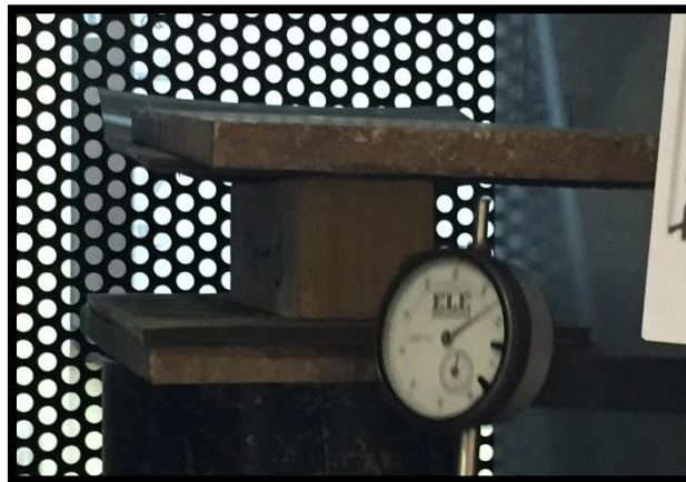
Figura N° 75 Colocación del deformímetro.
