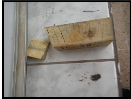
Figura N° 78 Falla por compresión 2.
