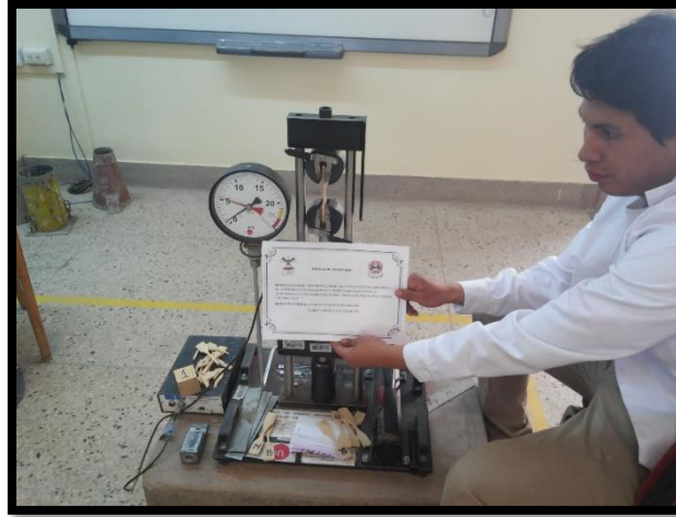
Figura N° 88 Ensayo de tensión paralela a las fibras.
