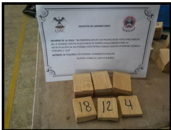
Figura N° 56 Fallas por cizallamiento 1.
