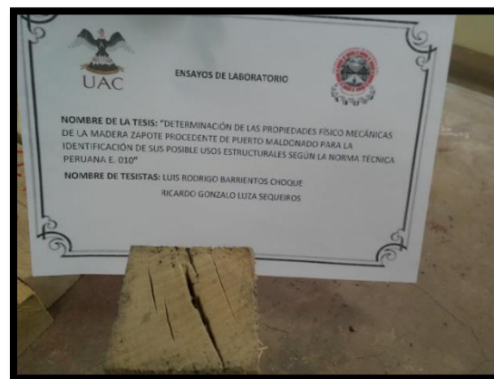
Figura N° 66 Fallas por compresión axial2.
