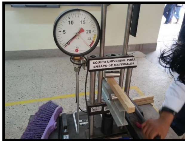
Figura N° 82 Colocación de la probeta en la maquina universal.
