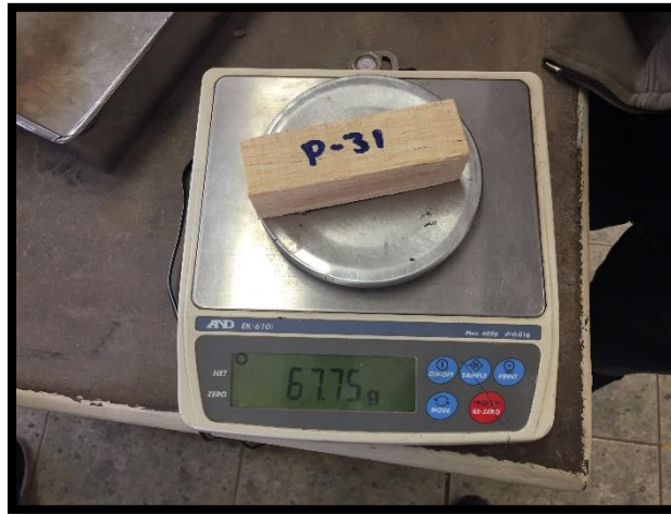
Figura N° 40 Pesando probetas para ensayo de contenido de humedad.
