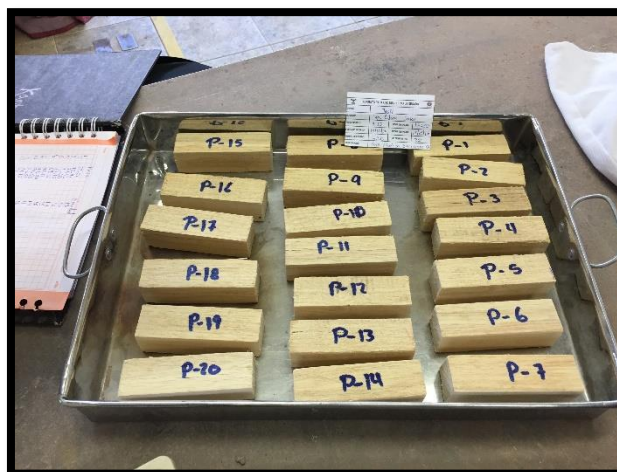
Figura N° 41 Probetas sacadas del horno.
