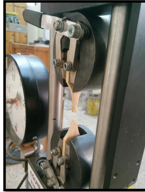
Figura N° 90 Falla por tracción.
