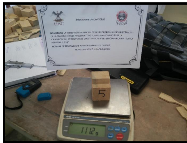
Figura N° 50 Pesando probetas de ensayo de cizallamiento paralelo al grano.
