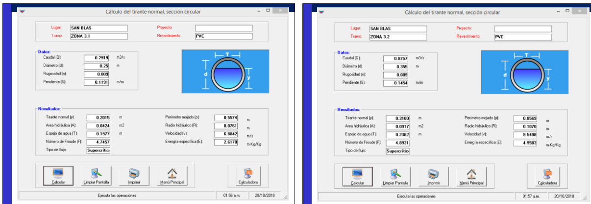
Figura 133. Cálculo de propuesta de diseño de los tramos 3-1 y 3-2.
