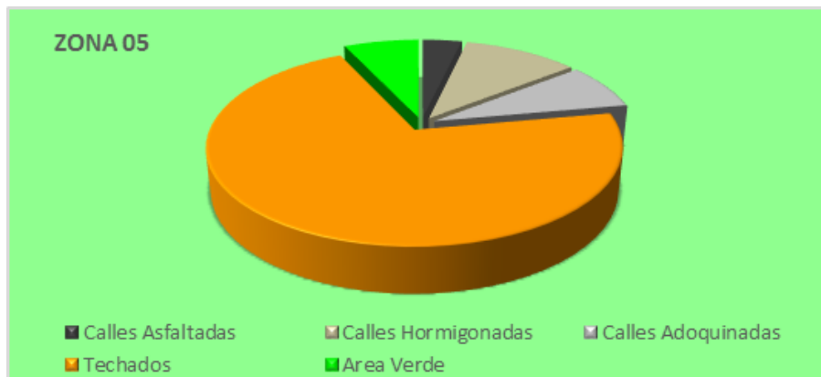
Figura 108. Coeficiente de Escorrentía en la Zona 5.
