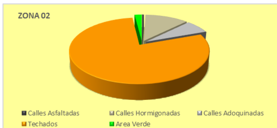
Figura 105. Coeficiente de Escorrentía en la Zona 2.
