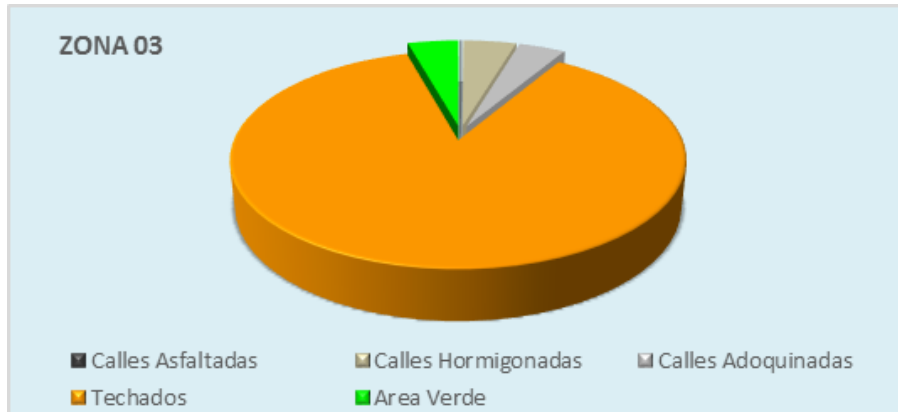
Figura 106. Coeficiente de Escorrentía en la Zona 3.
