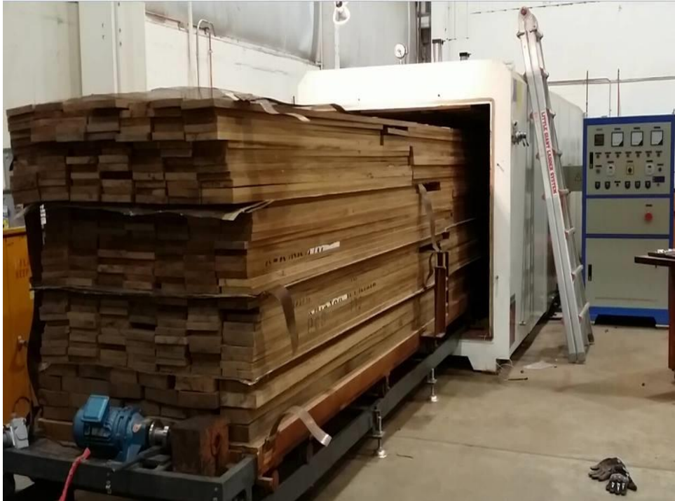
Figura 3. Secado al Horno de Maderas en el Reaserradero Kiba
