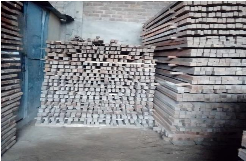
Figura 2. Secado Natural de Madera en el Reaserradero Kiba Fuente Empresa
