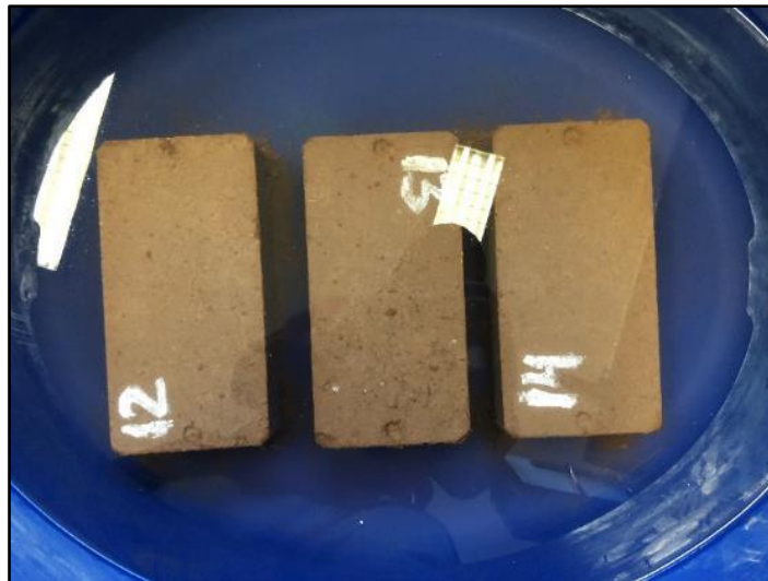
Figura 33: Unidades de albañilería sumergidas en agua potable durante 24 horas
