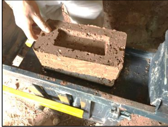
Figura 21: Ladrillo resultado de la compactación con la máquina FORZA
