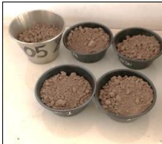
Figura 22: Material suelo extraído de la unidad de albañilería para hallar su humedad natural
