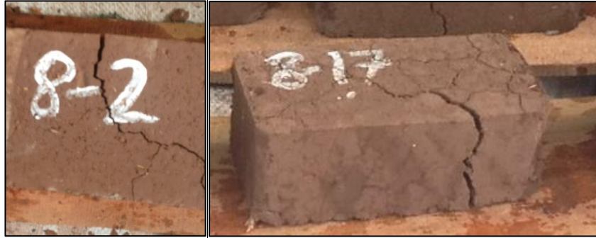
Figura 88: Grietas de gran tamaño en las unidades de albañilería elaboradas con el suelo de Wimpillay, distrito de San Sebastián
