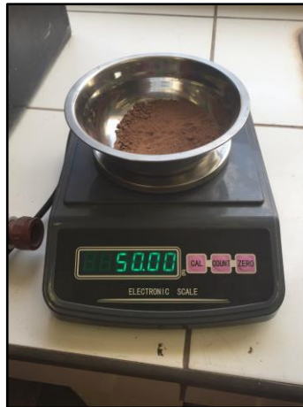
Figura 12: Pesado del material retenido en el ensayo de granulometría
