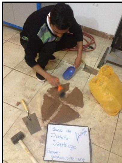
Figura 11: Proceso de desmenuzamiento de terrones de tierra para análisis granulométrico
