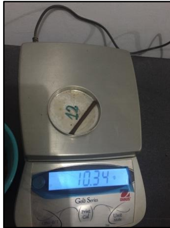
Figura 17: Muestra de ensayo de límite plástico siendo pesado antes de ser llevado a horno
