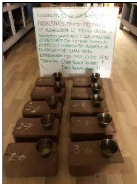
Figura 27: Extracción de tierra de las unidades de albañilería ensayadas
