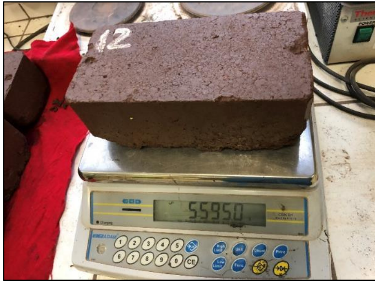
Figura 34: Proceso de registro del peso de la unidad después de ser sumergida en agua durante 24 horas
