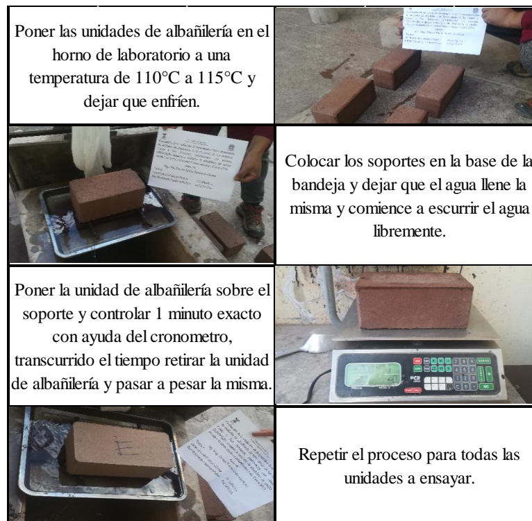
Figura N° 24: Procedimiento para realizar el ensayo de Succión.
