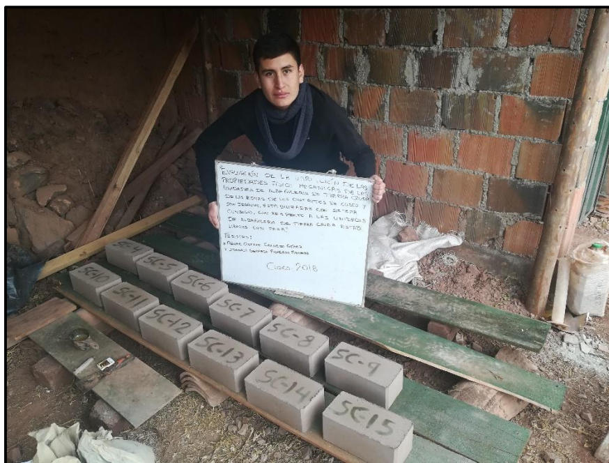
“Comportamiento físico-mecánico de unidades de albañilería de tierra cruda fabricadas con suelo de los sectores Tumbayoc y Cusipata, Perú – San Jerónimo, estabilizadas con sistema CONSOLID, Cusco 2018”
