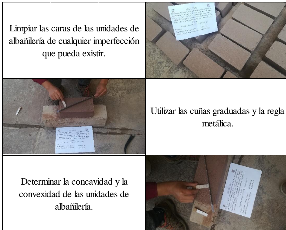
Figura N° 22: Procedimiento para realizar el ensayo de Alabeo.
