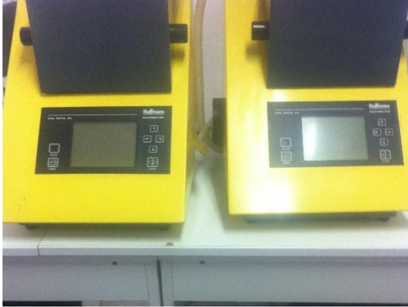
Turbidimetro H90 mide la turbidez del agua en un haz de 90 grados describiendo presencia de solidos no visibles por el ojo humano
