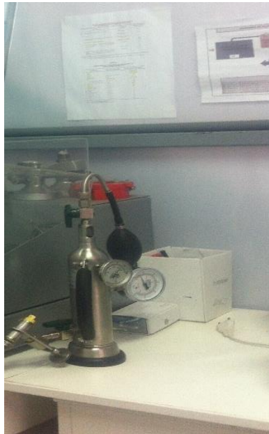
Medidor de porcentaje de CO2 en el agua gasificada, en función a la presión y temperatura de la muestra de agua.
