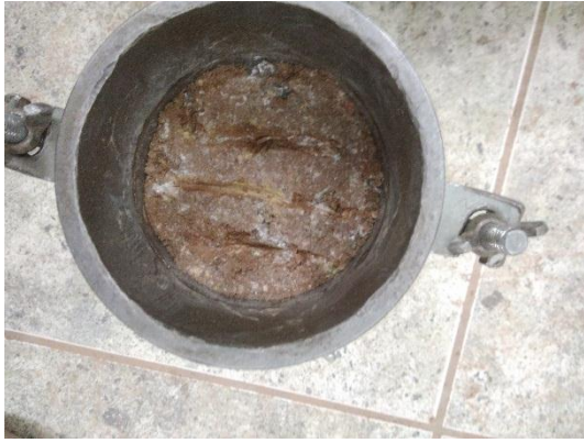
Fotografía 43: Escarificado durante la compactación, para una adecuada adherencia entre capas
