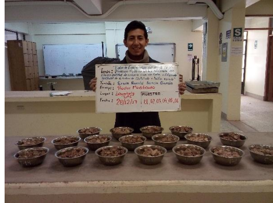
Fotografía 50: Muestras para determinar el contenido de humedad de los ensayos de Proctor Modificado
