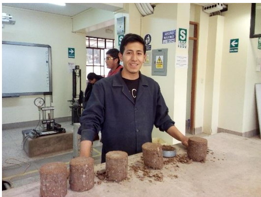
Fotografía 47: Testigos de suelo cemento sometidos a compresión para el análisis de sensibilidad por humedad y densidad de compactación
