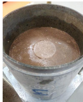
Fotografía 60: Mínima penetración en espécimen de suelo cemento (55 golpes)
