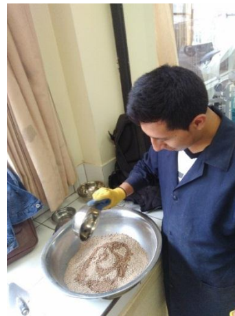
Fotografía 24: Incorporación de agua a la mezcla de material fino y cemento
