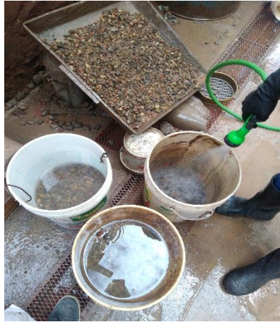
Figura 41 – Lavado y saturado del agregado pasante el tamiz de \frac{3}{4} " y retenido en el tamiz N°4
