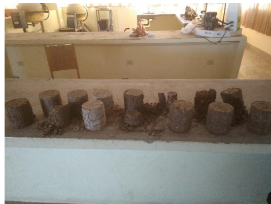
Fotografía 48: Testigos de suelo cemento sometidos a compresión para el análisis de sensibilidad por humedad y densidad de compactación
