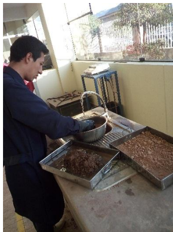
Fotografía 15: Lavado del suelo previo al tamizado
