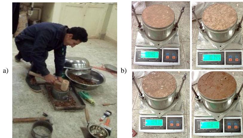
Figura 40 – a) Rellenado, con material fino, luego del enrasado del espécimen compactado y b) Pesado de cada espécimen compactado de la muestra PM – 03
