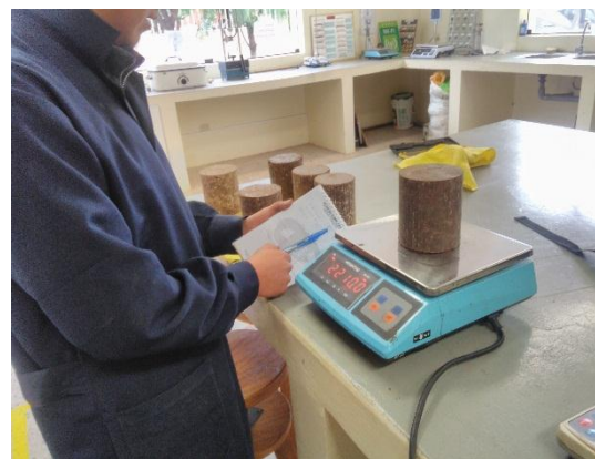
Fotografía 66: Pesado de testigos de suelo cemento, previo a la propagación de ondas
