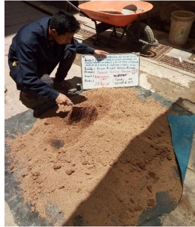
Fotografía 20: Secado del material fino
