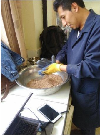
Fotografía 25: Distribución uniforme de la humedad
