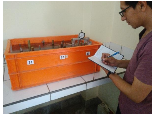
Fotografía 58: Lectura de expansiones de especímenes para ensayo de CBR de suelo cemento
