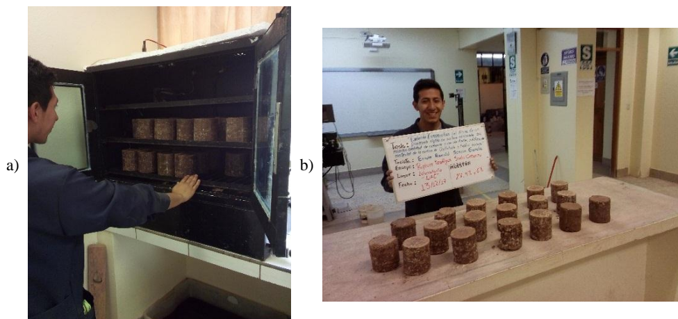
Figura 48 – a) Curado de testigos de suelo-cemento y b) Testigos de suelo-cemento con 2%, 4% y 6% de cemento ensayados a compresión.
