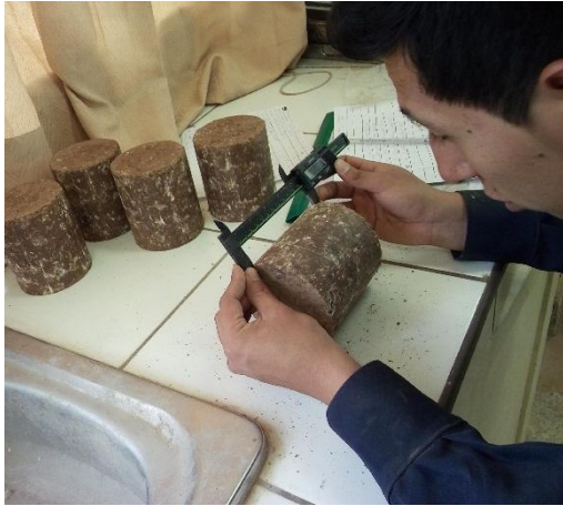
Fotografía 37: Toma de medidas de testigos de suelo cemento
