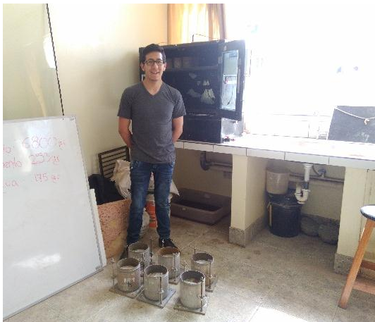
Fotografía 57: Retirado de especímenes de la cámara húmeda para ensayo de CBR de suelo cemento
