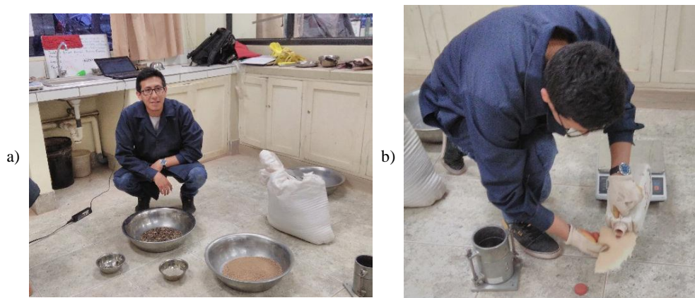
Figura 49 – a) Materiales utilizados en la elaboración de testigos de suelo-cemento (agregado grueso en estado saturado superficialmente seco, material fino secado al aire, cemento y agua) y b) Engrasado del molde antes de la compactación para facilitar la extracción del testigo
