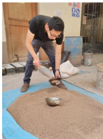
Figura 42 – Toma de muestras de material fino secado al aire para determinar su contenido de humedad higroscópica
