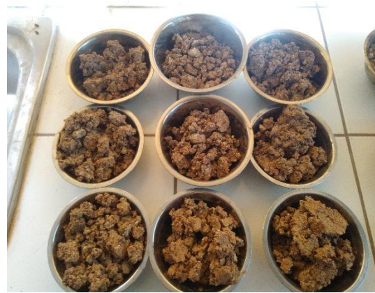
Fotografía 64: Muestras de contenido de humedad de la zona alrededor del área de penetración de los ensayos de CBR suelo natural
