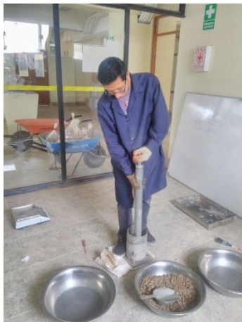
Fotografía 53: Compactado de espécimen para ensayo de CBR de suelo cemento
