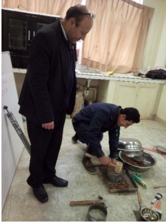
Fotografía 49: Asesoramiento, por parte del asesor, del adecuado compactado en el ensayo Proctor Modificado
