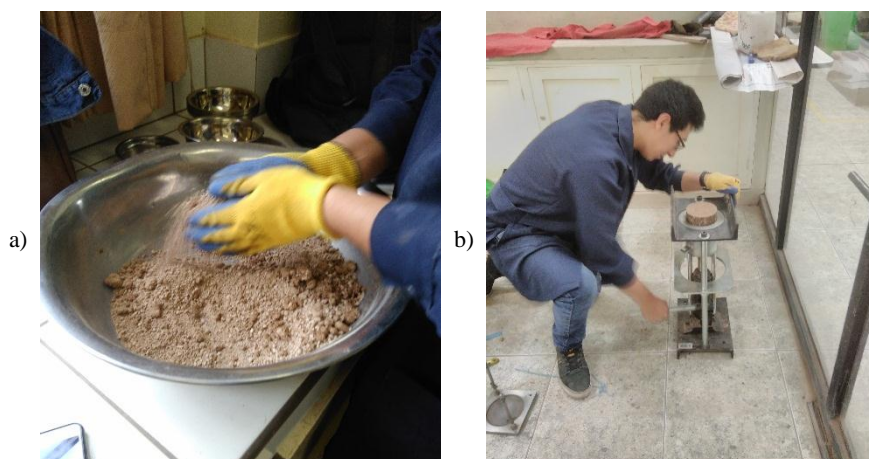
Figura 47 – a) Mezclado enérgico para una homogenizar y distribuir de manera adecuada la humedad en la mezcla y b) Extracción del testigo elaborado.
