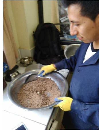
Fotografía 26: Incorporación del agregado a la mezcla de material fino, cemento y agua
