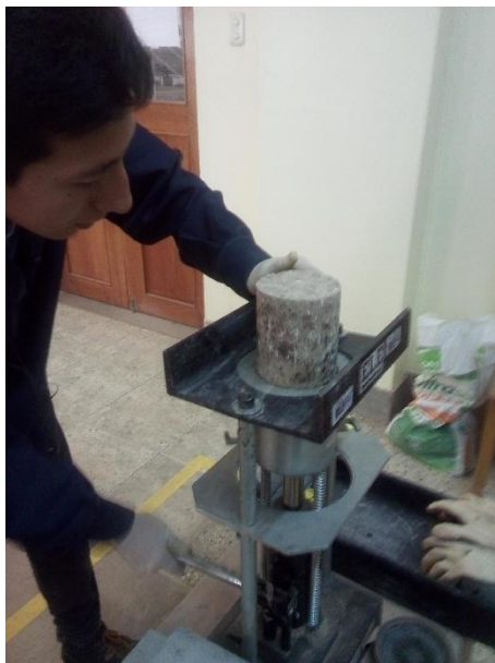
Fotografía 29: Extracción de la muestra, ensayo Relación humedad-densidad (suelo cemento)
