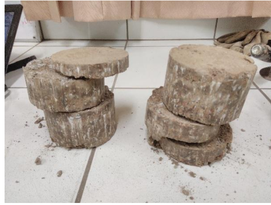
Fotografía 44: Rotura de testigos por no presentar escarificación
