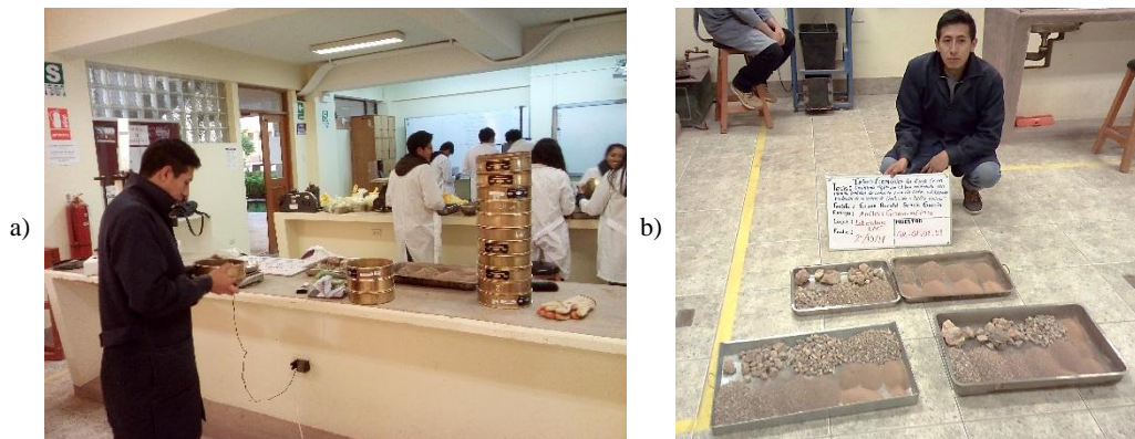
Figura 37 – a) Tamizado manual de la muestra y b) Porciones de las muestras retenidas en el tamizado
