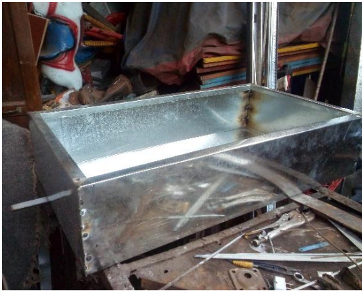
Fotografía 1: Construcción del espacio que almacenará el agua (Cámara Húmeda)
