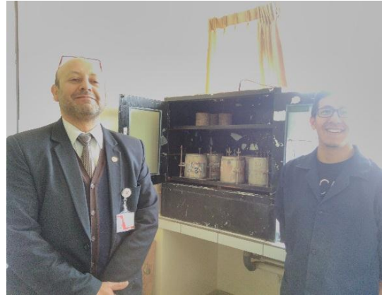
Fotografía 56: Verificación, por parte del asesor, del adecuado curado de especímenes para ensayo de CBR de suelo cemento
