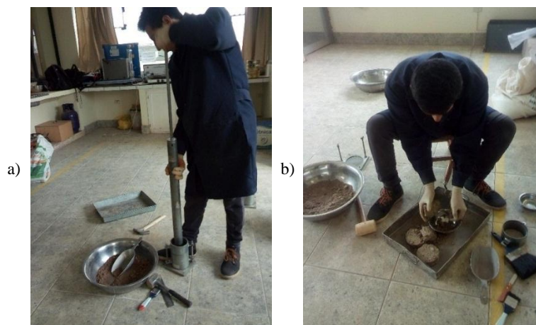
Figura 44 – a) Compactado del espécimen con energía equivalente a la de Proctor Modificado y b) Extracción de porción de suelo compactado para determinar el contenido de humedad
