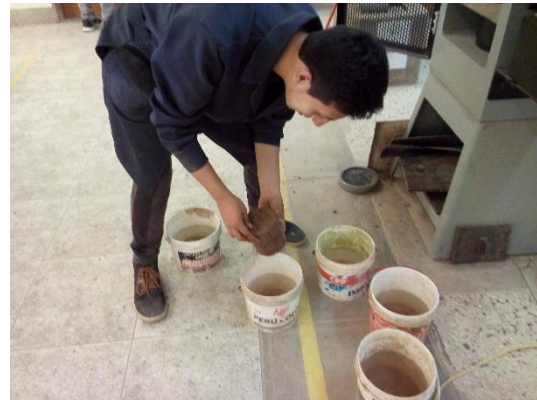
Fotografía 40: Retirado de testigo de suelo cemento del agua, para ser ensayado a compresión
