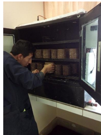
Fotografía 36: Retirado de testigo de suelo cemento de la cámara húmeda, para ensayo de resistencia a la compresión
