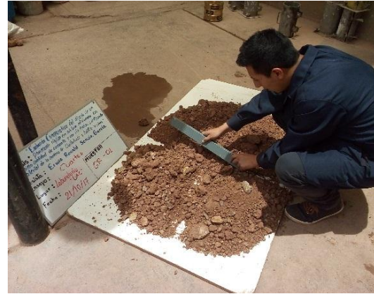
Fotografía 14: Cuarte previo al análisis granulométrico
