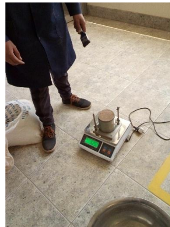
Fotografía 28: Pesado del espécimen compactado
