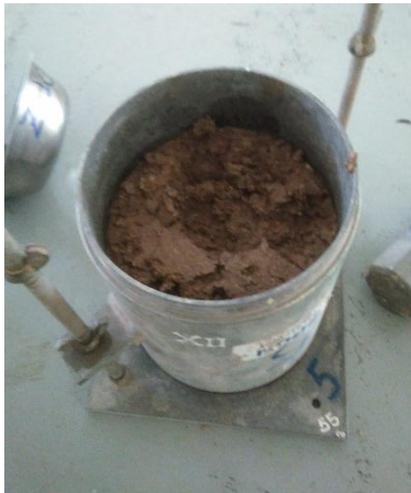
Fotografía 63: Especímen de CBR de suelo natural luego de la penetración
