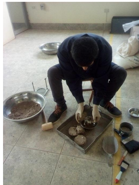
Fotografía 30: Extracción de muestra de mezcla compactada para determinar el contenido de humedad
