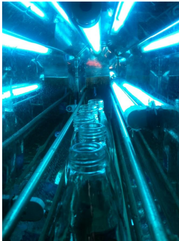
Figura 38. Contacto de lámparas UV-C con botellas de vidrio.
