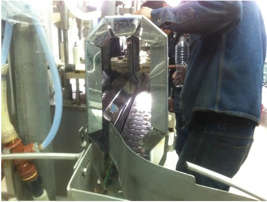
Figura 27. Acoplamiento a la faja transportadora.
