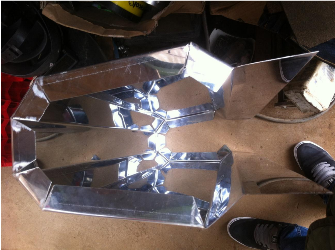
Figura 22. Cámara de Radiación para Botellas.
