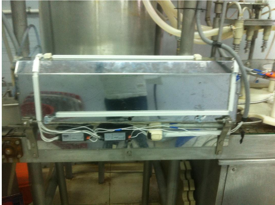
Figura 32. Conexión a Balastos UV-C.
