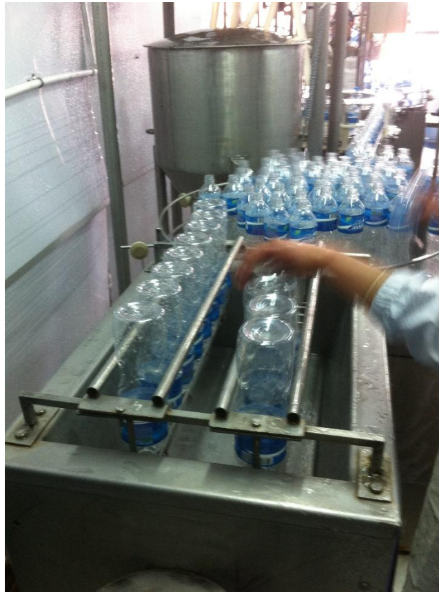
Figura 14. Posicionamiento de botellas en el lavado.
