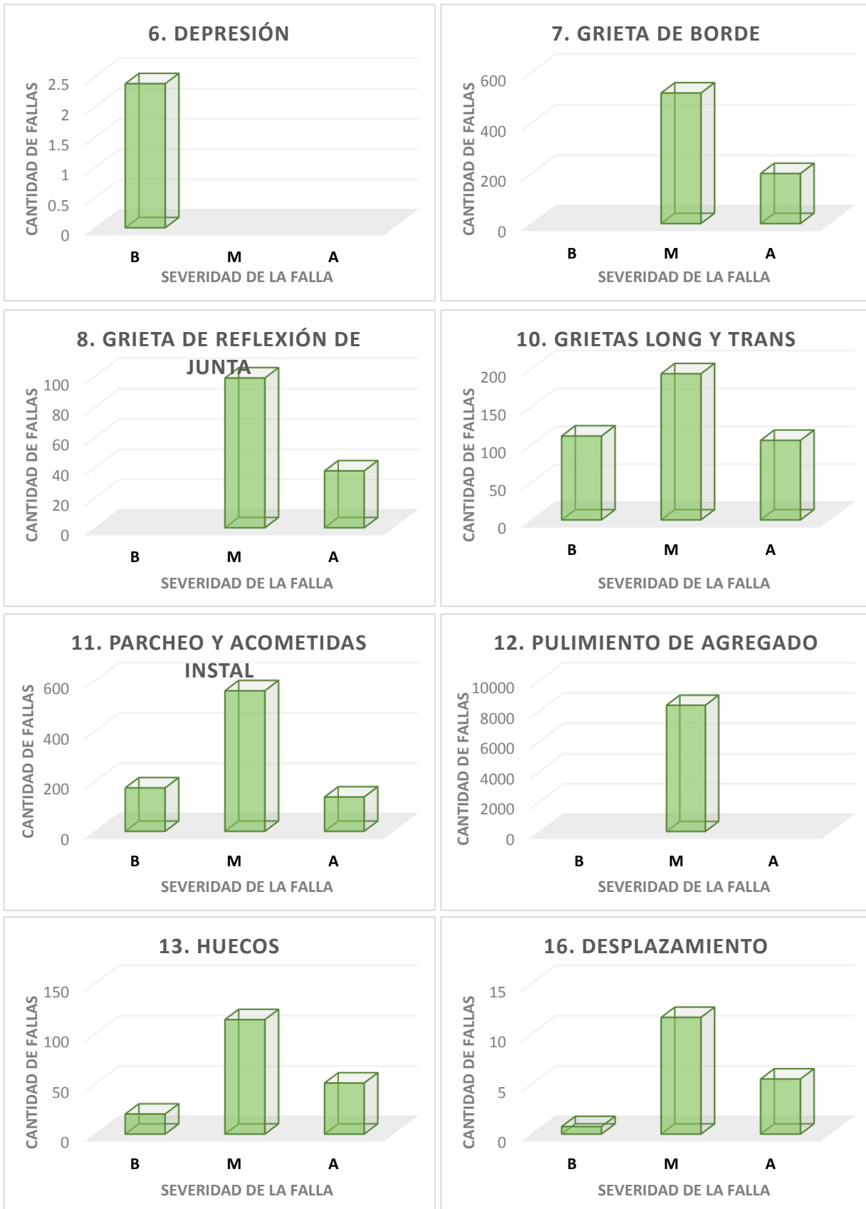
Figura 172: Severidad de las Fallas de Pavimento Flexible 6,7,8,10,11,12,13 y 16 por áreas.
