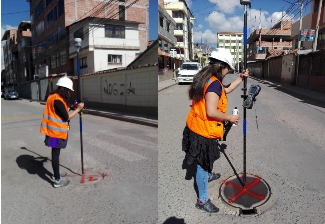
Figura 47: Levantamiento de Puntos de Control con GPS diferencial
