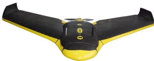
Figura 23: UAV O DRONE con ala fija
