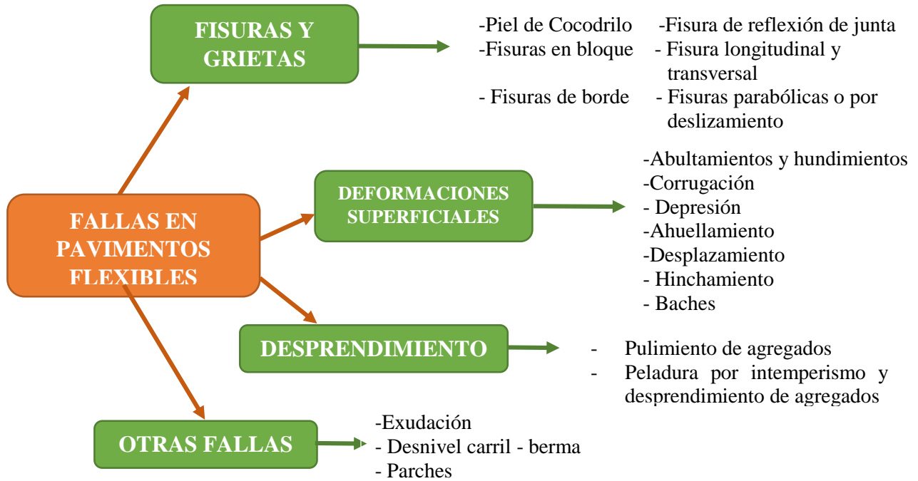
Figura 7: Fallas en Pavimentos Flexibles
