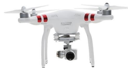
Figura 24: UAV O DRONE con ala rotatoria
