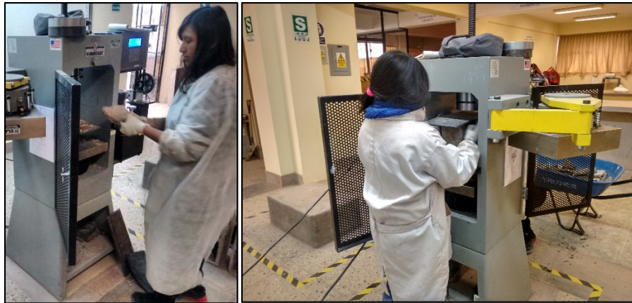
Figura 28: Ensayo de resistencia a compresión al bloque de concreto con los implementos de seguridad requeridos.
