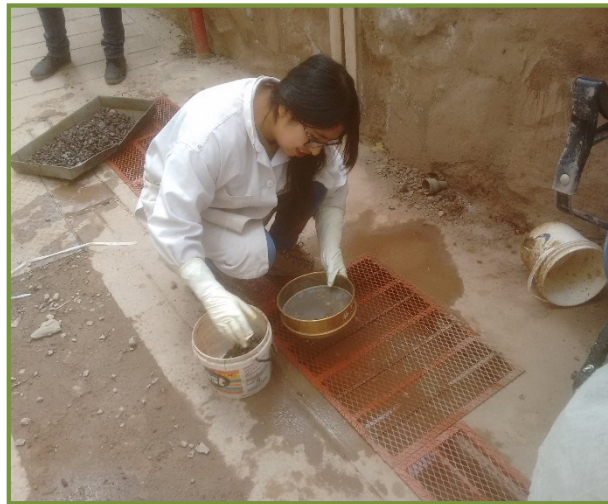
Figura 17: Lavado del agregado fino por el tamiz #200
