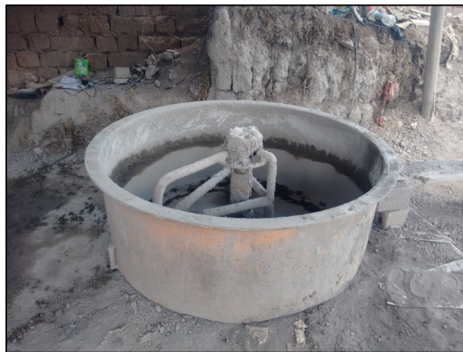
Figura 24: Mezcladora mecánica empleada en fábricas de bloques de concreto
