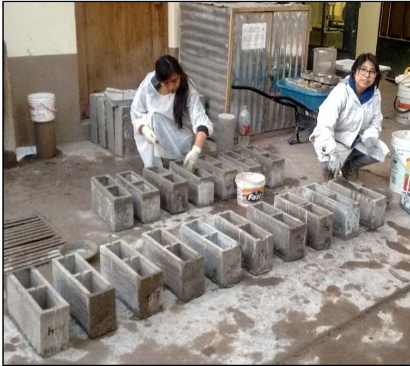
Figura 25: Colocado de refrentado o capping
