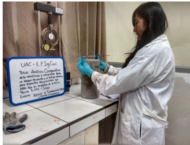
Figura 29: Toma de medidas a el testigo cilíndrico
