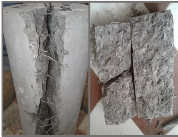
FIGURA 118: Matriz de concreto adicionado con fibras de alambre galvanizado en forma rectilíneas
