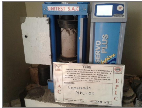
FIGURA 112: Muestra sometida al ensayo de compresión
