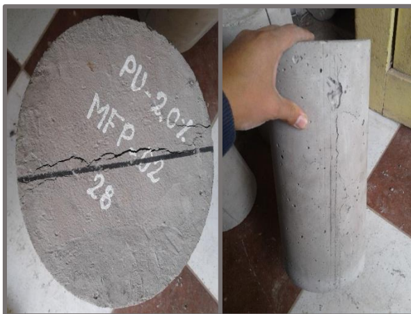
FIGURA 117: Fallas de las muestras con fibras rectilíneas al ser sometida al ensayo de tracción indirecta
