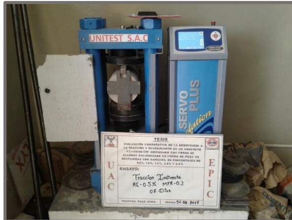
FIGURA 113: Muestra sometida al ensayo de tracción indirecta
