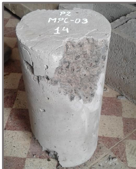
FIGURA 114: Muestra después de ser sometida al ensayo de compresión
