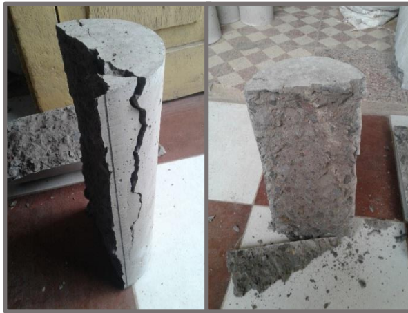
FIGURA 115: Muestra después de ser sometida al ensayo de tracción indirecta
