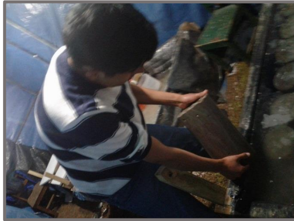
FIGURA 109: Colocación de las muestras en los pozos de curado
