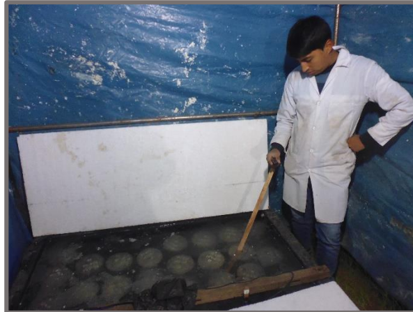
FIGURA 110: Verificación de la temperatura en los pozos de curado
