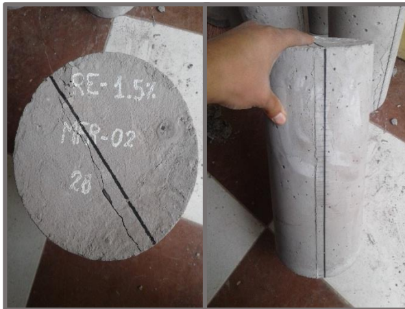
FIGURA 116: Fallas de las muestras con fibras rectilíneas al ser sometida al ensayo de tracción indirecta
