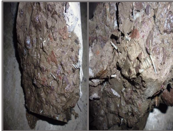
FIGURA 119: Matriz de concreto adicionado con fibras de alambre galvanizado en forma de púas
