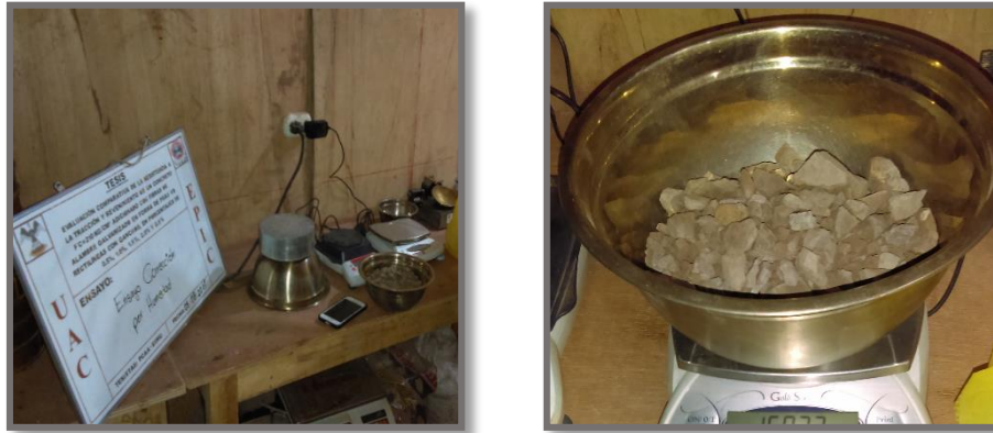
FIGURA 33: Determinación del peso húmedo de los agregados
