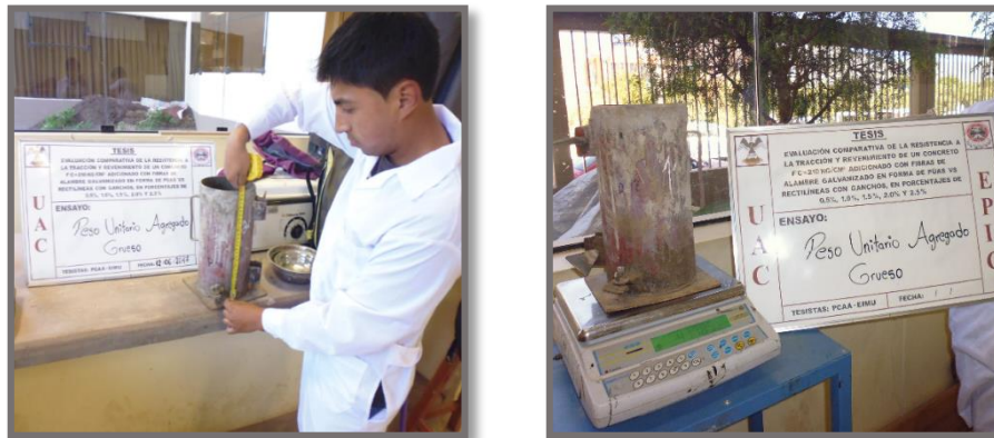
FIGURA 23: Determinación de las características del recipiente usado para el peso unitario
