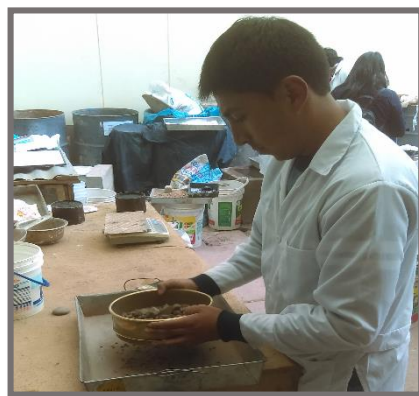
FIGURA 29: Tamizado y lavado del agregado grueso para determinar la gravedad específica
