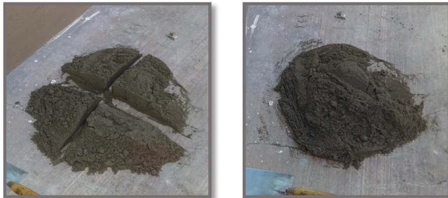
FIGURA 14: Método de cuarteo manual en agregado fino
