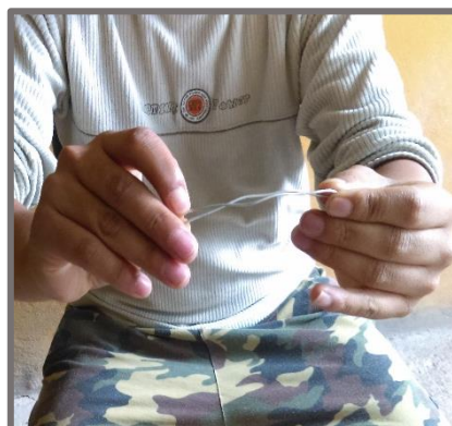
FIGURA 39: Desenrollado y enderezado del alambre galvanizado
