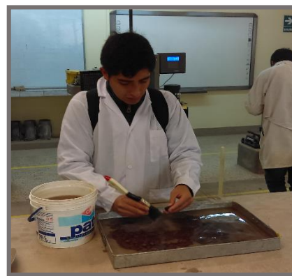
FIGURA 29: Tamizado y lavado del agregado grueso para determinar la gravedad específica
