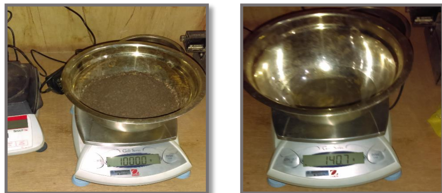
FIGURA 35: Determinación de los pesos después de realizar el secado
