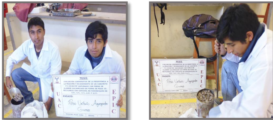
FIGURA 21: Relleno y apisonado de la muestra de agregado grueso
