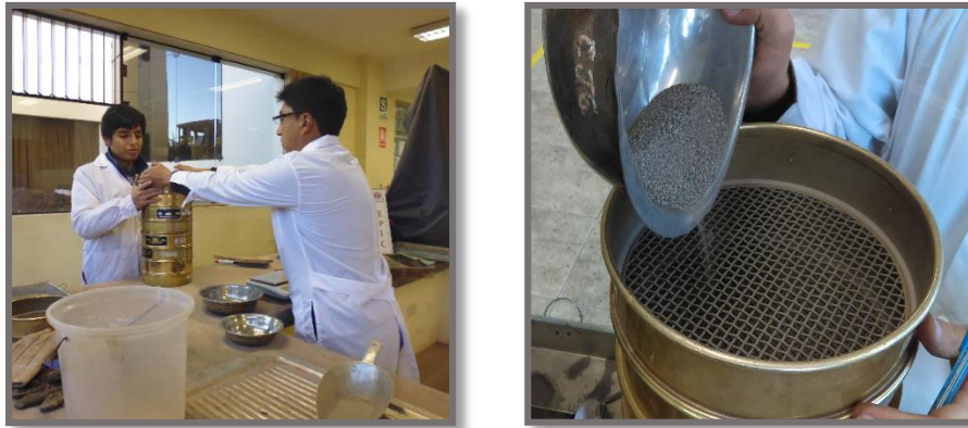
FIGURA 16: Selección de los tamices y colocación de la muestra
