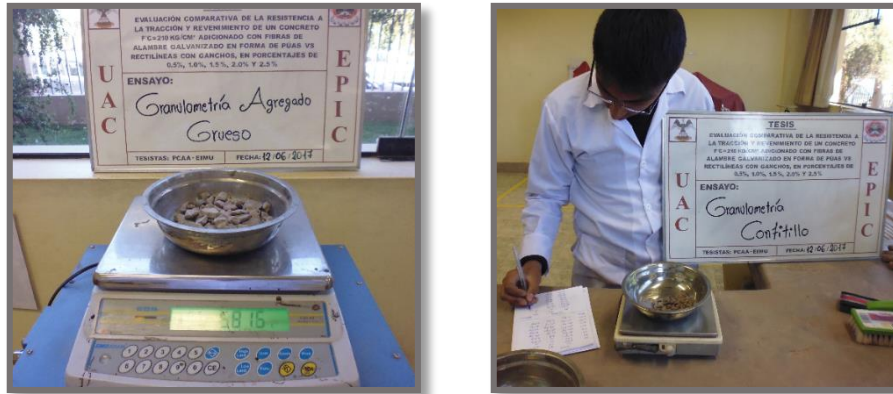
FIGURA 18: Determinación de los pesos retenidos en cada tamiz
