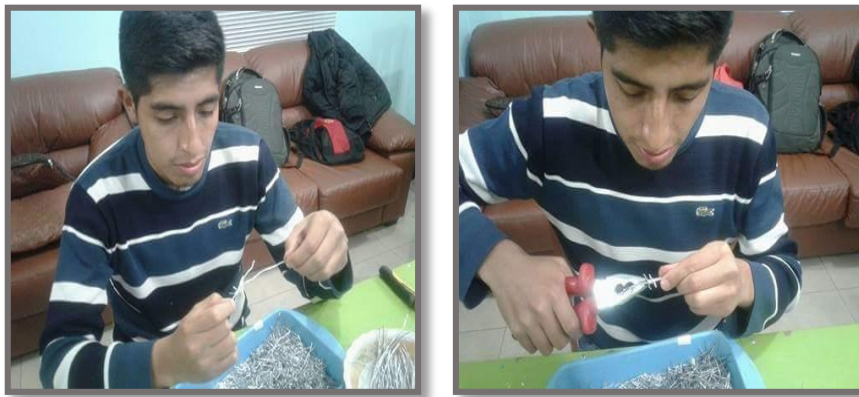
FIGURA 36: Corte manual de las púas de alambre galvanizado
