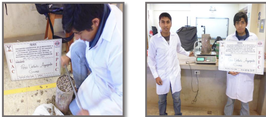
FIGURA 22: Enrasado para la determinación del peso de la muestra varillada
