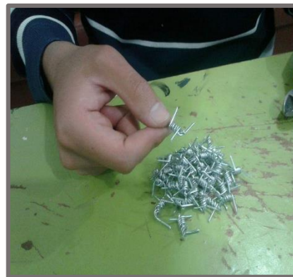
FIGURA 38: Corte final y obtención de las fibras en forma de púas
