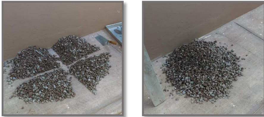
FIGURA 13: Método de cuarteo manual en agregado grueso
