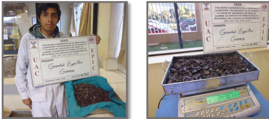
FIGURA 30: Secado para determinar el peso de la muestra superficialmente seca
