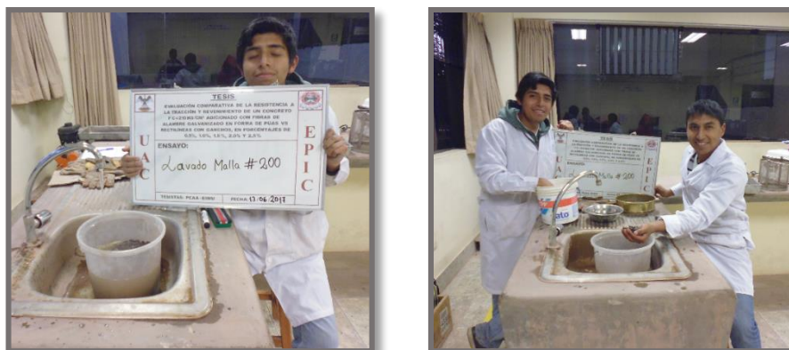
FIGURA 19: Lavado del agregado grueso por el tamiz n° 200
