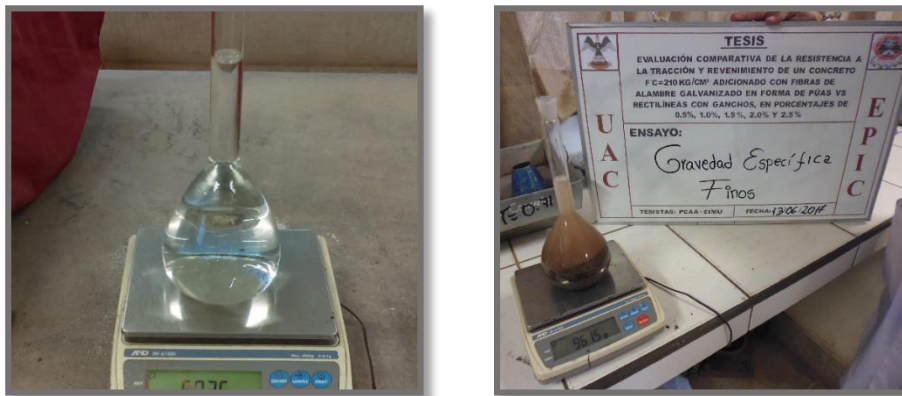
FIGURA 28: Determinación de los pesos necesarios para obtener la gravedad específica
