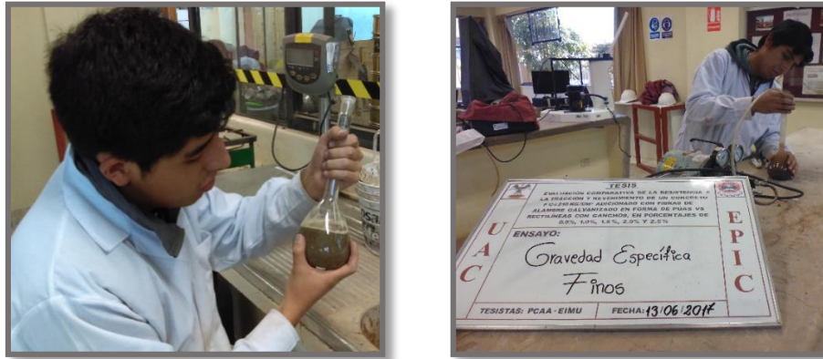
FIGURA 27: Eliminación de burbujas para determinar la gravedad específica
