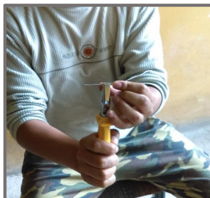
FIGURA 39: Desenrollado y enderezado del alambre galvanizado
