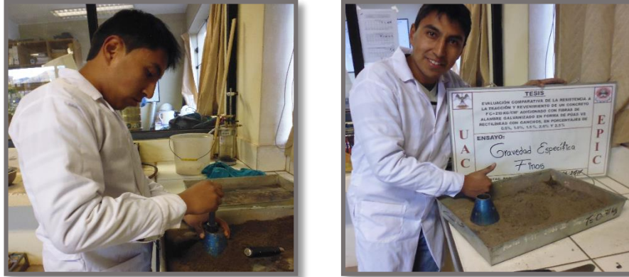
FIGURA 25: Verificación de la condición de superficie seca en el agregado fino
