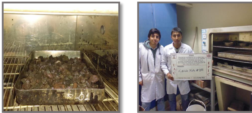
FIGURA 20: Secado de la muestra de agregado grueso después de ser lavada
