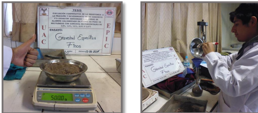
FIGURA 26: Colocación de la muestra de agregado fino dentro del frasco
