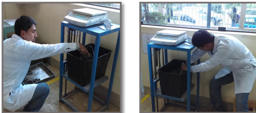
FIGURA 31: Colocación y remoción de aire atrapado al pesar la muestra de agregado grueso
