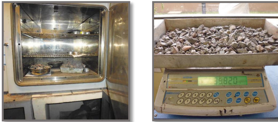
FIGURA 32: Secado de la muestra para posterior determinación del peso
