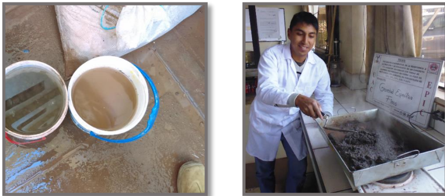
FIGURA 24: Preparación de la muestra de agregado fino para gravedad específica
