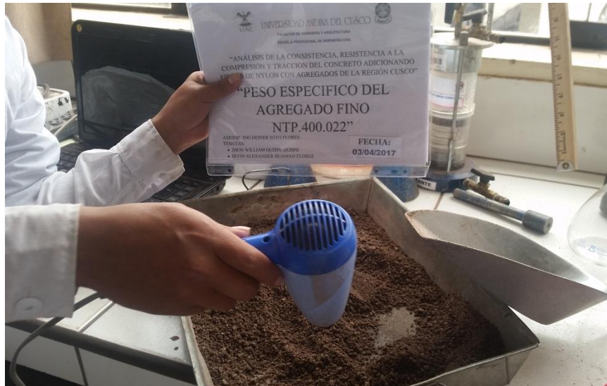
FIGURA N° 3.33: SECADO DE AGREGADO FINO EN COCINA.
