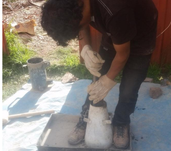
FIGURA N° 3.53: APISONADO EN EL CONO DE ABRAMS.
