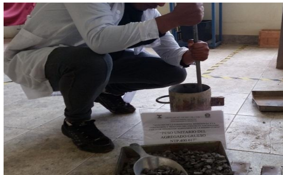
FIGURA N° 3.40: COMPACTACIÓN DEL AGREGADO GRUESO.
