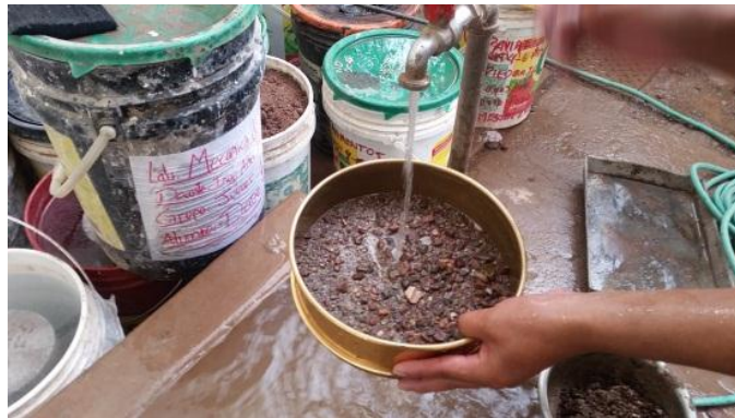
FIGURA N° 3.28: LAVADO DEL AGREGADO FINO.
