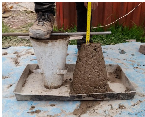
FIGURA N° 3.54: MEDICION DEL ASENTAMIENTO.
