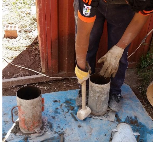
FIGURA N° 3.50: LLENADO DE CONCRETO EN BRIQUETERA.
