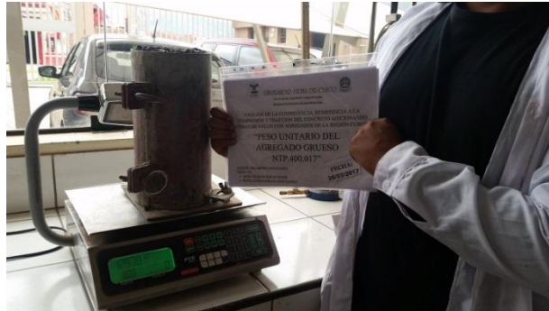
FIGURA N° 3.43: PESO DEL RECIPIENTE DE MEDIDA MÁS SU CONTENIDO.
