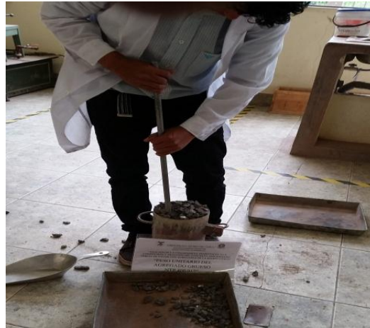
FIGURA N° 3.41: COMPACTADO DE MATERIAL-TERCERA CAPA.
