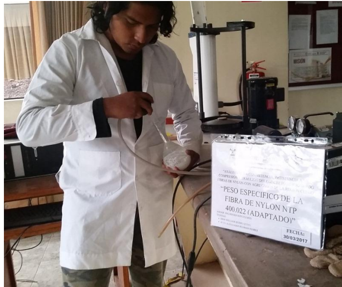
FIGURA N° 3.20: EXTRACCION DE AIRE ATRAVEZ DE LA BOMBA DE VACÍOS.
