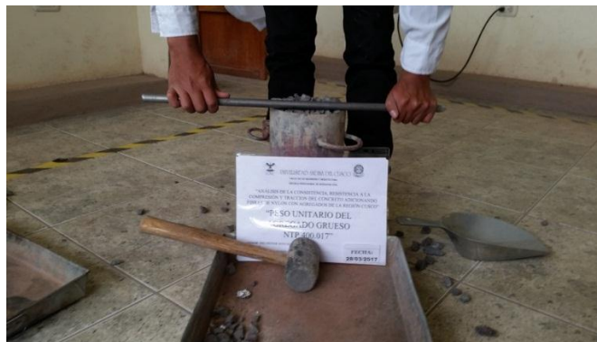
FIGURA N° 3.42: ELIMINACIÓN DEL AGREGADO EXCEDENTE
