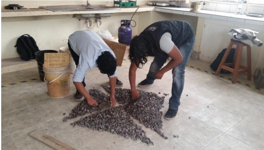
FIGURA N° 3.27: CUARTEO DE MUESTRA.
