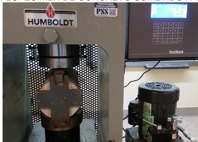
FIGURA N° 3.60: ESPÉCIMEN DE CONCRETO SOMETIDO A TRACCIÓN.
