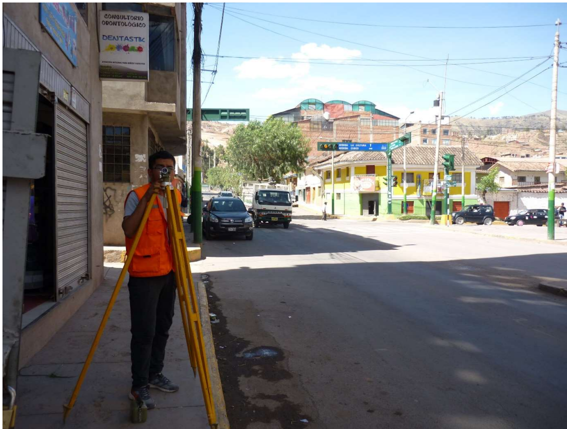
Figura N° 24 Nivel topográfico en la medición de la pendiente de Av. Tomas Tuyro Túpac
