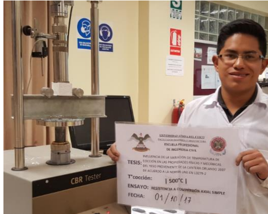
Figura 31. Colocación de la unidad para ensayo a compresión
