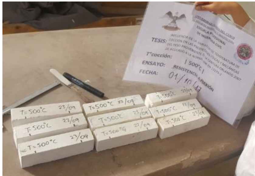
Figura 37. Marcas de referencia para ensayo de flexión
