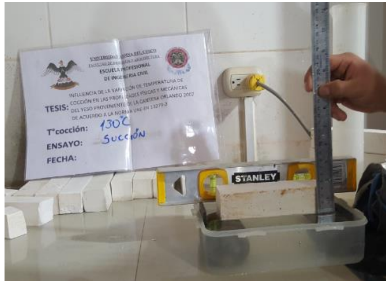
Figura 58. Control de altura de agua durante el ensayo de succión
