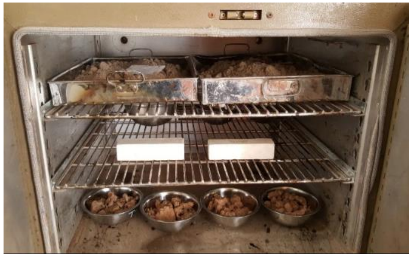
Figura 97. Secado de unidades prismáticas en horno a 40°C
