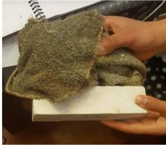
Figura 60. Secado del exceso de agua con una toalla
