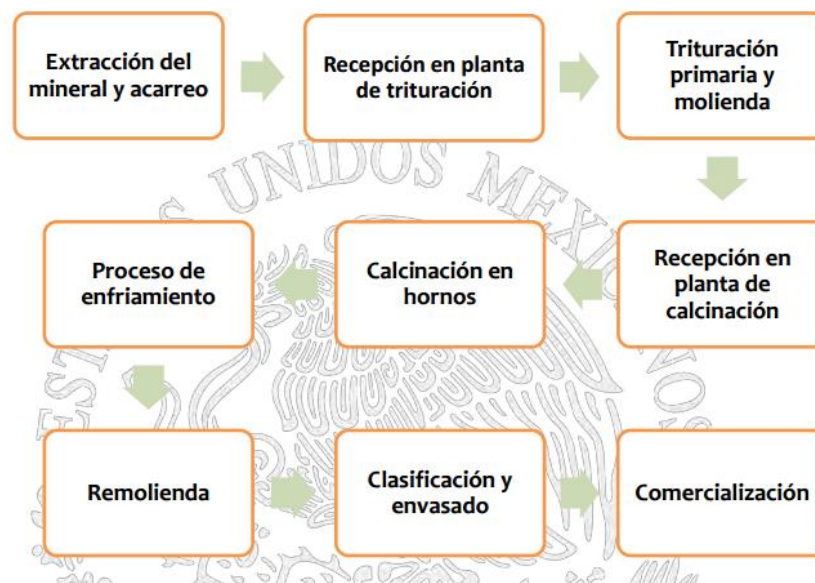
Figura 5. Proceso de fabricación del yeso
