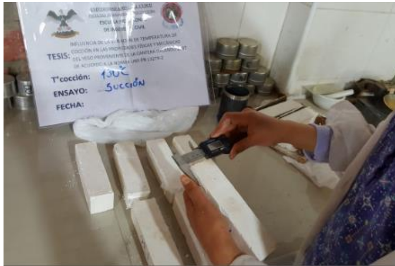
Figura 56. Medición de las dimensiones de la cara del espécimen que entrarán en contacto con el agua
