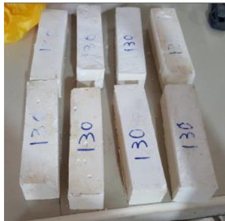
Figura 55. Especímenes de yeso coccionado a 130°C secados en horno
