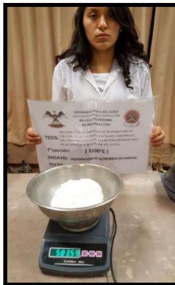
Figura 93. Peso de cantidades de agua y yeso
