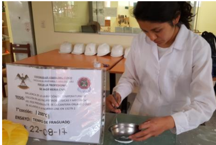
Figura 46. Mezclado de la pasta de yeso
