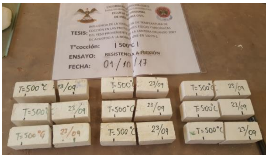
Figura 40. Unidades fabricadas con yeso a 500°C luego del ensayo a flexión
