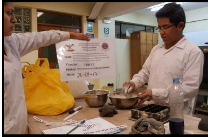
Figura 94. Amasado de la mezcla
