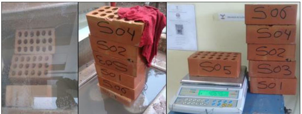
Figura. 97 Muestras saturadas en agua, secado de las muestras y registro de sus pesos.
