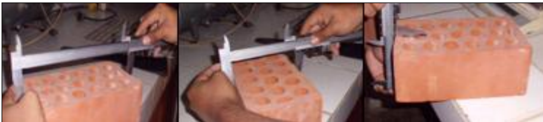
Figura. 93 Registro de la dimensiones (Largo, Ancho y Espesor) del ladrillo King Kong 18 huecos.
