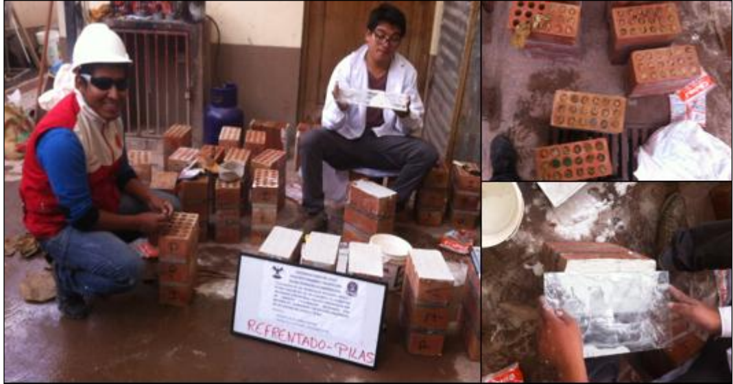
Figura. 113 Proceso de Refrentado - relleno de orificios y acabado del refrentado.
