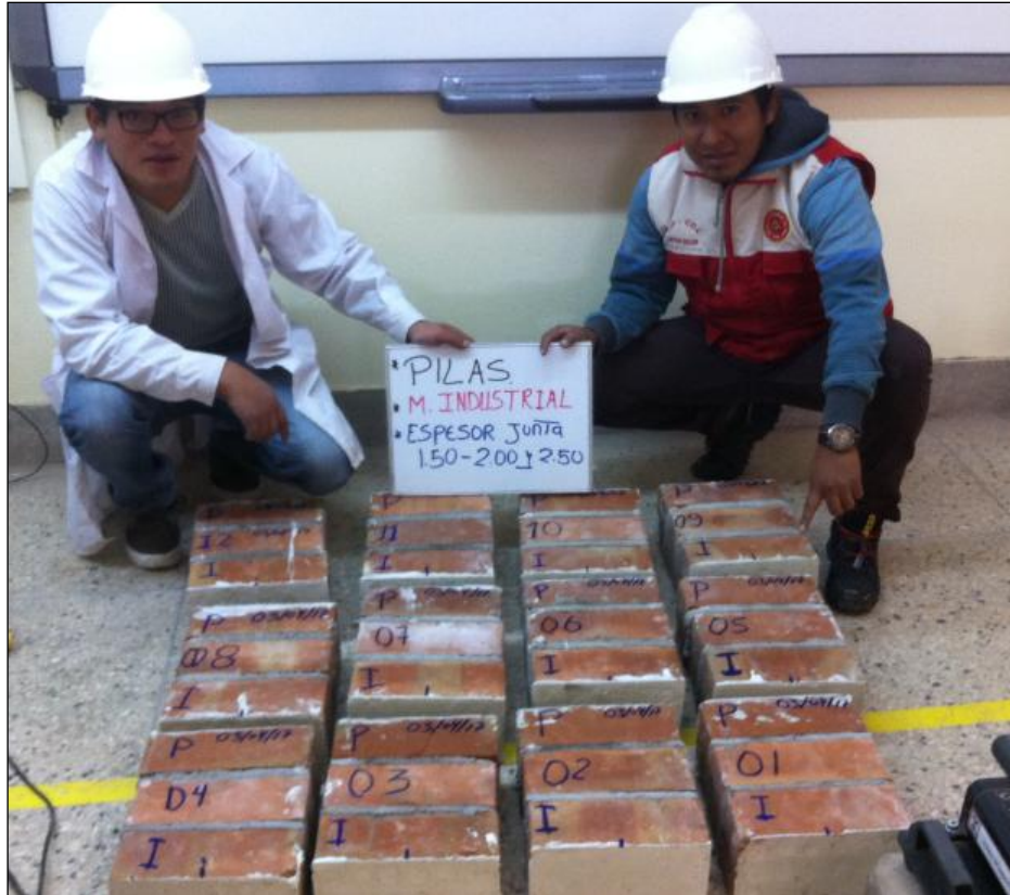
Figura. 116 Pilas debidamente marcadas y refrentadas. Listas para ser ensayadas.
