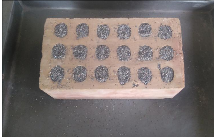
Figura. 91 Saturado los espacios vacíos con arena, ladrillo King Kong 18 huecos
