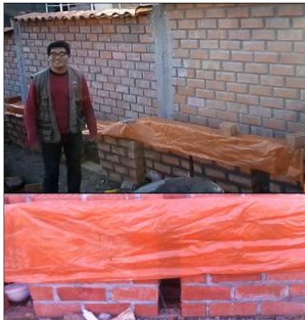
Figura. 127 Modo de reposo de los muretes. Cubierto y en lugar donde no le directamente el sol.
