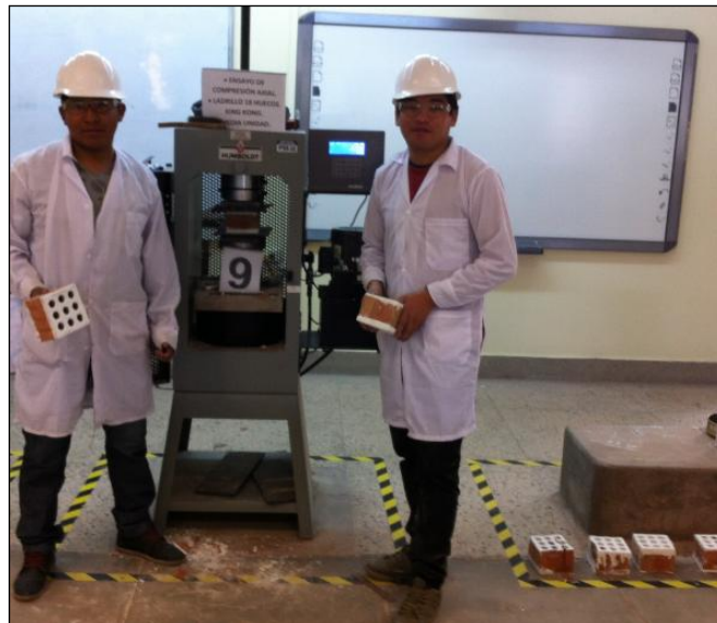
Figura. 102 Ensayo de Compresión a media unidad.
