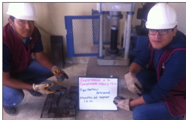
Figura. 85 Resistencia a la compresión de cubos de mortero.
