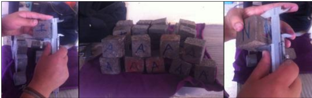
Figura. 84 determinando las dimensiones de los lados; los cubos están saturados con superficie seca.
