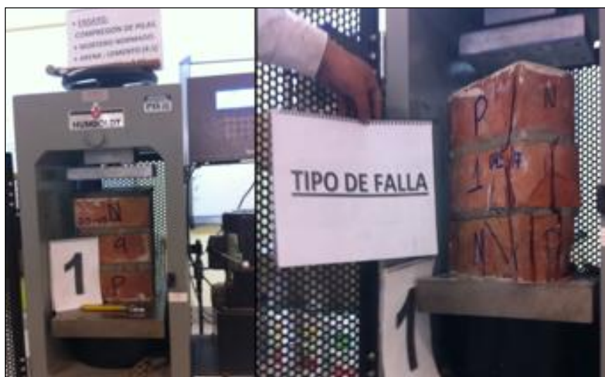
Figura. 117 Registro de la carga a compresión y el tipo de falla de cada pila.
