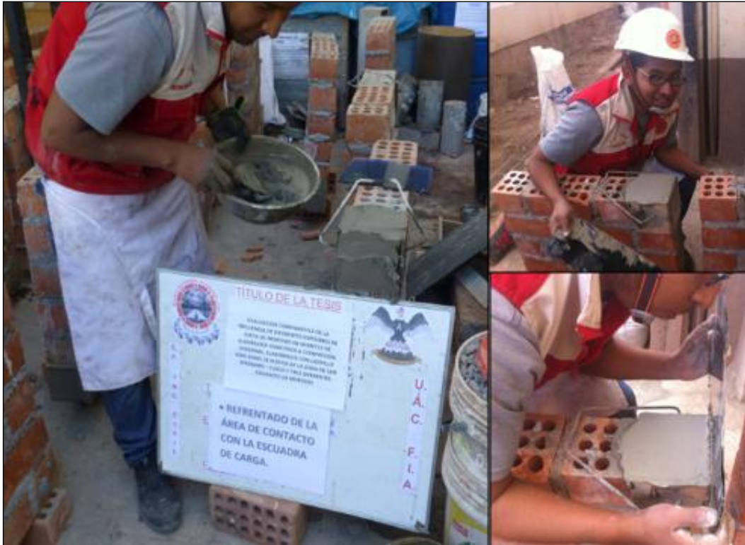
Figura. 130 Refrentado del área en contacto con cemento.
