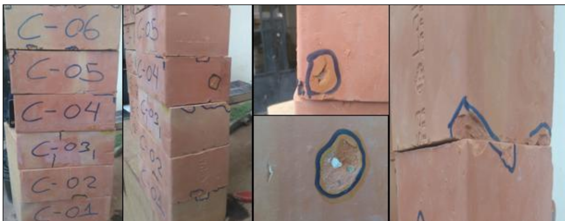
Figura. 88 Presencia de fracturas en los bordes y esquinas del ladrillo y presencia de cuerpos extraños.
