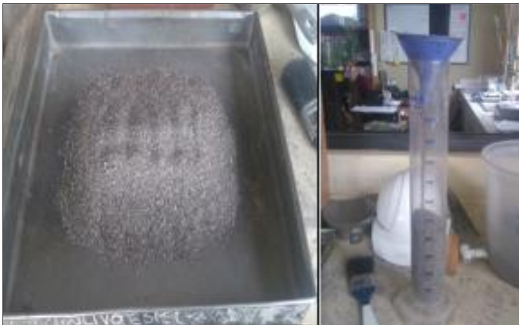
Figura. 92 Saturado los espacios vacíos con arena, ladrillo King Kong 18 huecos
