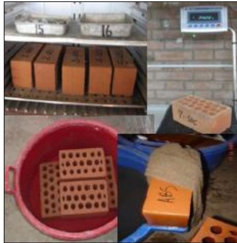
Figura. 30 Ensayo de Absorción de las unidades de albañilería.
