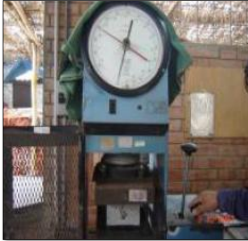
Figura. 25 Resistencia a la compresión.
