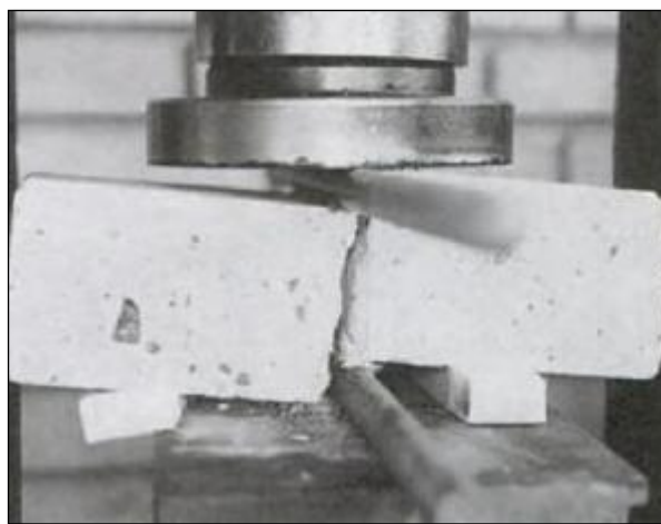
Figura. 24 Esquema de una unidad a tracción.
