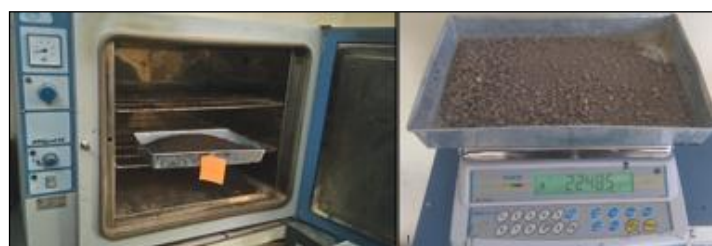
Figura. 70 Secado de la muestra y Registro del Peso
