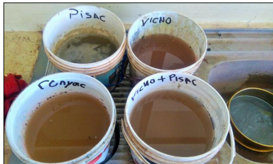
Figura. 59 Lavado de los Agregados Finos.
