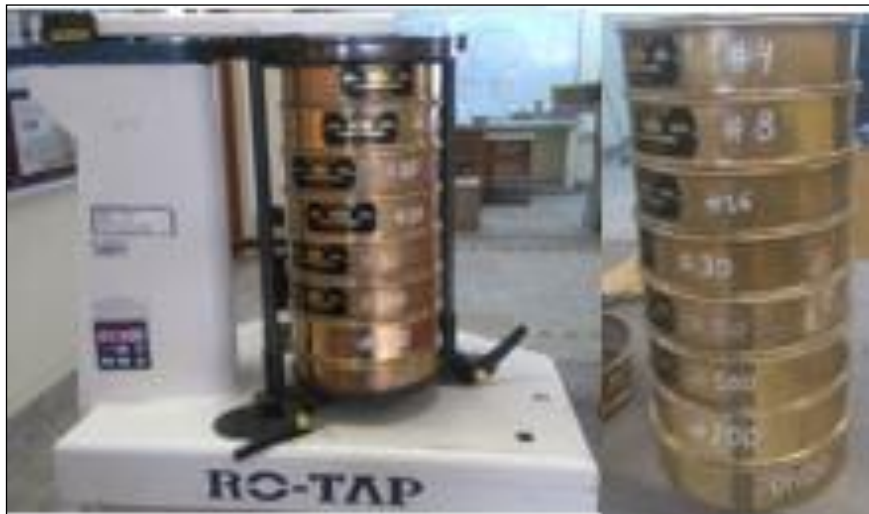
Figura. 61 Tamizado de los Agregados Finos.
