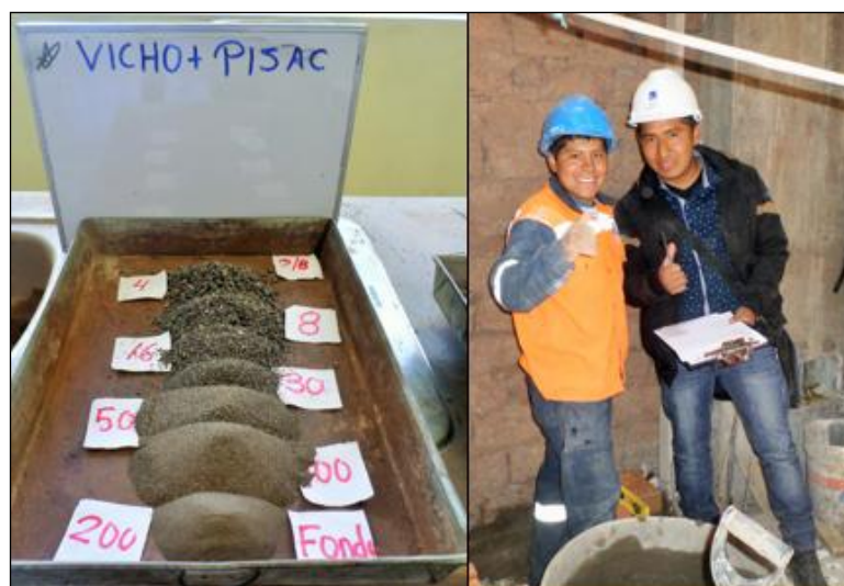
Figura. 63 Granulometría de los Agregados Fino para el Mortero Artesanal y encuesta realiza al operario de una construcción en el Distrito de Santiago.
