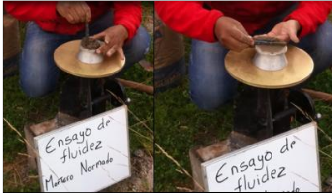
Figura. 74 Mortero en el trono de cono y sobre la mesa de flujo.
