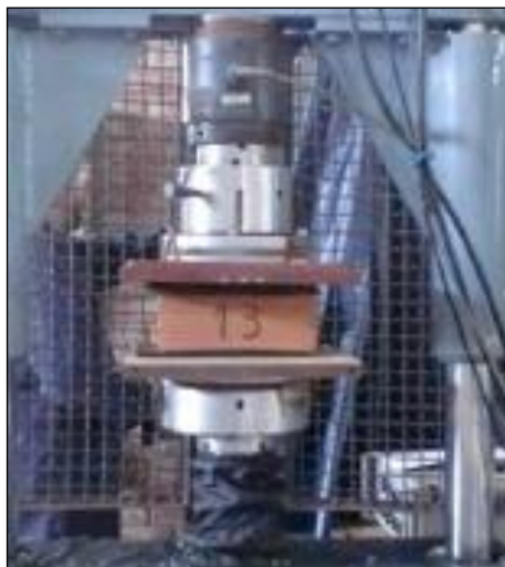
Figura. 26 Resistencia a la compresión.
