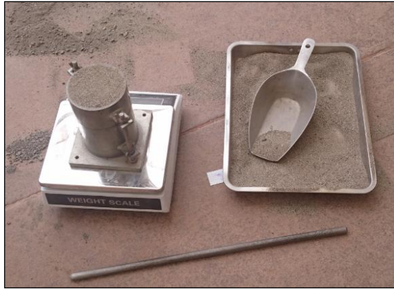
Figura. 68 Registro del Peso Suelto del agregado Fino.
