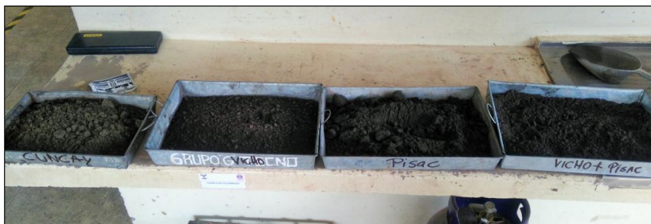
Figura. 72 Muestras secas. Lista para ser pesadas
