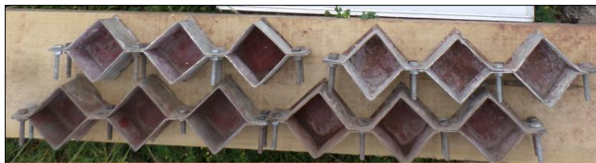
Figura. 56 Moldes Cúbicos para Mortero.
