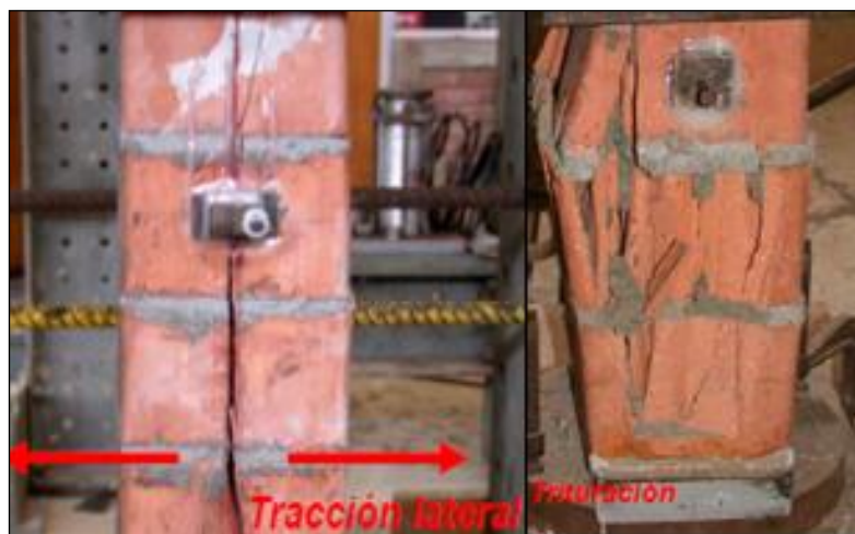
Figura. 39 Formas de falla por Tracción Directa y Por Trituración.
