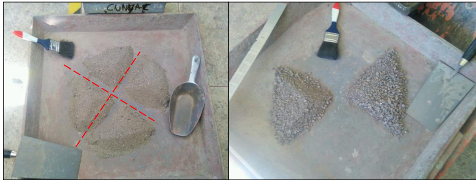
Figura. 58 Proceso de Cuarteo del Agregado Fino para la Elaboración del Mortero.
