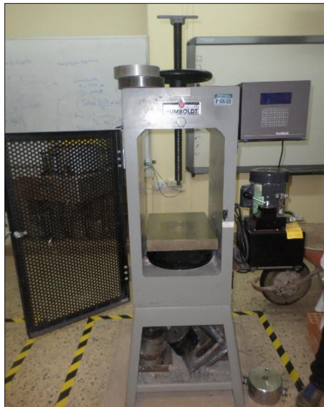
Figura. 50 Máquina para el Ensayo de Compresión.
