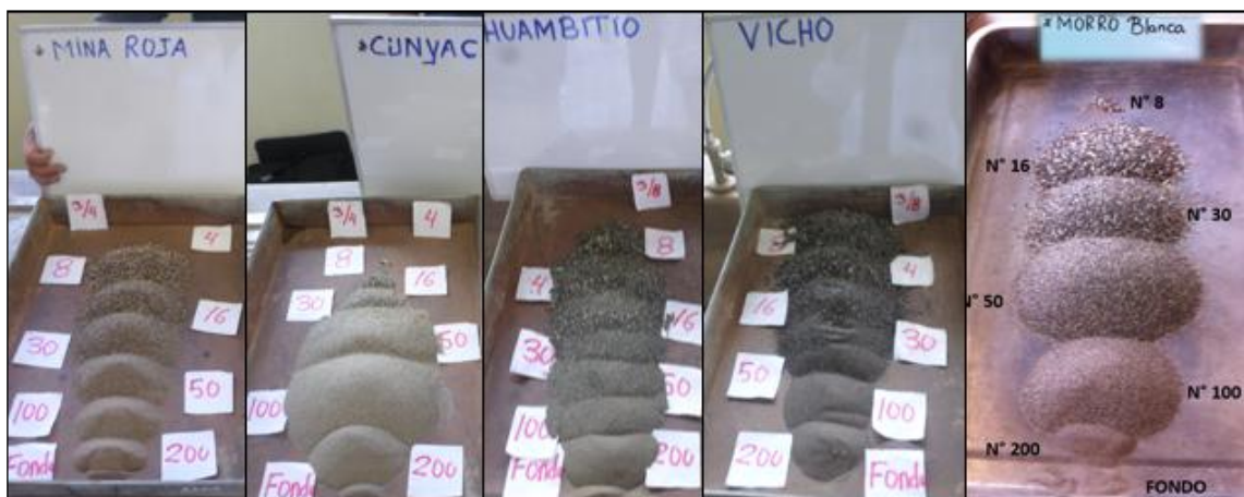
Figura. 64 Granulometría de los Agregados Finos para la elaboración del Mortero Normado.
