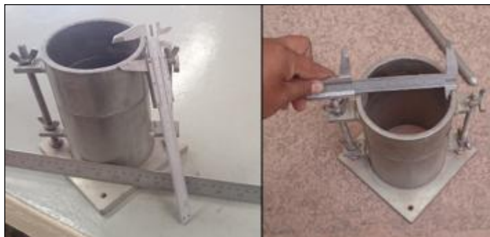
Figura. 67 Determina el Diámetro y la Altura del molde.
