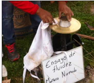
Figura. 75 Limpieza del material excedente y secado de la plataforma.
