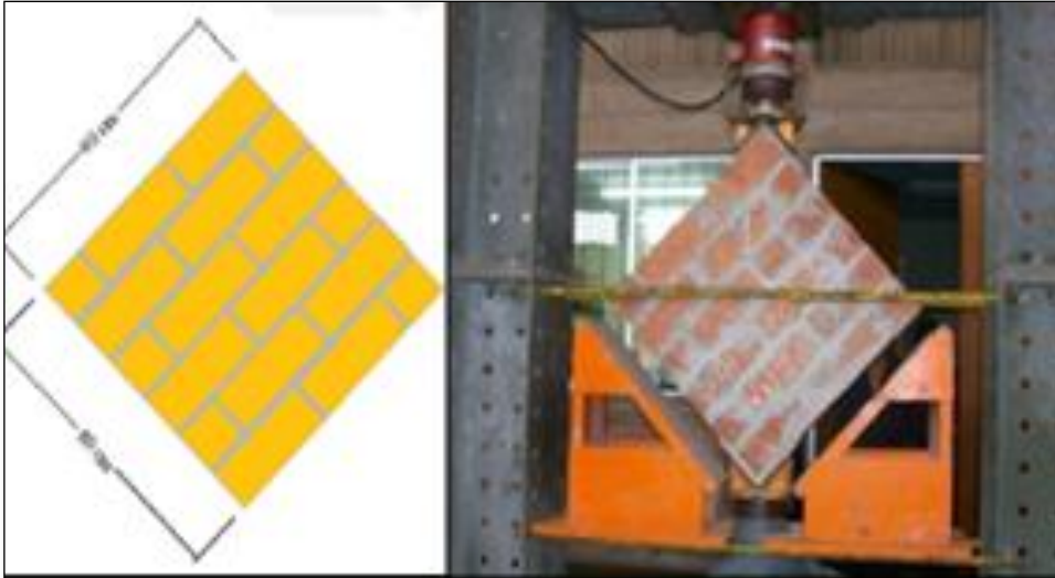
Figura. 46 Dimensiones nominales de un murete (0.60*0.60m).
