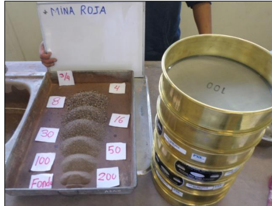
Figura. 62 Granulometría de los Agregados Finos.
