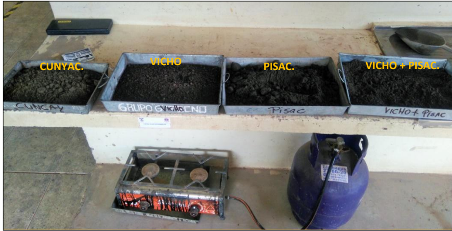
Figura. 60 Secado de los Agregados Finos.
