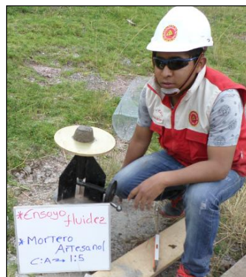
Figura. 76 Forma del Mortero antes de dejar caer la mesa de flujo.
