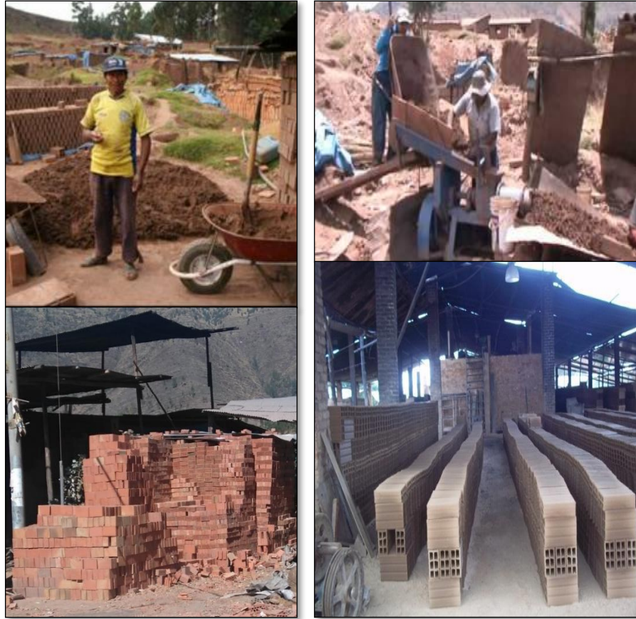
Figura. 1 Producción artesanal y semi mecanizada de ladrillos – San Jerónimo.
