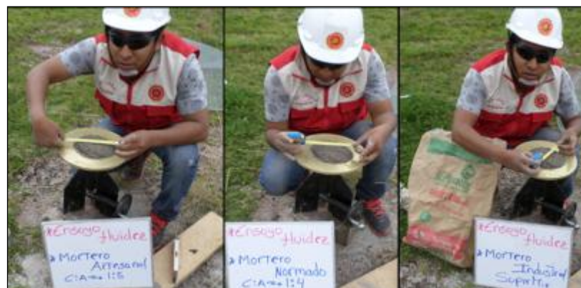
Figura. 78 Medida del diámetro, una vez finalizado el ensayo, Mortero Artesanal, Normado e Industrial.
