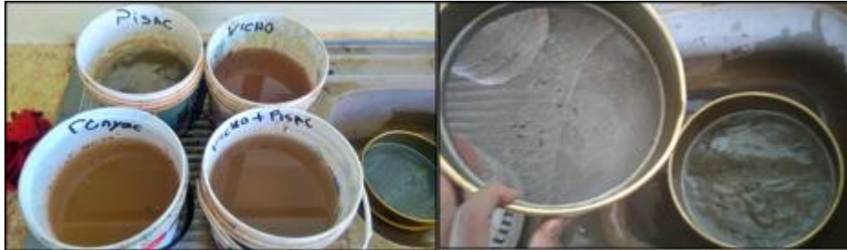
Figura. 71 Proceso de lavado del agregado Fino para la elaboración del Mortero
