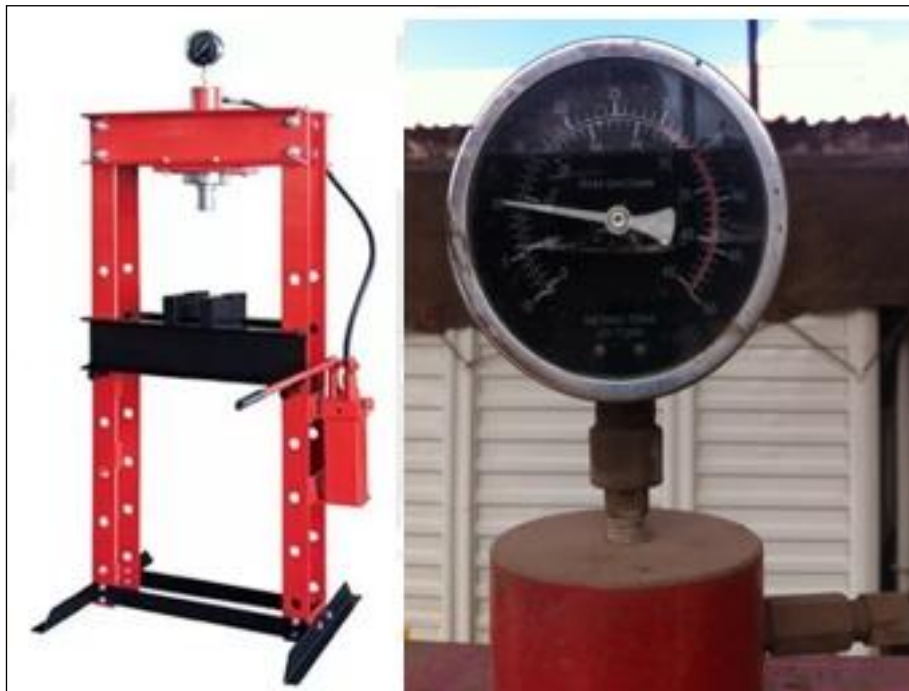
Figura. 51 Prensa Hidráulica – Ruptura para Muretes.
