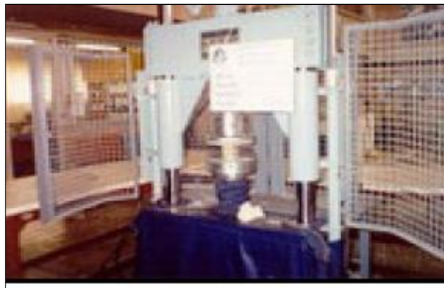
Figura. 31 Maquina para el ensayo a compresión.
