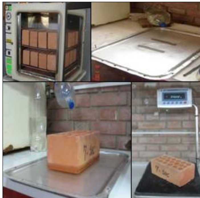
Figura. 29 Ensayo de Succión de las unidades de albañilería.
