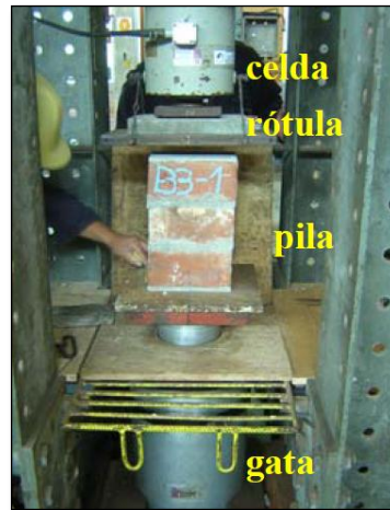
Figura. 34 Ensayo a compresión de pilas.
