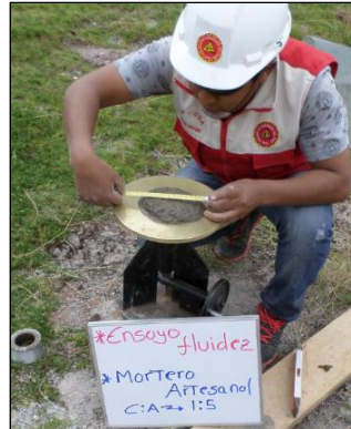
Figura. 77 Medida del diámetro, una vez finalizado el ensayo.
