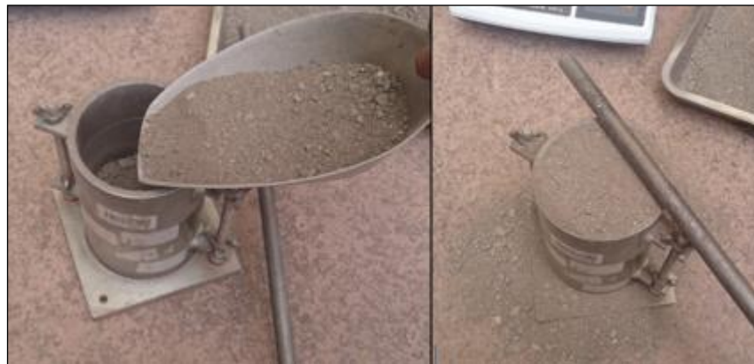
Figura. 69 Registro del Peso Suelto del agregado Fino.
