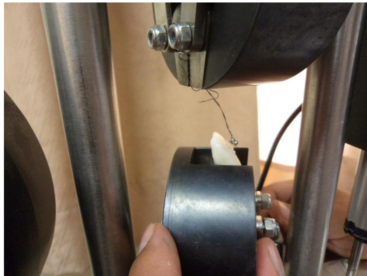
Foto 18: Instantánea de la acción de la fuerza cortante
