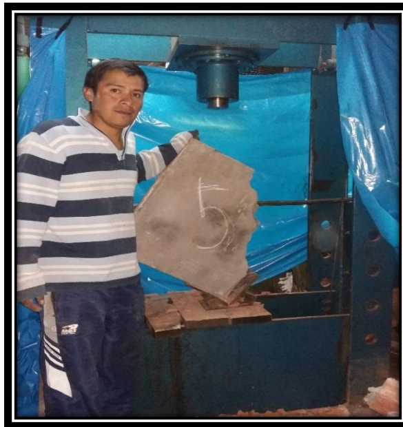
FIGURA N° 119 FALLA POR COMPRESIÓN DIAGONAL EN MURETES DE ALBAÑILERÍA UTILIZANDO BLOCKER CON TARRAJEO.
