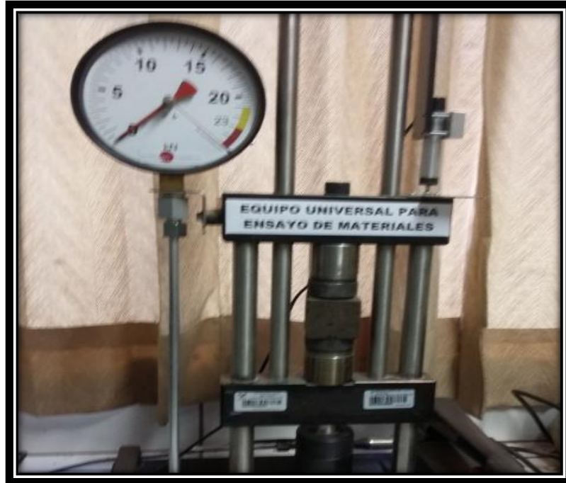
FIGURA N° 128 ENSAYO A COMPRESIÓN DE CUBOS DE MORTERO.
