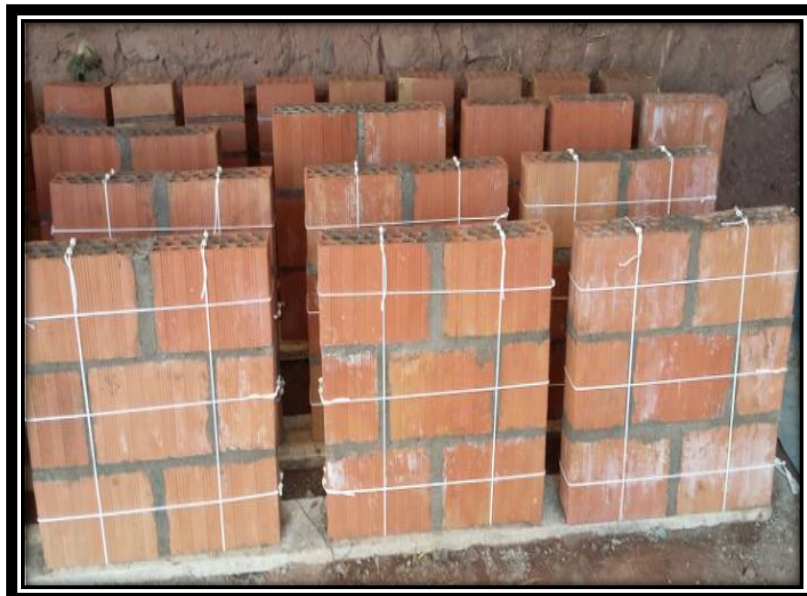
FIGURA N° 121 COLOCACIÓN DE LA SOGA DRIZA EN LOS MURETES DE ALBAÑILERÍA UTILIZANDO BLOCKER.
