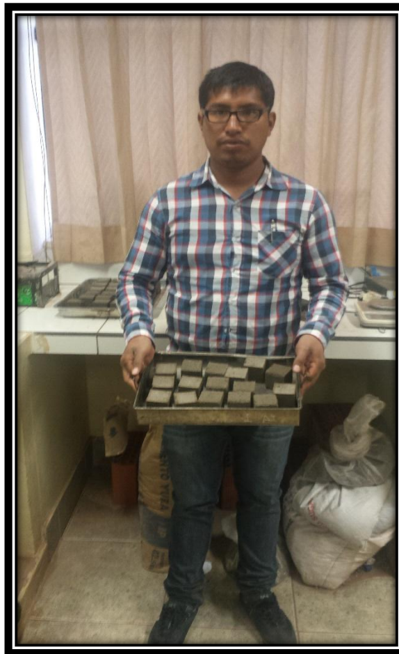
FIGURA N° 127 CUBOS DE MORTERO PARA SER ENSAYADOS DESPUÉS DE SER CURADOS.
