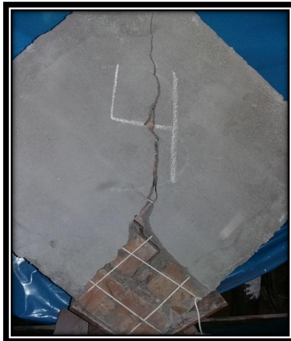
FIGURA N° 109 FALLA POR COMPRESIÓN DIAGONAL EN MURETES DE ALBAÑILERÍA CON LADRILLO KING KONG 18 HUECOS CON TARRAJEO Y REFORZADO CON SOGA DRIZA.
