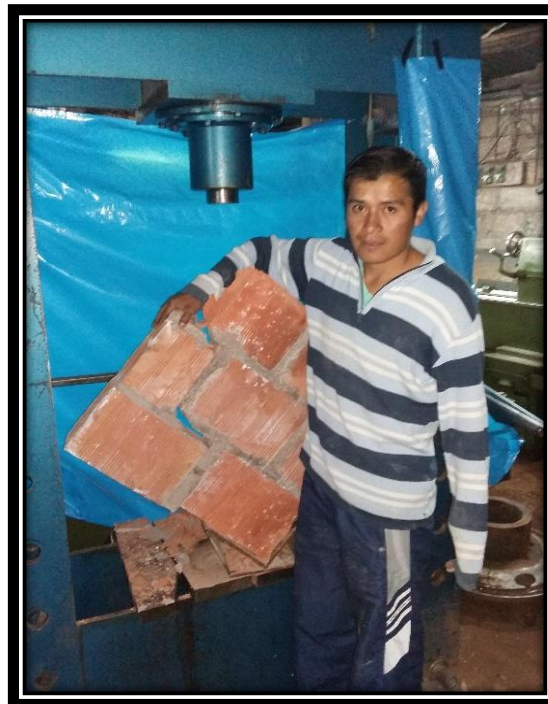
FIGURA N° 114 FALLA POR COMPRESIÓN DIAGONAL EN MURETES DE ALBAÑILERÍA UTILIZANDO BLOCKER.
