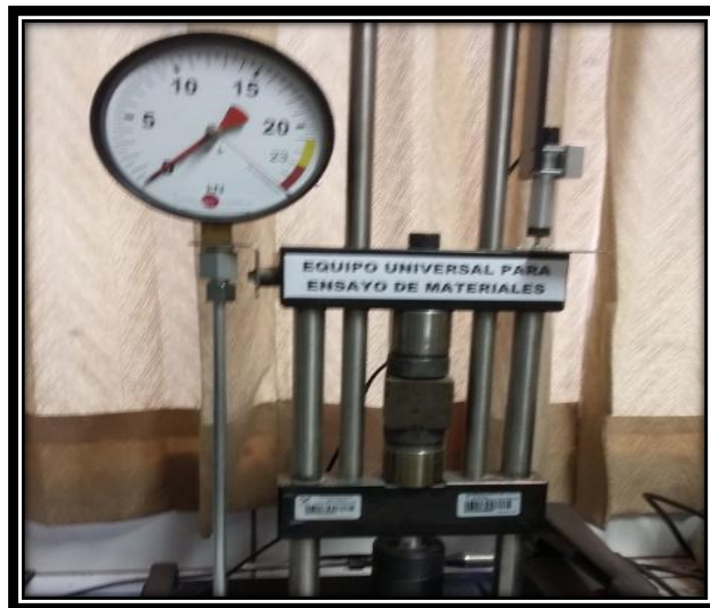
FIGURA N° 129 LECTURA DE LA FUERZA EJERCIDA EN LA ROTURA DEL CUBO DE MORTERO
