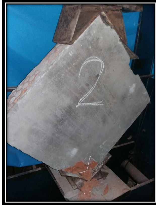
FIGURA N° 124 FALLA POR COMPRESIÓN DIAGONAL EN MURETES DE ALBAÑILERÍA UTILIZANDO BLOCKER REFORZADO CON SOGA DRIZA.
