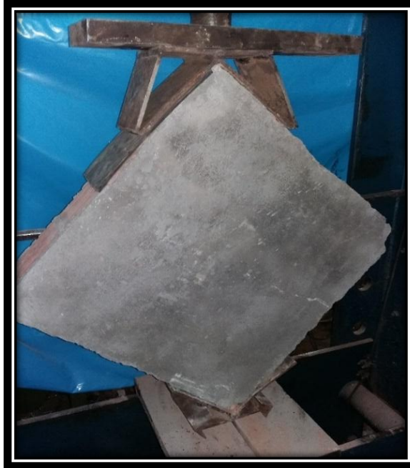
FIGURA N° 118 ENSAYO A COMPRESIÓN DIAGONAL EN MURETES DE ALBAÑILERÍA UTILIZANDO BLOCKER CON TARRAJEO.
