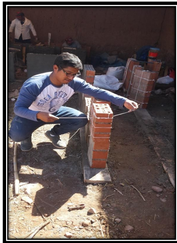
FIGURA N° 106 MURETES DE ALBAÑILERÍA UTILIZANDO LADRILLO KING KONG 18 HUECOS REFORZADO CON SOGA DRIZA.
