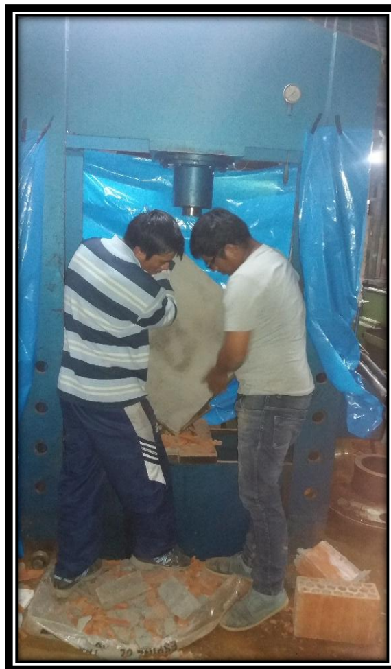
FIGURA N° 123 ENSAYOS A COMPRESIÓN DIAGONAL EN MURETES DE ALBAÑILERÍA UTILIZANDO BLOCKER REFORZADO CON SOGA DRIZA.
