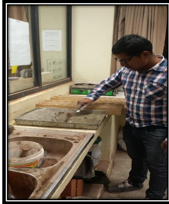
FIGURA N° 125 MEZCLADO DE ARENA Y CEMENTO EN LA BANDEJA IMPERMEABLE.
