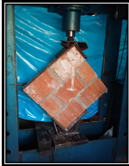
FIGURA N° 113 ENSAYO A COMPRESIÓN DIAGONAL EN MURETES DE ALBAÑILERÍA UTILIZANDO BLOCKER.
