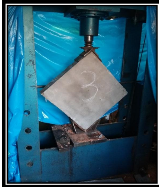
FIGURA N° 108 ENSAYOS A COMPRESIÓN DIAGONAL EN MURETES DE ALBAÑILERÍA CON LADRILLO KING KONG 18 HUECOS CON TARRAJEO Y REFUERZO CON SOGA DRIZA.
