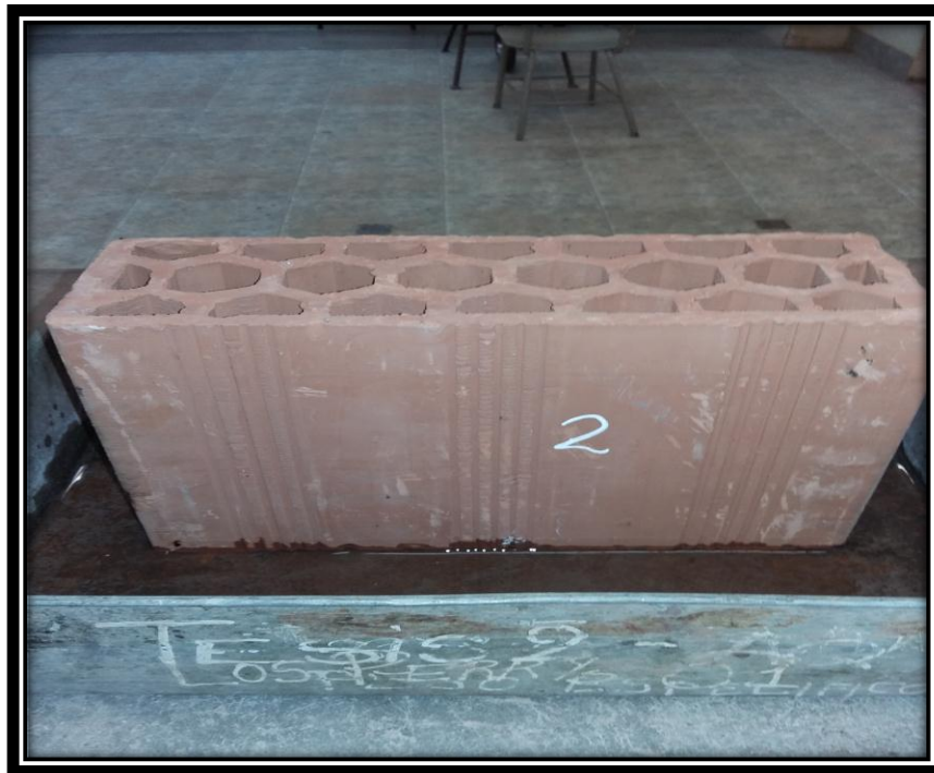
FIGURA N° 64 BLOCKER SUMERGIDO EN UNA ALTURA DE 3MM DE PELÍCULA DE AGUA.
