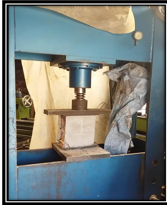
FIGURA N° 80 ENSAYO A COMPRESIÓN EN PILAS DE ALBAÑILERÍA UTILIZANDO LADRILLO KING KONG 18 HUECOS CON TARRAJEO REFORZADO CON SOGA DRIZA.
