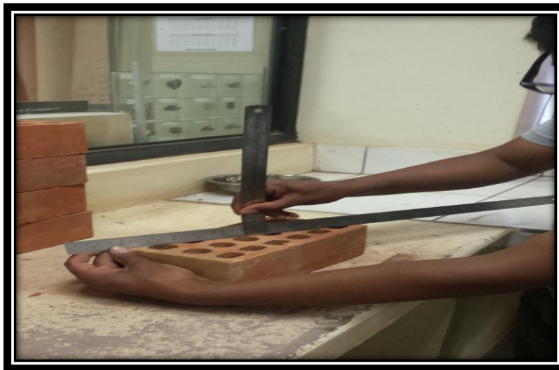
FIGURA N° 58 MEDICIÓN DEL ALABEO EN EL LADRILLO KING KONG DE 18 HUECOS.
