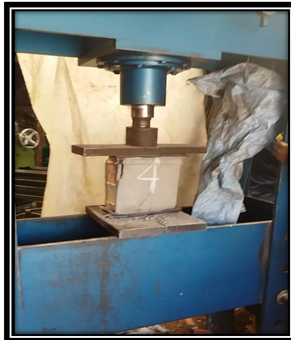
FIGURA N° 81 FALLA POR COMPRESIÓN AXIAL EN PILAS DE ALBAÑILERÍA UTILIZANDO LADRILLO KING KONG 18 HUECOS CON TARRAJEO REFORZADO CON SOGA DRIZA.
