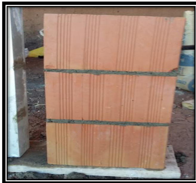
FIGURA N° 83 ASENTADO DE PILAS DE ALBAÑILERÍA CON LADRILLO BLOCKER.
