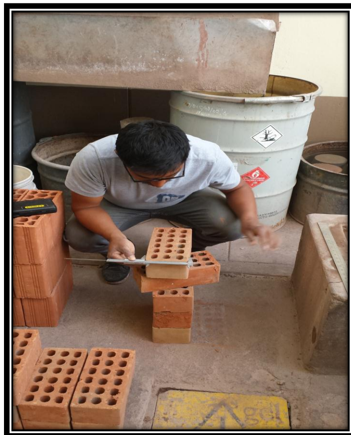
FIGURA N° 54 MEDICIÓN DEL ANCHO DEL LADRILLO KING KONG DE 18 HUECOS.
