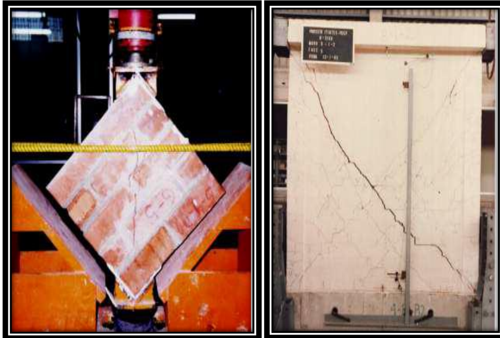
FIGURA N° 41 FALLA POR TRACCIÓN DIAGONAL EN MURETE Y EN MURO.
