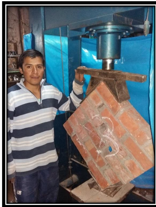
FIGURA N° 99 FALLA POR COMPRESIÓN DIAGONAL DE LOS MURETES DE ALBAÑILERÍA UTILIZANDO KING KONG 18 HUECOS.
