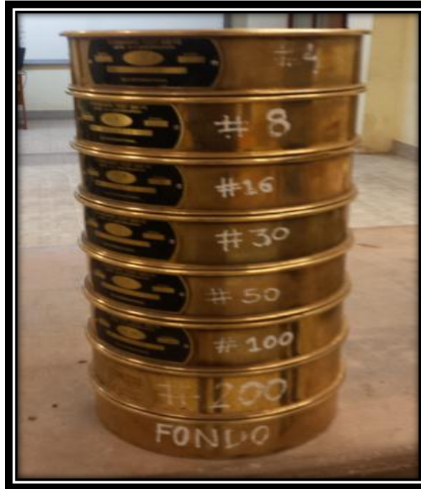
FIGURA N° 51 SERIE DE TAMICES ADECUADO PARA LA GRANULOMETRÍA.
