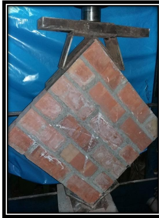
FIGURA N° 98 ENSAYOS A COMPRESIÓN DIAGONAL DE LOS MURETES DE ALBAÑILERÍA UTILIZANDO KING KONG 18 HUECOS.
