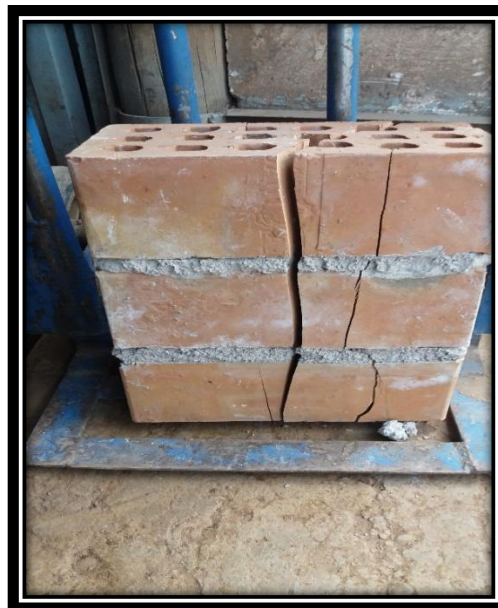
FIGURA N° 73 FALLA A COMPRESIÓN DE PILA DE ALBAÑILERÍA UTILIZANDO LADRILLOS KING KONG DE 18
