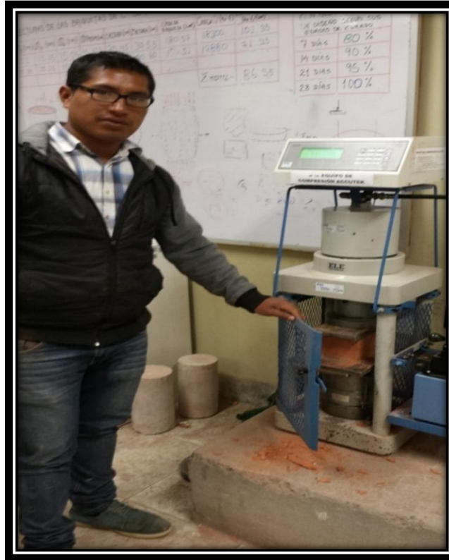
FIGURA N° 66 ENSAYO DE COMPRESIÓN EN LADRILLOS KING KONG DE 18 HUECOS.
