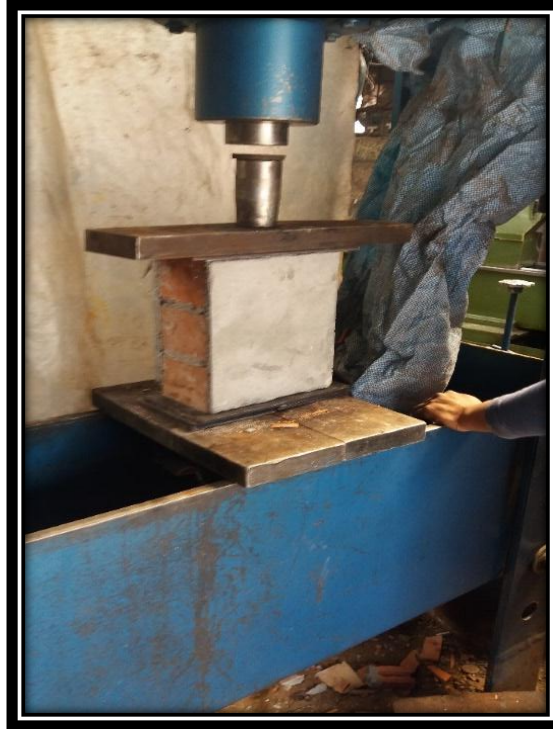
FIGURA N° 76 ENSAYO DE COMPRESIÓN AXIAL DE PILAS DE ALBAÑILERÍA UTILIZANDO LADRILLOS KING KONG 18 HUECOS CON TARRAJEO.
