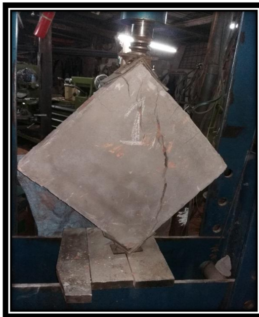
FIGURA N° 104 FALLA POR COMPRESIÓN DIAGONAL EN MURETES DE ALBAÑILERÍA CON LADRILLO KING KONG 18 HUECOS CON TARRAJEO.
