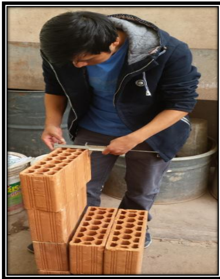
FIGURA N° 56 MEDICIÓN DEL ANCHO EN EL BLOCKER.
