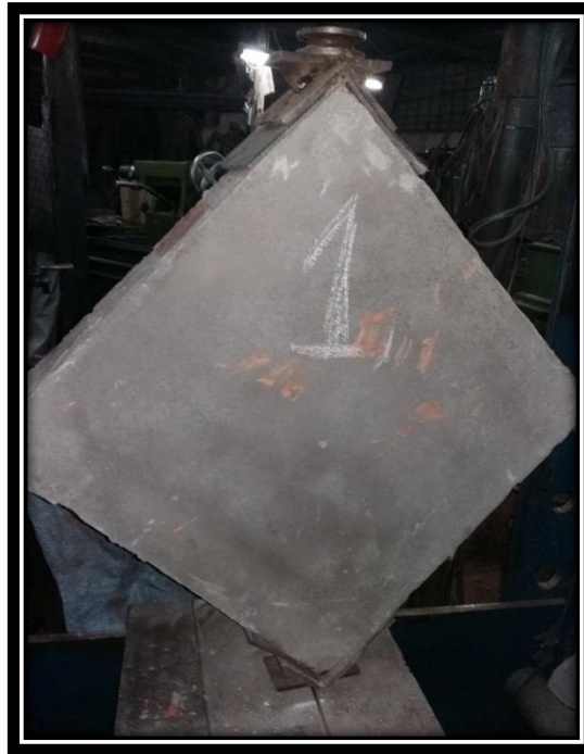
FIGURA N° 103 ENSAYOS A COMPRESIÓN DIAGONAL EN MURETES DE ALBAÑILERÍA CON LADRILLO KING KONG 18 HUECOS CON TARRAJEO.
