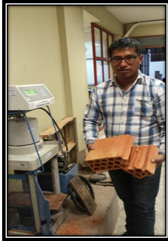
FIGURA N° 69 FALLA POR COMPRESIÓN DEL LADRILLO BLOCKER.
