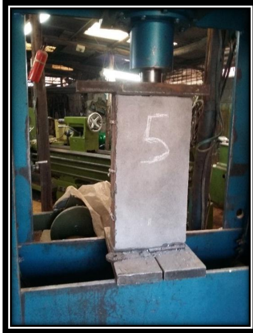
FIGURA N° 92 ENSAYO A COMPRESIÓN AXIAL DE PILAS DE ALBAÑILERÍA UTILIZANDO BLOCKER CON TARRAJEO REFORZADOS CON SOGA DRIZA.
