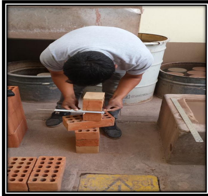
FIGURA N° 55 MEDICIÓN DE LA ALTURA DEL LADRILLO KING KONG DE 18 HUECOS.
