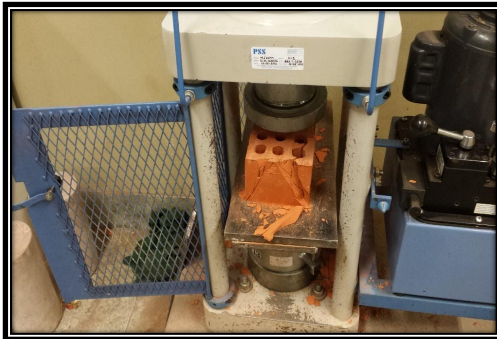
FIGURA N° 67 FALLA POR COMPRESIÓN DE LOS LADRILLOS KING KONG DE 18 HUECOS.
