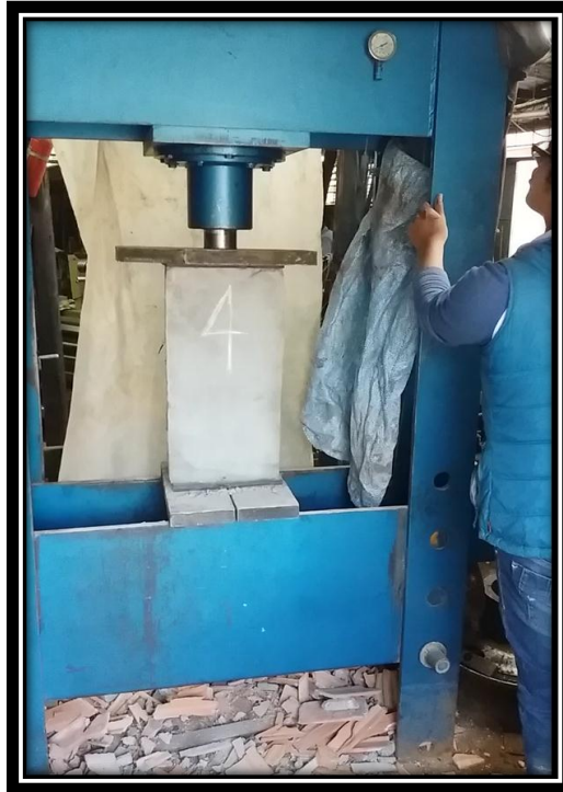
FIGURA N° 88 ENSAYO A COMPRESIÓN AXIAL DE PILAS DE ALBAÑILERÍA UTILIZANDO BLOCKER CON TARRAJEO.
