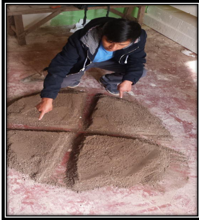
FIGURA N° 49 CUARTEO DE ARENA GRUESA.
