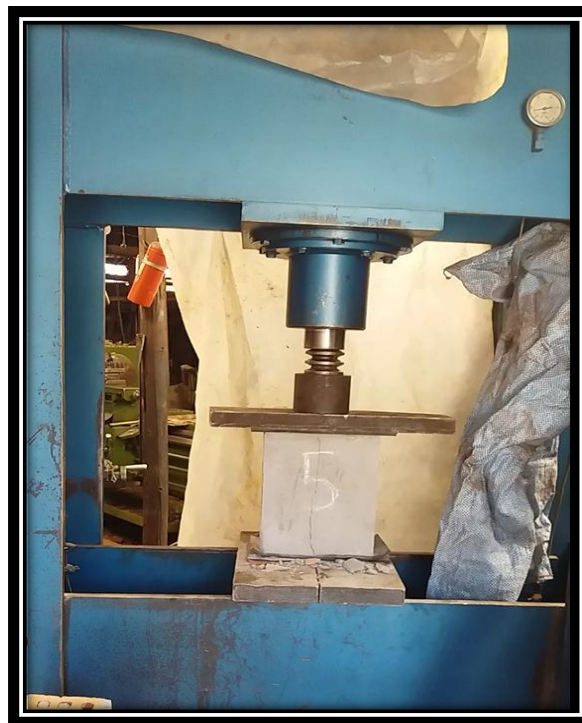
FIGURA N° 77 FALLA POR COMPRESIÓN AXIAL DE PILAS DE ALBAÑILERÍA UTILIZANDO LADRILLOS KING KONG DE 18 HUECOS CON TARRAJEO.
