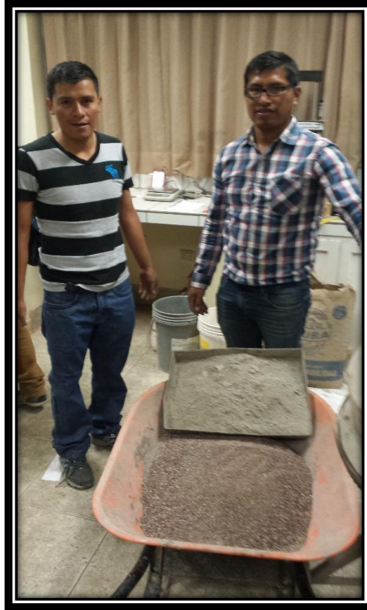
FIGURA N° 82 DOSIFICACIÓN CEMENTO ARENA 1:4
