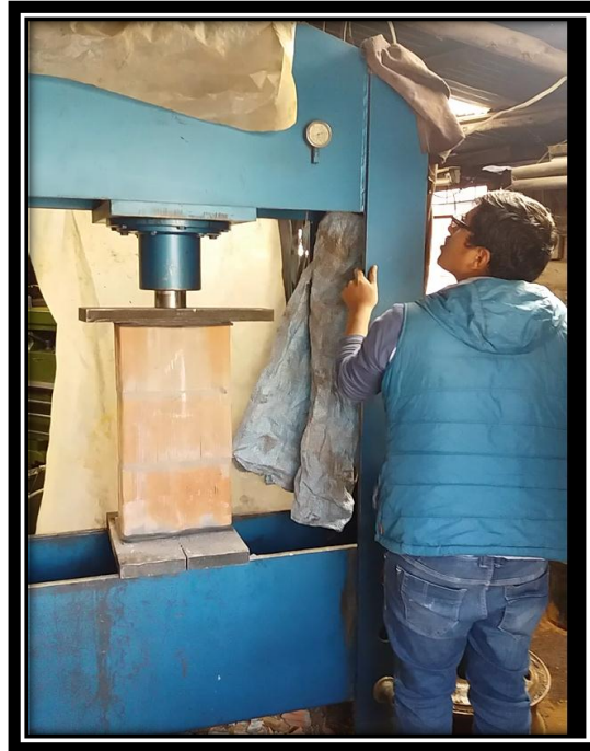
FIGURA N° 84 ENSAYO A COMPRESIÓN AXIAL DE PILAS DE ALBAÑILERÍA CON BLOCKER.
