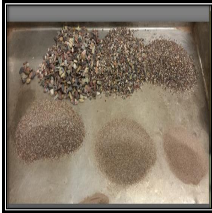
FIGURA N° 53 OBTENCIÓN DE LA GRANULOMETRÍA DE LA ARENA GRUESA.
