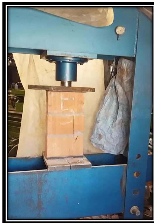
FIGURA N° 85 FALLA POR COMPRESIÓN AXIAL DE PILAS DE ALBAÑILERÍA CON BLOCKER.
