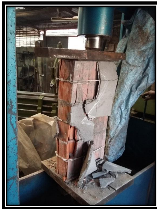
FIGURA N° 93 FALLA A COMPRESIÓN AXIAL DE PILAS DE ALBAÑILERÍA UTILIZANDO BLOCKER CON TARRAJEO Y REFUERZO DE SOGA DRIZA.
