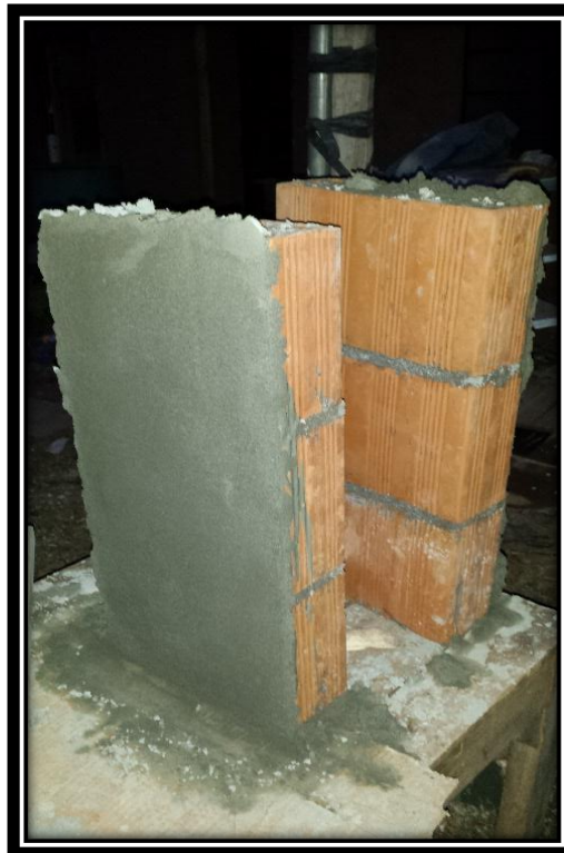
FIGURA N° 87 TARRAJEO DE PILAS DE ALBAÑILERÍA CON BLOCKER.
