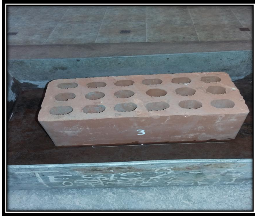
FIGURA N° 62 LADRILLO KING KONG DE 18 HUECOS SUMERGIDO EN UNA ALTURA DE 3MM DE PELÍCULA DE AGUA
