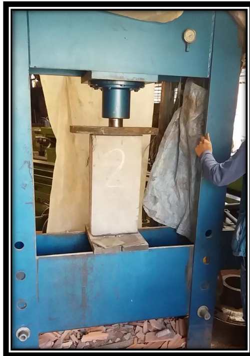
FIGURA N° 89 FALLA POR COMPRESIÓN AXIAL DE PILAS DE ALBAÑILERÍA UTILIZANDO BLOCKER CON TARRAJEO.
