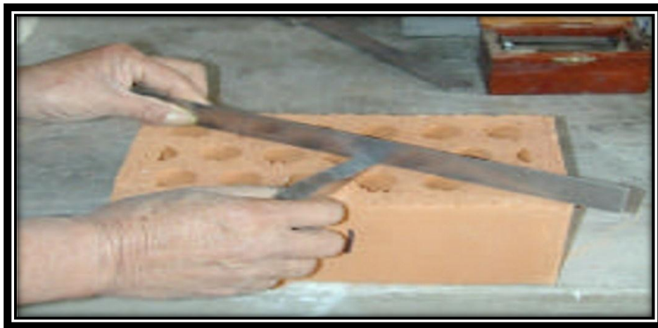
FIGURA N° 16 DESCRIPCIÓN DE LA PRUEBA DE ALABEO
