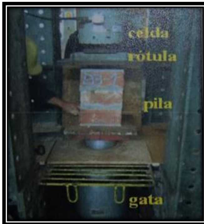
FIGURA N° 35 EQUIPOS DE ENSAYO DE COMPRESIÓN AXIAL
