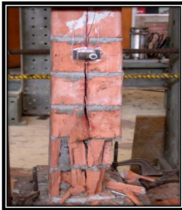
FIGURA N° 36 FALLA IDEAL DE UNA PILA.
