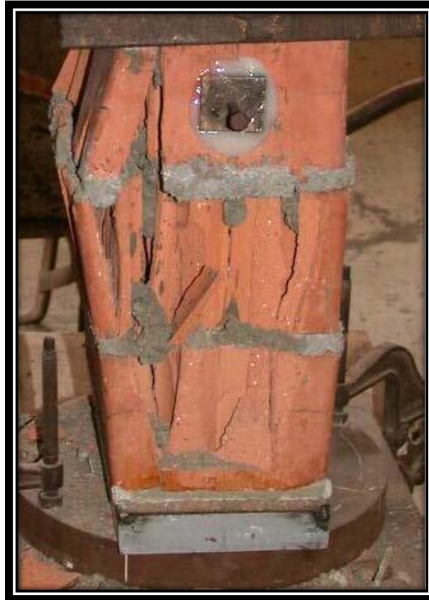
FIGURA N° 37 TRITURACIÓN DE LADRILLOS HUECOS.
