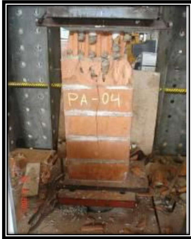
FIGURA N° 38 TRITURACIÓN DE BLOCKER FALLA FRÁGIL.
