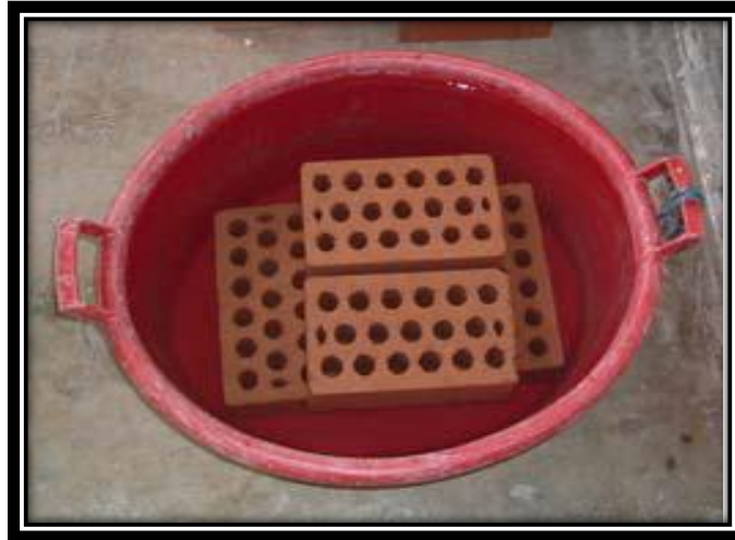
FIGURA N° 22 DESCRIPCIÓN: PRUEBA DE ABSORCIÓN.
