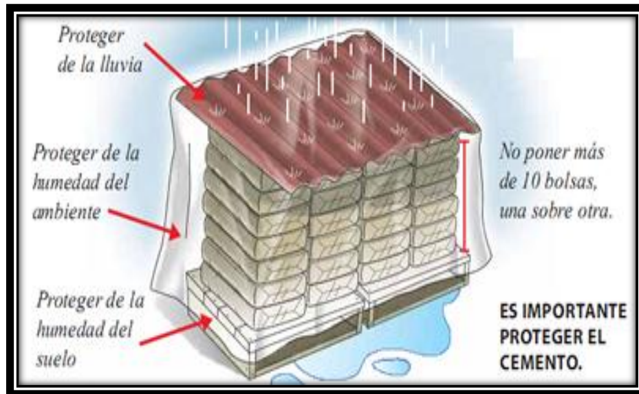
FIGURA N° 28 ALMACENAMIENTO DEL CEMENTO
