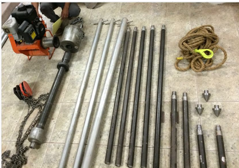
Figura 95. Equipo completo de SPT
