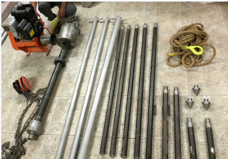
Figura 75. Equipo completo de SPT
