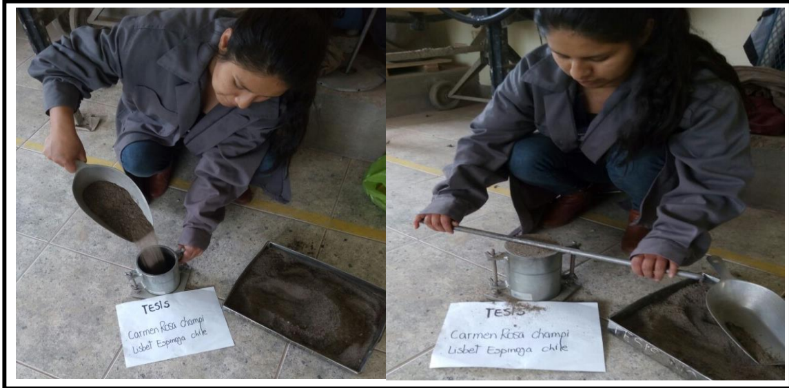
FIGURA N° 46: Colocado y Enrasado del Material suelto
