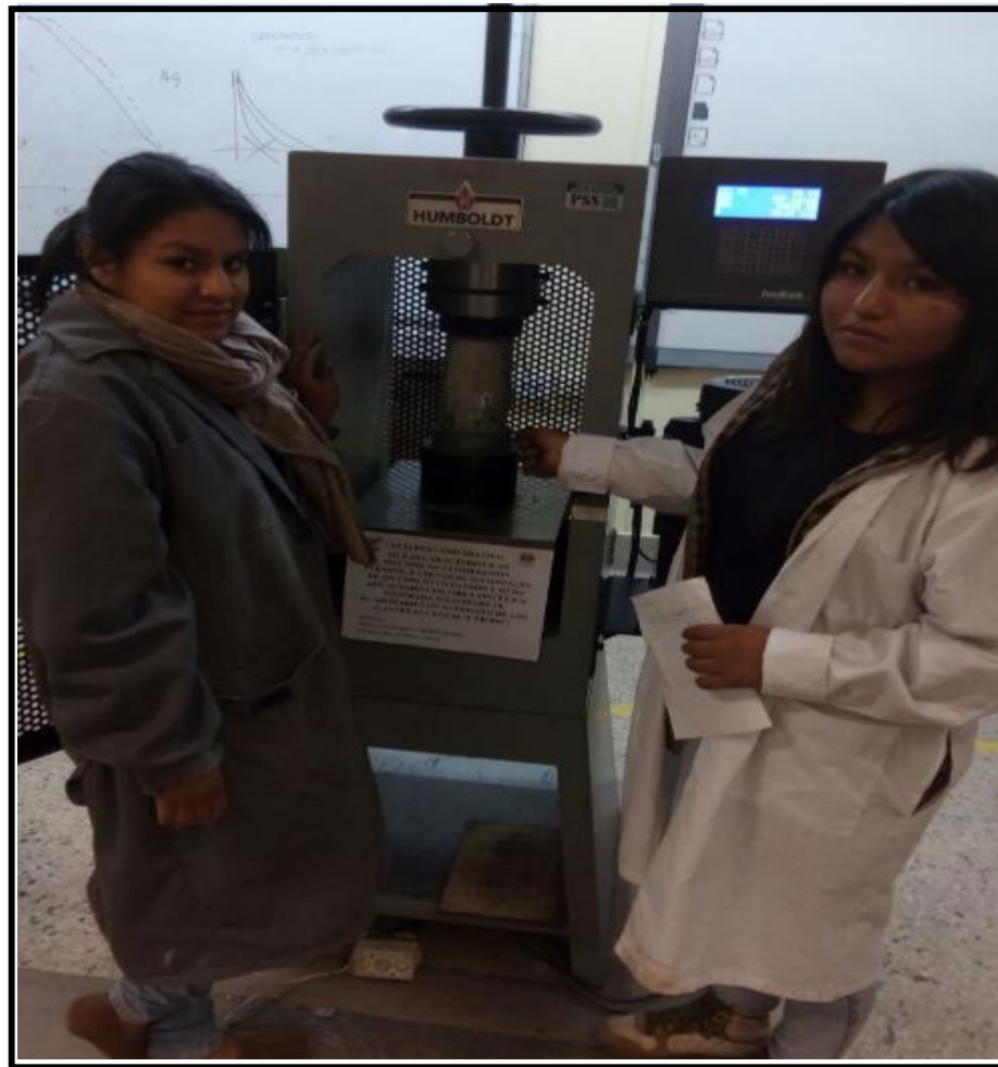
FIGURA N° 58: Colocado de la Muestra en la Maquina Compresora.
