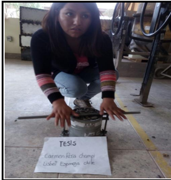
FIGURA N° 44: Enrasado De Molde.
