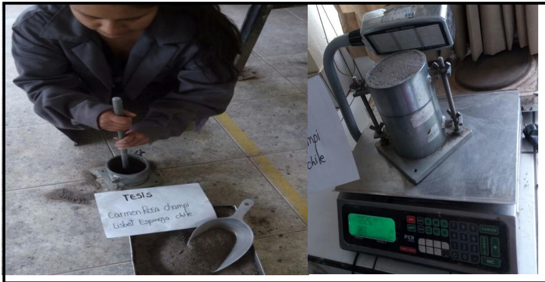
FIGURA N° 48: Compactado y Pesado del Material Suelto en el Molde
