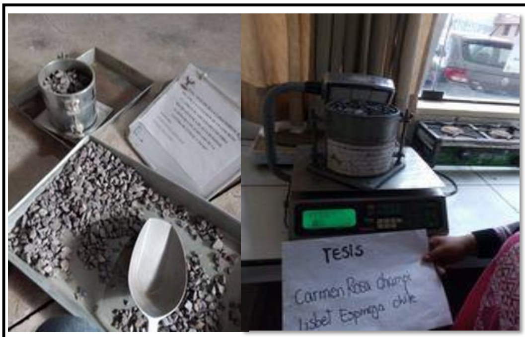
FIGURA N° 42: Peso del Material Suelto.
