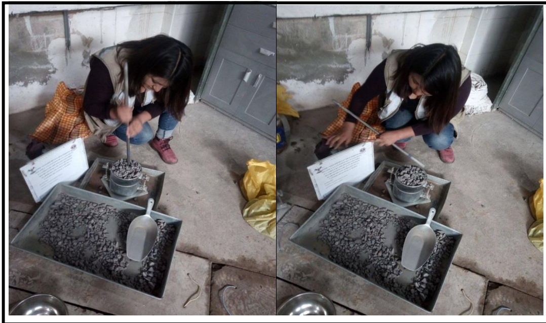
FIGURA N° 43: Enrasado del Material Compactado.
