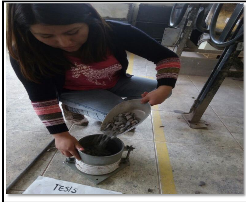
FIGURA N° 41: Caída del Agregado
