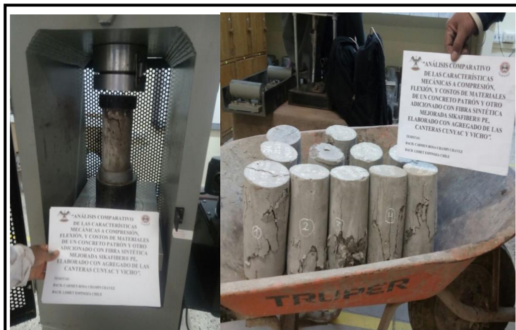
FIGURA N° 59: Rotura de Briqueta.
