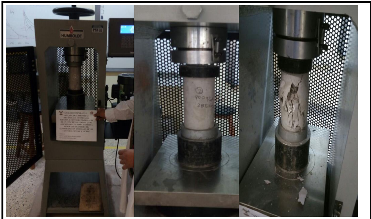
FIGURA N° 19: Ensayo De Resistencia A La Compresión.
