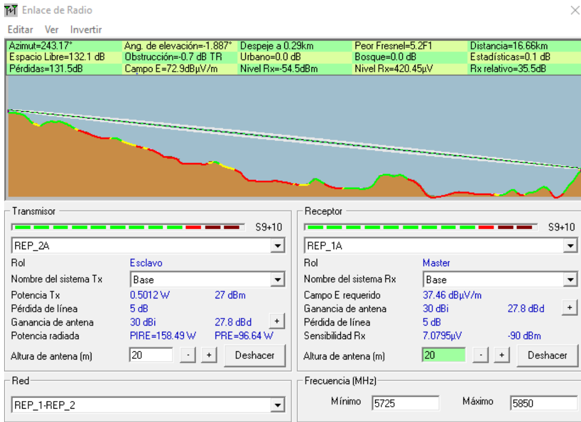
Figura IV-25 Simulación de radioenlace: primer repetidor – segundo repetidor en Radio Mobile. Fuente: Radio Mobile
