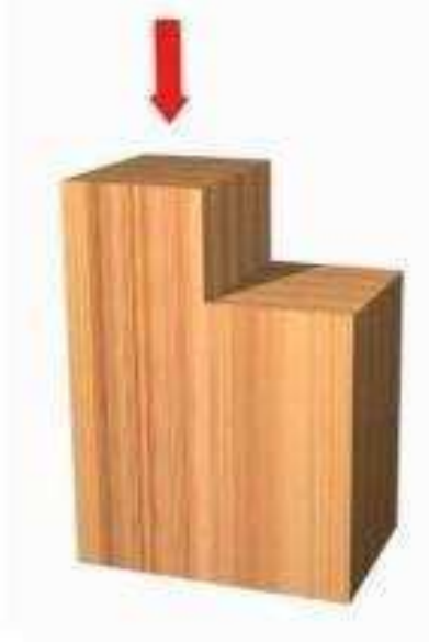
Figura N° 17: Esquema de ensayo de resistencia al cizalle paralelo a las fibras
