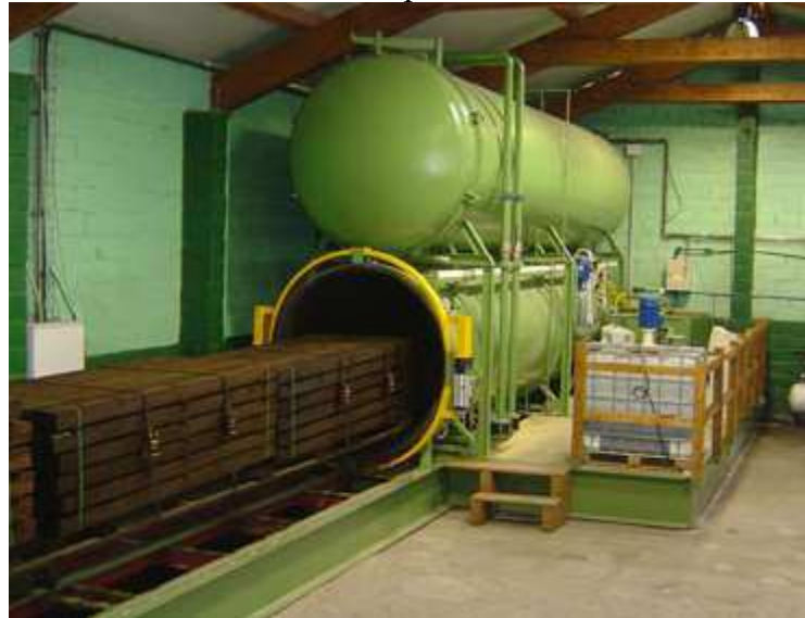
Figura N° 32: Cilindro autoclave para tratamiento de madera
