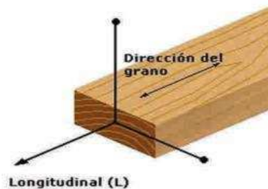
Figura N° 9: Eje longitudinal en una pieza de madera
