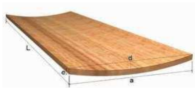
Figura N° 23: Acanaladura, alabeo de las caras en la dirección
