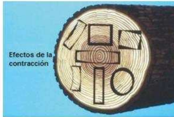
Figura N° 12: Efectos de la contracción en la madera.
