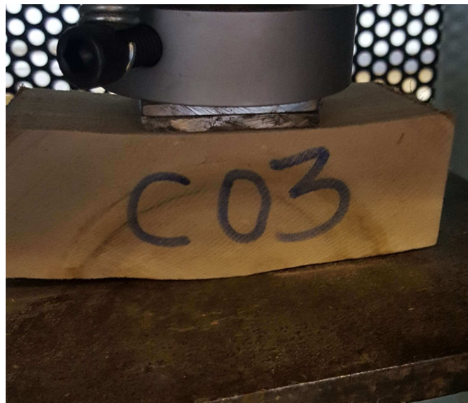
Figura N° 68: Probeta sometida al ensayo de compresión perpendicular
