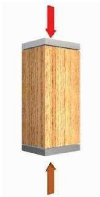
Figura N° 15: Esquema de ensayo de compresión paralela al grano
