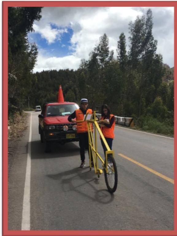
Figura N° 89: Recolección de datos para el IRI. (Fuente propia)
