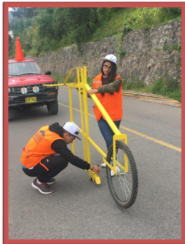
Figura N° 86: Calibración de la pastilla del Rugosímetro de Merlín. (Fuente propia)
