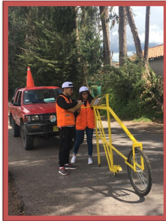
Figura N° 90: Llenado del formato de recolección de datos para el IRI. (Fuente propia)
